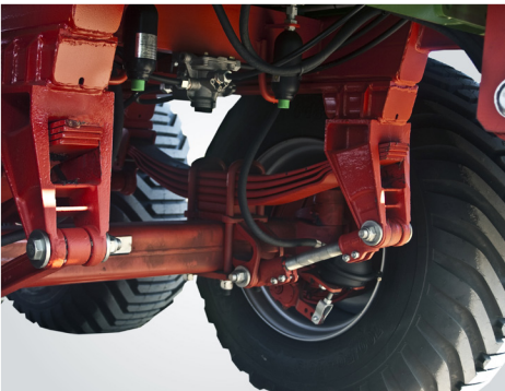
Suspension parabolique en standard. Suspension hydraulique disponible en option.
