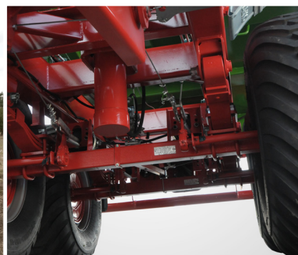
Le châssis fort et solide avec une suspension parabolique, facilite le transport sur les terrains difficiles
