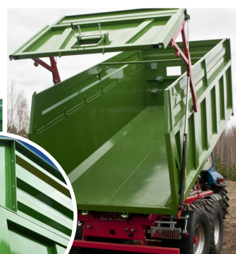
La commande hydraulique du hayon augmente la vitesse de déchargement
