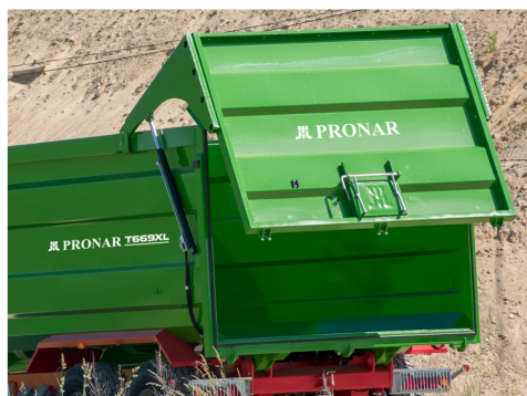
Hayon hydraulique avec verrouillage automatique et joint en caoutchouc sur le T669 XL
