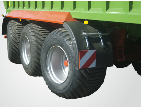
Grâce à l'essieu directeur avant et arrière, l'usure des pneus est minimisée
