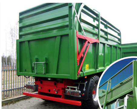
Grâce aux rehausses de silo, le volume de chargement du T669 peut être porté à 27,7m³
