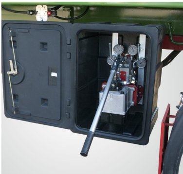
Le réglage de la pression dans le système de contrôle actif prend peu de temps et permet de manœuvrer de manière fluide dans les virages
