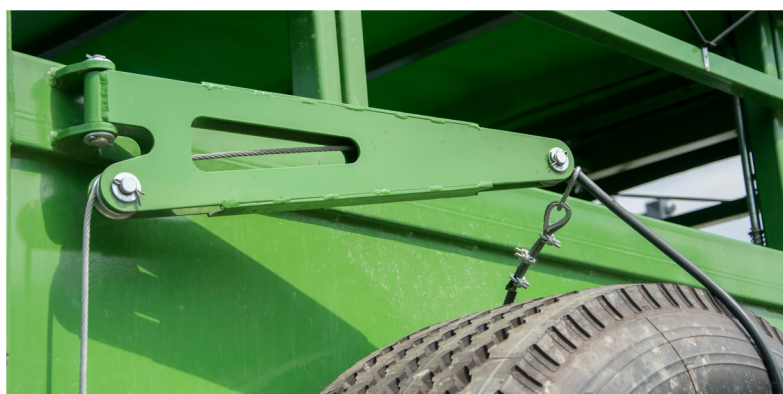
Treuil de roue de secours manuel sur la paroi avant (option)
