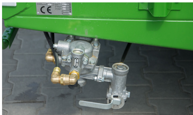
Régulation manuelle de la force de freinage en fonction du poids transporté dans la version standard
