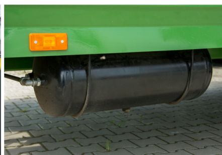
Frein à air comprimé à 2 conduites
