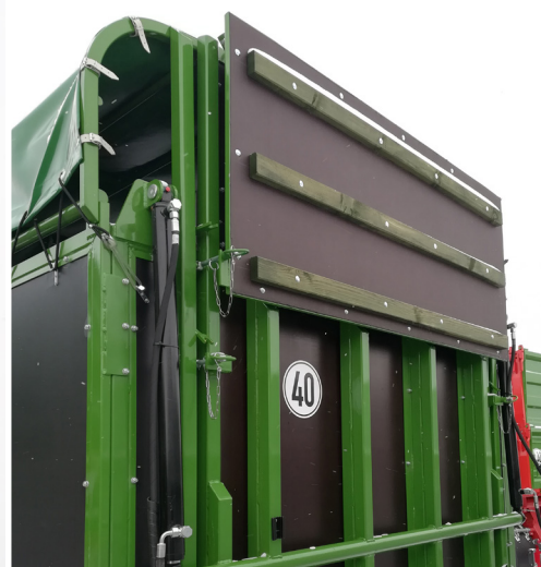
Hayon plus long, hydraulique (option) pour aplatir l'angle de descente
