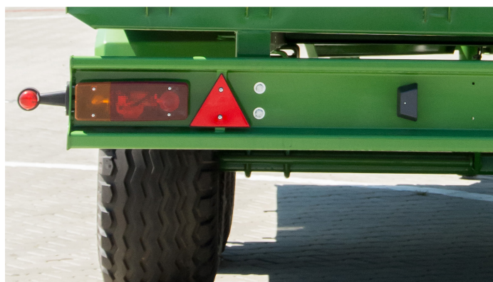
Protection anti-encastrement arrière homologuée
