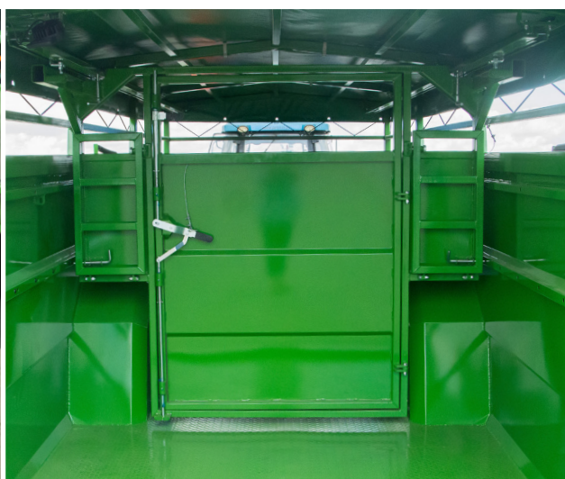
Cloison intérieure pour la séparation des animaux - sur glissières (option)
