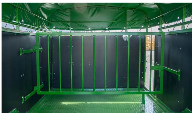
Grille de séparation coulissante (option) permettant un transport flexible et séparé des animaux
