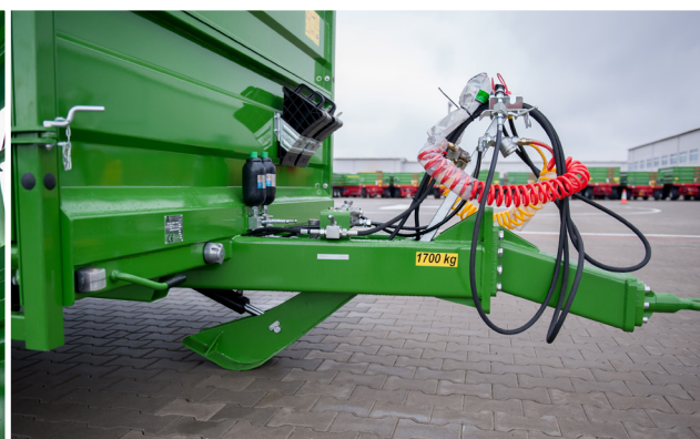
Béquille hydraulique "ciseaux" (en option), économisant du temps et de l'énergie
