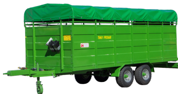
Parois en tôle de 2 mm en option
