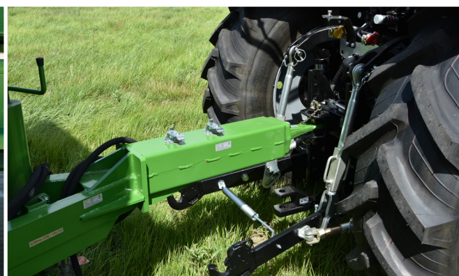
Timon universel pour attelage en haut et en bas avec anneau d'attelage rigide Ø 40
