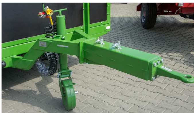
Timon universel pour attelage en haut et en bas avec anneau d'attelage rigide Ø 40
