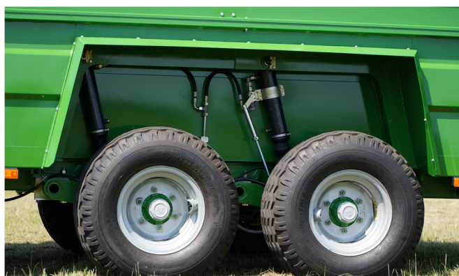
Amortissement hydraulique, ainsi que demi-axes pour améliorer le confort de transport des animaux
