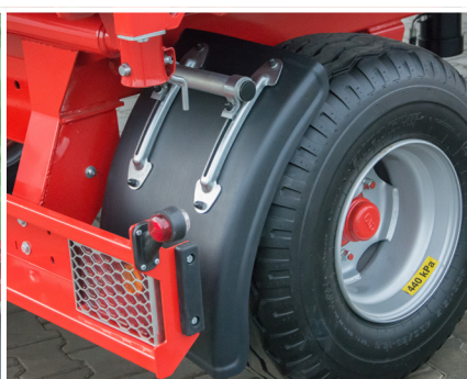
garde-boue sur l'essieu arrière et feux arrière avec grille de protection
