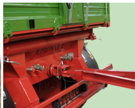
Sorties arrière pour l'attelage d'une deuxième remorque
