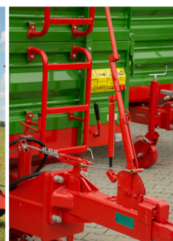
Timon à inertie avec attelage rigide Ø40
