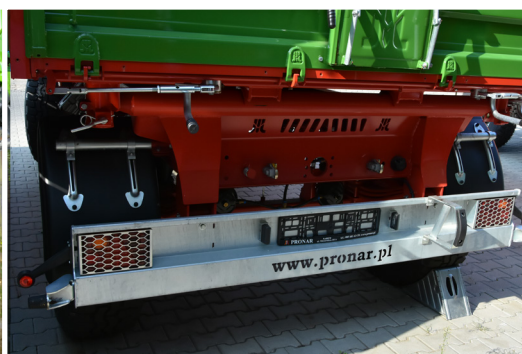
Pare-chocs homologué avec feux arrière à LED intégrés et grille de protection amovible
