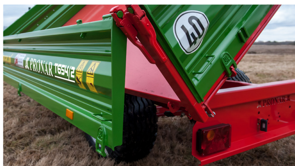
Angle d'inclinaison: vers l'arrière 50°, vers la gauche et la droite 46°
