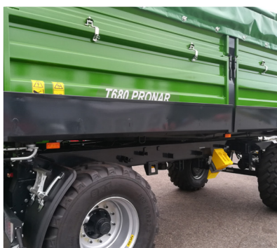
Gouttière latérale pliable (à gauche ou à droite) en tôle, sur toute la longueur, facilite le déchargement
