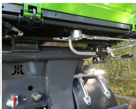
Déverrouillage hydraulique convivial des ridelles (option)
