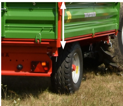
La faible hauteur de la plate-forme facilite le chargement de la remorque
