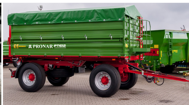
PT612 avec bâche roulée avec cadre (escamotable) + plateforme
