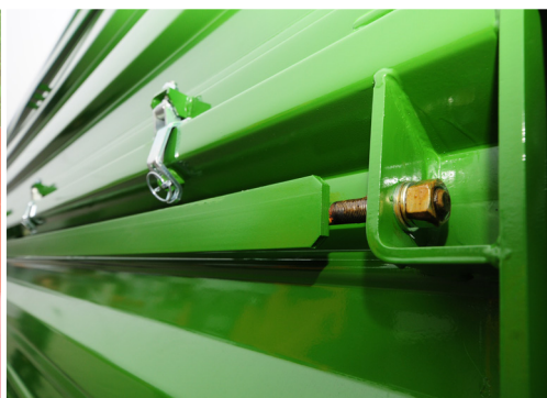
Barres de tension pour renforcer les profilés des ridelles
