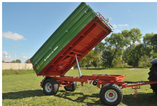
Caisse de chargement avec système d'ouverture sur trois côtés et fond conique (la largeur de la remorque augmente de 50 mm à l'arrière)
