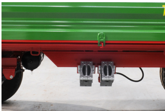
Cales de roue avec dispositifs de retenue sûrs inclus de série
