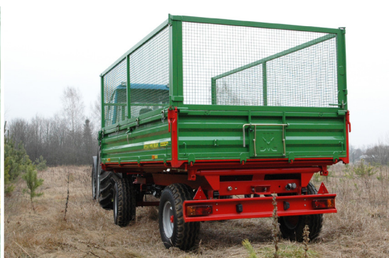
Réhausses grillagées en option (1000 mm) pour transporter en toute sécurité des matériaux grossiers légers
