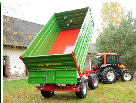
PT612 dispose d'un système de basculement sur trois côtés
