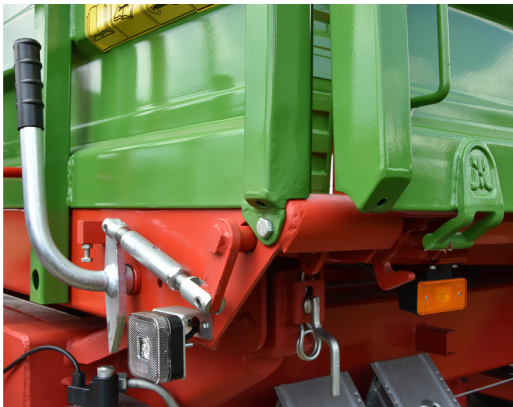
Verrouillage sur trois côtés pour faciliter l'ouverture de la ridelle
