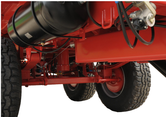
Essieux tandem à suspension parabolique et largeur de voie correspondante permettant de manœuvrer en toute confiance sur les terrains accidentés.
