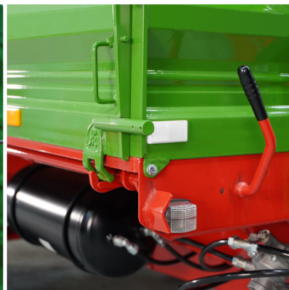
Verrouillage sur trois côtés facilitant l'ouverture de la ridelle
