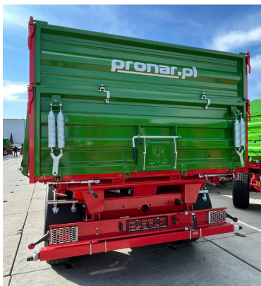
Ressorts de levage de ridelle montés en série pour une utilisation efficace
