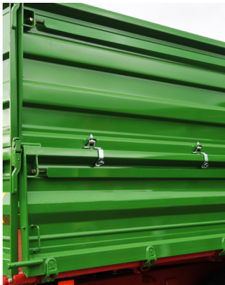
Barres de tension pour renforcer les parois latérales
