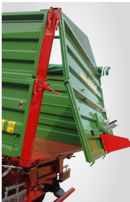
Ridelle et rehausse avec fonction pendulaire
