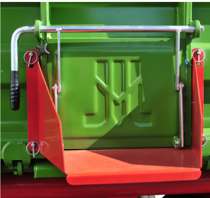
Gouttière à la trappe aux grains permettant un déchargement ciblé
