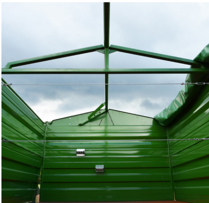
Câbles de tension entre les ranchers centraux pour un renforcement supplémentaire des ridelles
