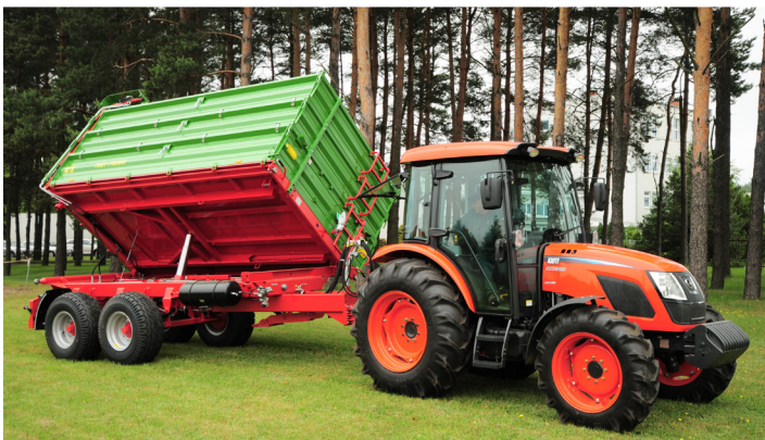
Caisse de chargement avec système d'ouverture universel et conception conique (élargissement de l'arrière de 50 mm)
