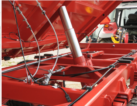
Châssis robuste grâce aux profils d'acier rectangulaires fermés
