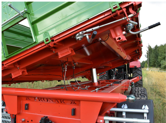
Système de basculement avec rotules à ressort (côté arrière)
