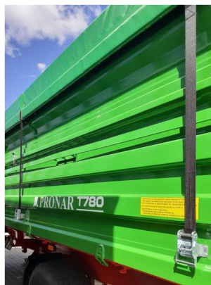
Fixation fiable de la bâche à l'aide de sangles d'arrimage
