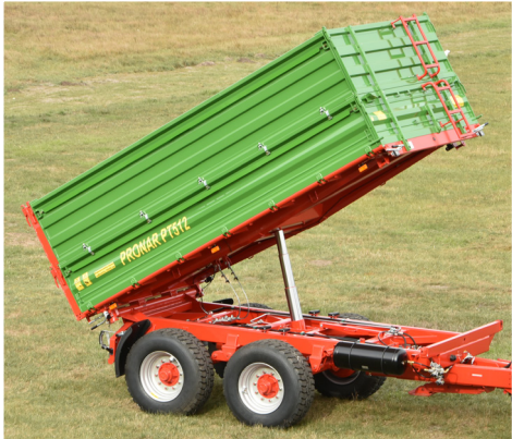
Déchargement efficace grâce à la fiabilité du vérin télescopique
