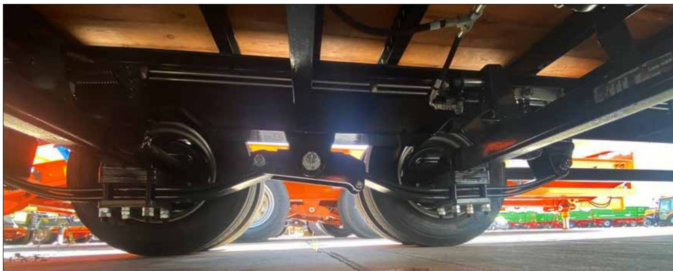
Suspension tandem à 4 lames paraboliques, à bras compensateurs, à essieux rigides équipés de freins à tambour
