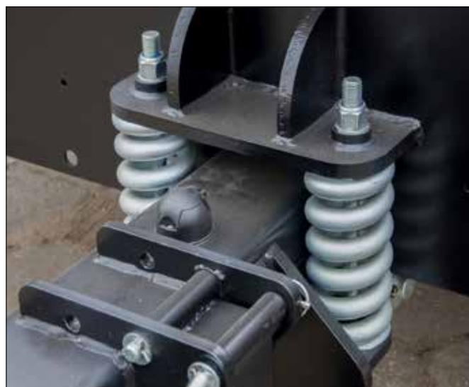
Flèche amortie avec deux ressorts en acier (standard)
