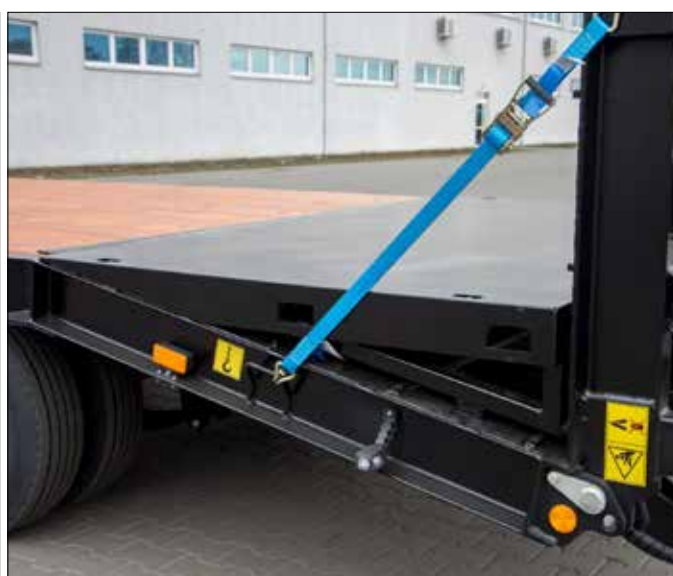
Insert pour la partie arrière prolongeant la partie plate de la plate-forme (option)
