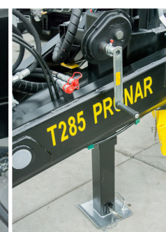
Béquille télescopique avec engrenage
