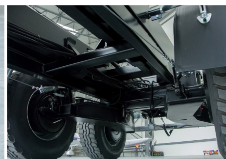
T285: Tandem à balanciers longitudinaux
