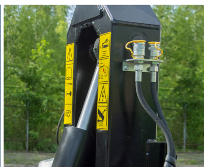
Sortie de l'installation hydraulique sur le crochet
