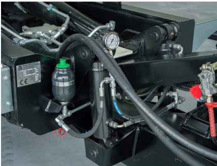
Timon réglable en hauteur, à suspension hydraulique, pour optimiser le confort de conduite et faciliter l'attelage
