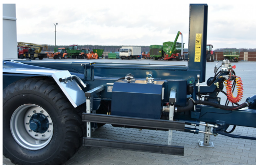
L'alimentation propre en huile avec une pompe efficace contribue à une plus grande force du cylindre et accélère le travail
