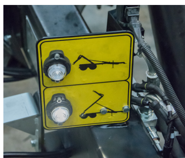
Commutation hydraulique des fonctions: Crochet/ basculement sur le T185/1, facilite l'utilisation
