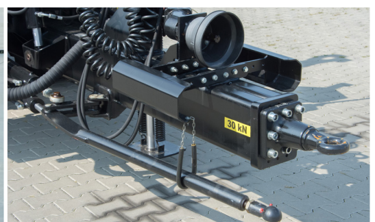
Direction forcée (dans le sens de la marche à droite) pour faciliter les manœuvres
