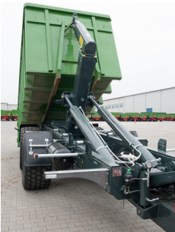
Déchargement et remontée du conteneur sans problème grâce aux deux vérins de basculement
