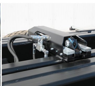
Verrouillage hydraulique du conteneur pour sécurisation optimale du conteneur
