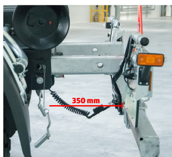
Protection anti-encastrément arrière réglable mécaniquement en trois positions (en fonction de la longueur du conteneur)
