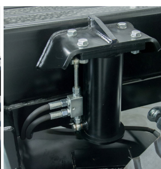
Support de l'essieu arrière pour la sécurisation pendant le chargement
