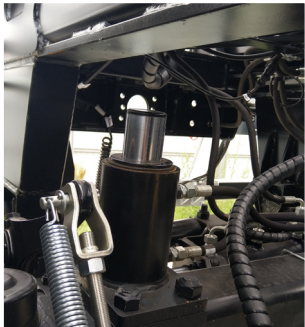
Support de l'essieu arrière pour stabiliser la remorque pendant le chargement du conteneur
