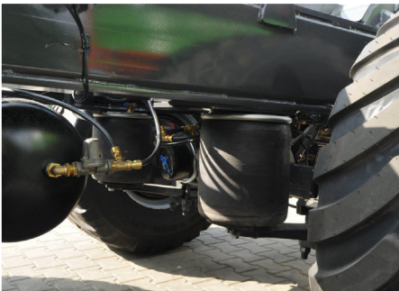
Suspension pneumatique pour amortir les chocs de la remorque de manière continue et fluide pendant le trajet
