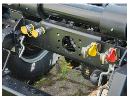
Équipement supplémentaire utile: connexions de freinage et hydrauliques arrière
