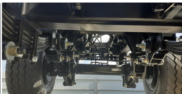
Châssis tandem avec suspension parabolique sur le T185/1 pour optimiser le confort de conduite
