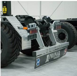
Facilité d'utilisation du pare-chocs arrière rétractable grâce à la fonction hydraulique
