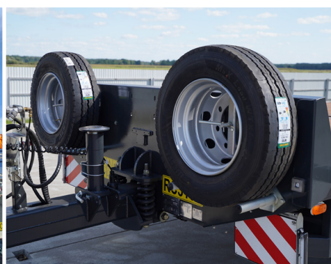
Supports de roue de secours à l'avant de la remorque
