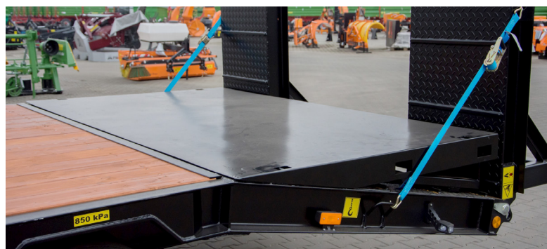
Insert pour la partie arrière prolongeant la partie plate de la plate - forme disponible sur RC2100/2, RC3100, RC3100/1
