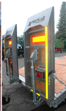
Rampes de chargement avec réflecteurs
