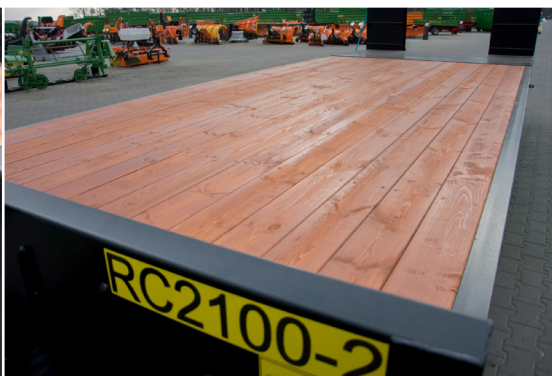
Plancher de plateforme en bois résineux (45 mm) pour réduire le poids total et augmenter le volume de chargement
