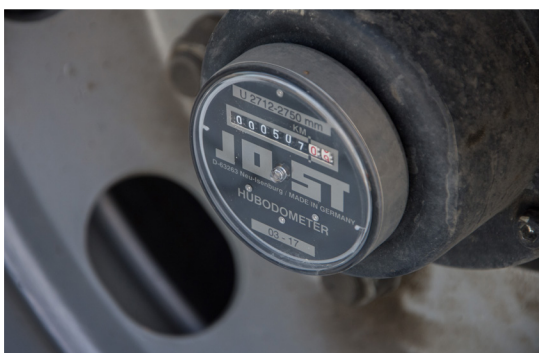
Compteur kilométrique en option pour déterminer facilement les intervalles de maintenance et les vérifications des pneus
