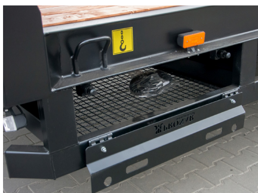
Panier en acier pour ranger les planches de bois pour l'élargissement de la plateforme
