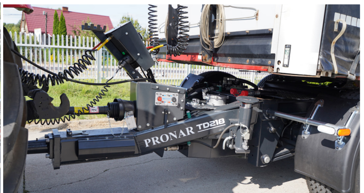
Flèche rigide en Y avec suspension inférieure
