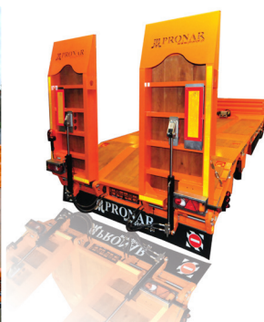
Rampes hydrauliques (standard pour PB3100, en option pour PC2300)
