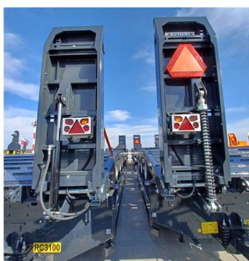
Rampes hydrauliques ou mécaniques au choix dans RC2100/2, RC3100, RC3100/1
