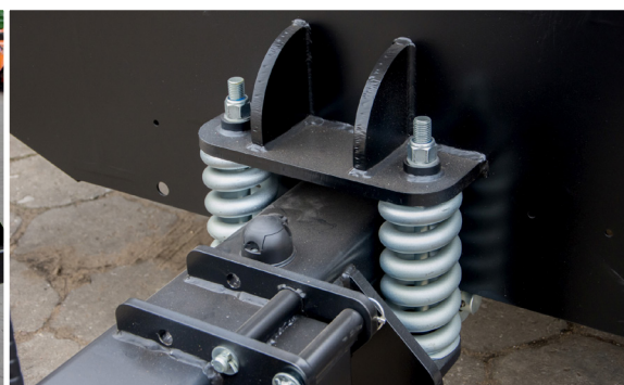
Timon à ressort augmente le confort de conduite
