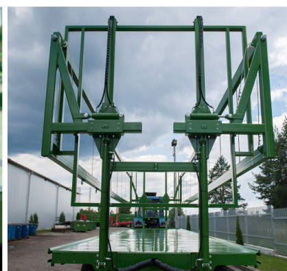
Sécurisation hydraulique de la charge, efficace en termes de temps et de force (option)
