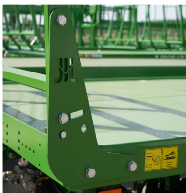
Angle d'inclinaison réglable des grilles de chargement pour le transport de balles rondes, ou de balles cubiques
