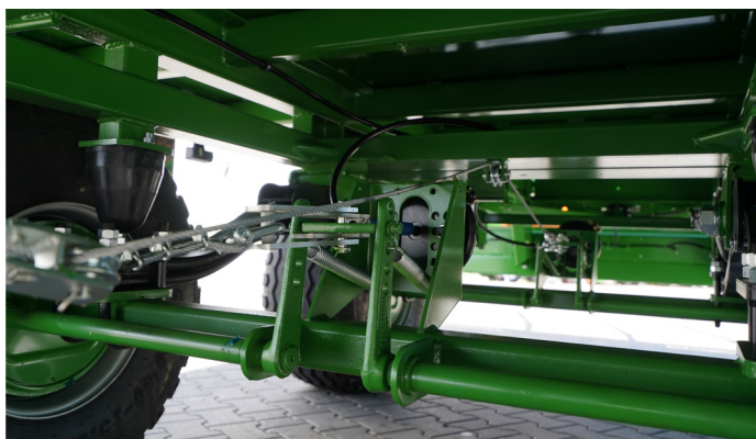
La construction basse et la hauteur adaptée de la grille de chargement permettent le transport de deux rangées de balles
