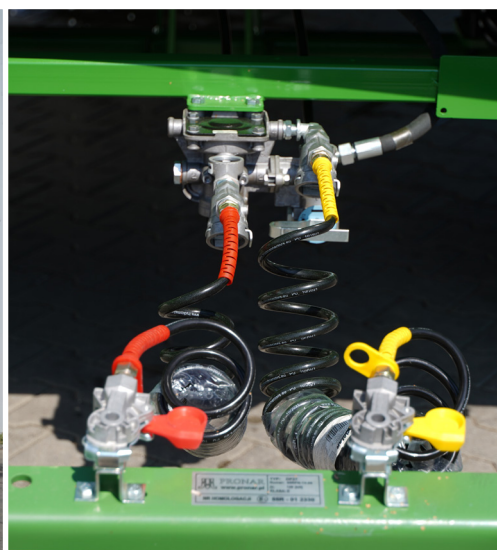
Système du freinage pneumatique 2-circuit: selon les besoins, manuel, ou réglable automatiquement
