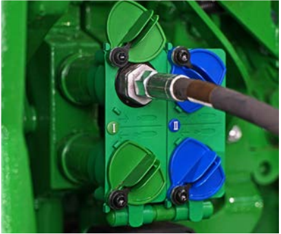
Raccordement hydraulique côté tracteur
