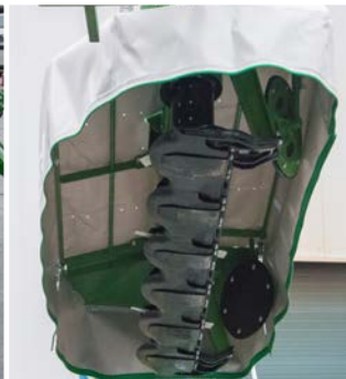
Barre de coupe côté inférieur
