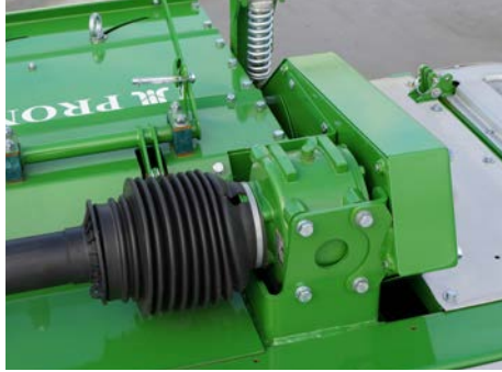
Système d'entraînement du conditionneur
