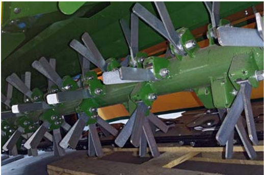
Arbre de conditionnement avec dents
