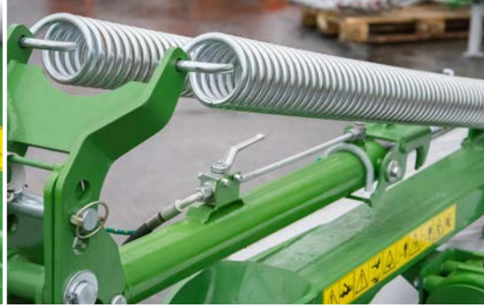
Système de suivi de terrain dynamique
