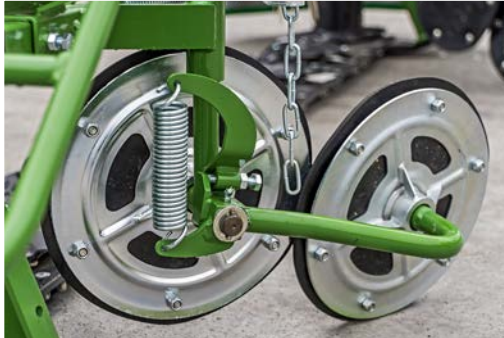
Dispositif de guidage d'andains double en caoutchouc
