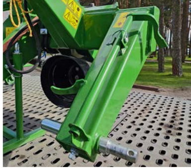
Outil de remplacement rapide des couteaux
