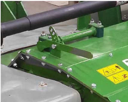
Levier de réglage du niveau de conditionnement
