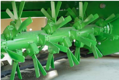
Système de montage des dents
