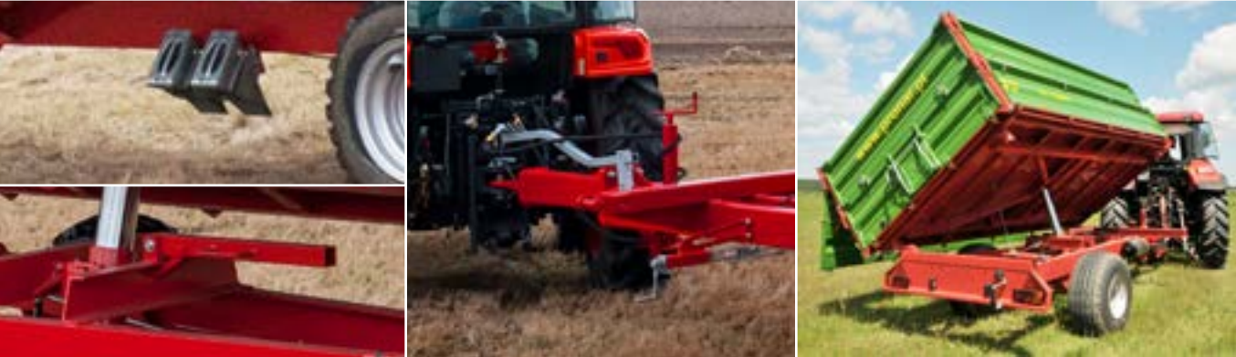
Cales de roues Support de service T654/2 - Flèche rigide pour connection avec attelage supérieur du tracteur Système de bennage sur 3-côtés avec joints à boule
