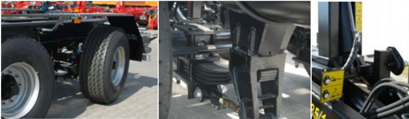
Essieu AV rigide et essieu AR suiveur avec blocage hydraulique de tournage Suspension tandem sur ressorts paraboliques Réglage automatique de fonction bennage/basculement
