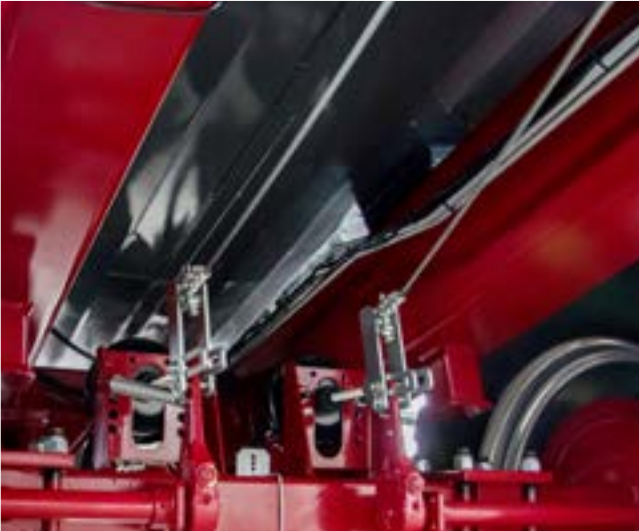
Châssis soudé de profils rectangulaires 300x200
