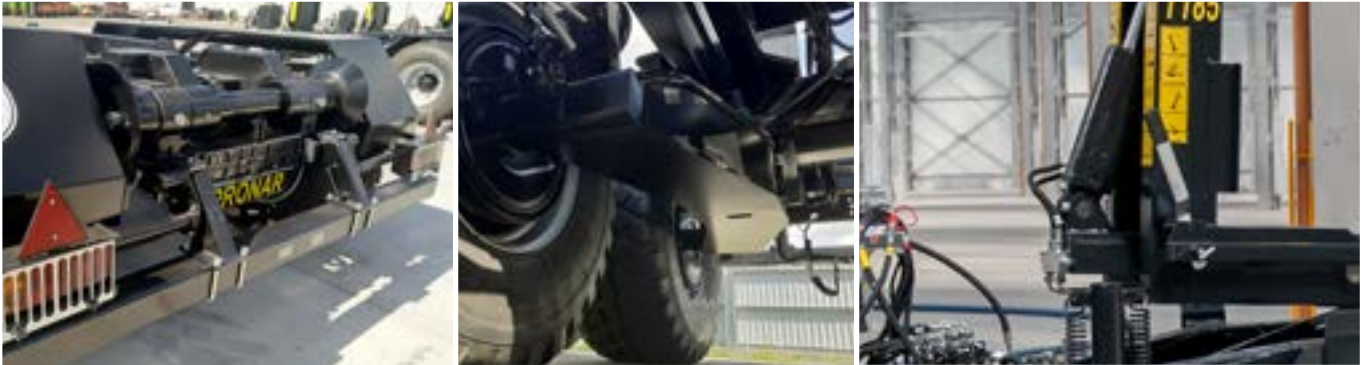
T185 - pare-choc arrière Suspension sur des balanciers Réglage manuel de fonction bennage/basculement
