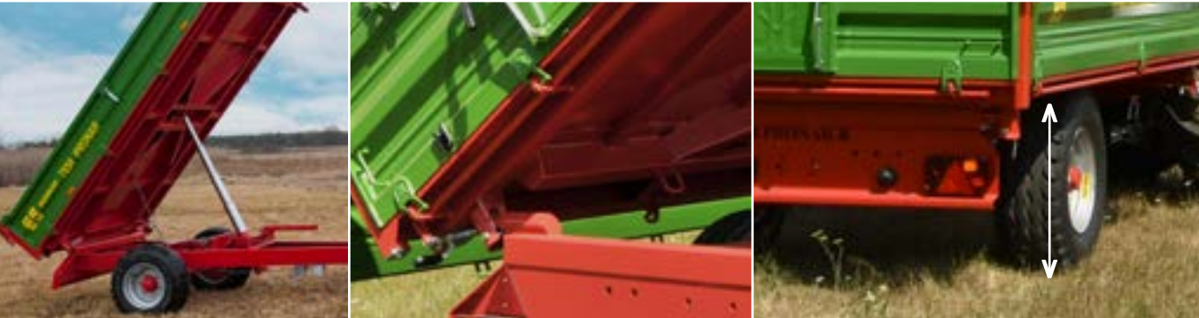
Système de bennage sur 3-côtés avec vérin télescopique avec une suspension articulée Système de bennage avec joints à boule arrière La caisse de chargement basse rend le chargement plus facile
