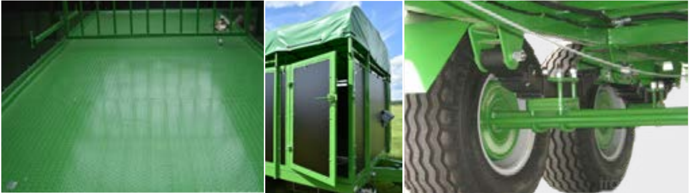
T046/1 Plancher en acier Porte latérale à l'avant de caisse T046/1 Suspension tandem
