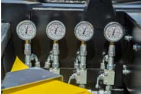
Système hydraulique d'essieu suiveur directionnel
