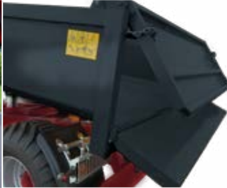
Porte hydraulique arrière 450 mm et porte arrière pendulaire avec possibilité de l'ouverture à droite
