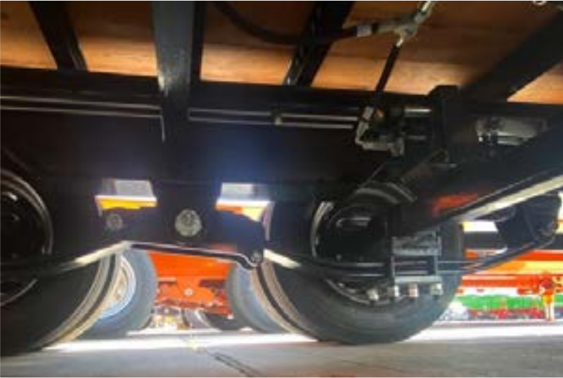
Suspension tandem sur ressorts paraboliques
