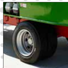
essieu renforcé sur pneus doubles
