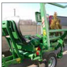
● système de chargement des balles latéral
