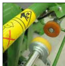
● ramasseurs de film hydraulique et coupe automatique
