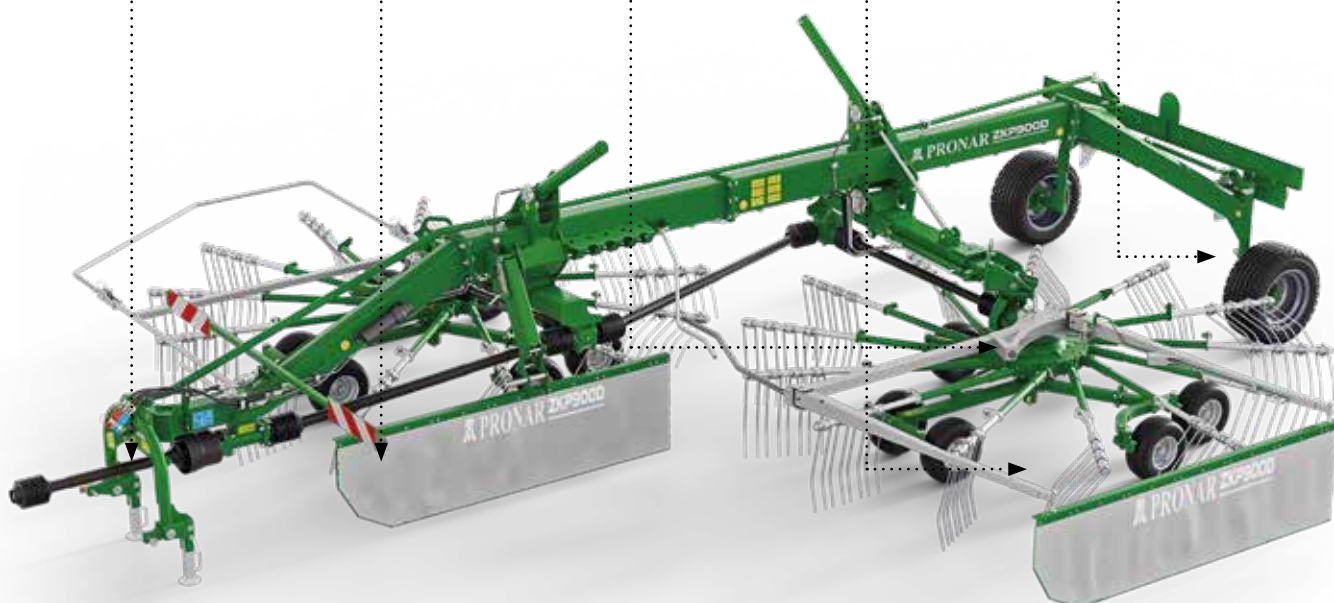
● 6 roues en tandem auto directionnelle sous les rotors
