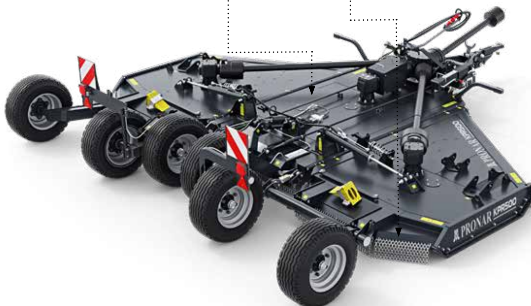
roues supplémentaires à l'avant du broyeur (option)
