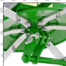
• 3 niveaux de réglage de l'angle de travail
