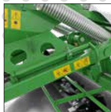
clé pour changement rapide des couteaux
