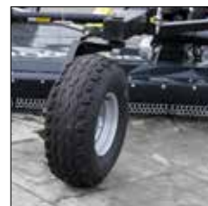
roues supplémentaires à l'avant du broyeur (option)
