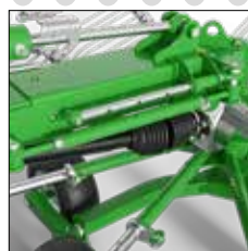
● réglage mécanique de la largeur de travail
