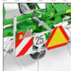
• panneaux d'avertissement avec éclairage routier
