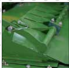
5 niveaux de réglage d'intensité du conditionneur (PDF301C)
