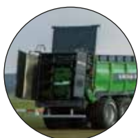
Déflecteur hydraulique pour limiter l'épandage
