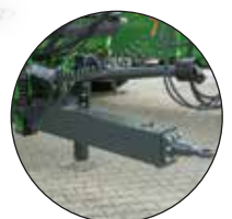
Timon amorti protégeant la barre d'attelage du couvercle
