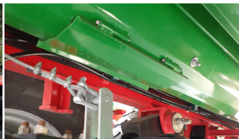
Quatre fenêtres d'inspection dans le plancher (fenêtre d'inspection avant à commande hydraulique) pour faciliter l'élimination de résidus
