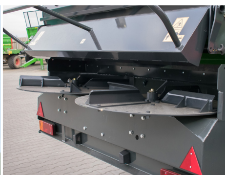
Adaptateur AH20 avec deux épandeurs larges à plaques équilibrées.
