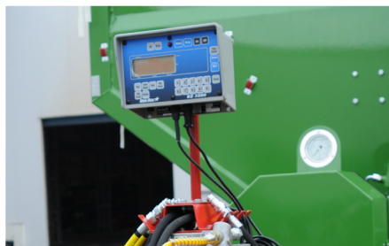
Les remorques T740 et T743 peuvent être équipées en option d'un système de pesage électronique permettant d'estimer avec précision la quantité de céréales dans le réservoir.
