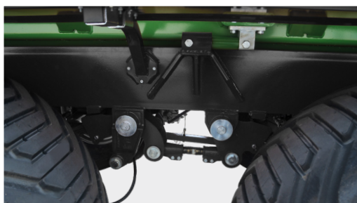
Châssis du modèle T740 avec suspension de type tandem et ressorts paraboliques à l'empattement de 1810 mm.
