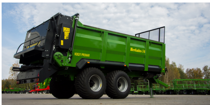
Solide et robuste – la caisse du modèle N262/1 mesure 1265 mm de haut et a une capacité de 14 m³
