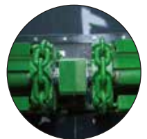
Convoyeur à chaîne avec bandes de transfert renforcées
