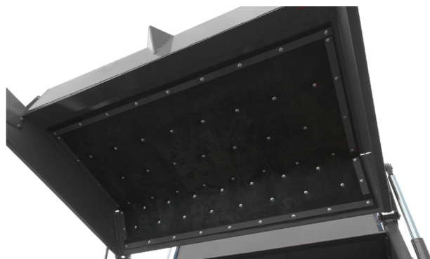
Revêtement en caoutchouc à l'intérieur du hayon
