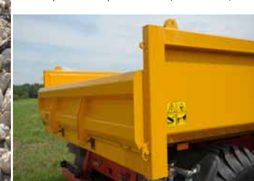
Hydraulically driven rear flap (height 450 mm) Paroi arrière à relevage hydraulique (hauteur 450 mm) Puerta trasera con apertura hidráulica (altura 450 mm) Parete posteriore ad apertura idraulica (altezza 450 mm)
