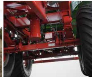
Starkes und solides Fahrwerk mit Parabelfederung erleichtert den Transport auf unwegsamen Gelände.
