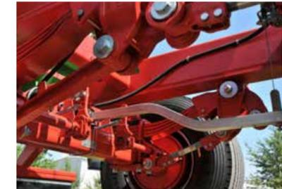
Starkes und solides Fahrwerk mit Parabelfederung und Nachlaufachse erleichtert den Transport sowohl auf unwegsamen Gelände, als auch während längerer Fahrten.
