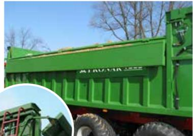
Die als Option angebotene hydraulische Seitenbordwand ermöglicht das Beladen durch tiefer liegende Maschinen.
