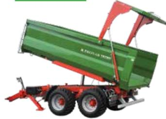
Die Seitenbordwände wurden aus einem Stück Blechtafel (ohne mittleres Gerippe) angefertigt. Dadurch erhält der Anhänger modernes Design und behält hohe Belastbarkeit.
