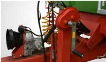
Die Kippeinrichtung mit eigener Pumpe und Öltank erlaubt das Kopplein mit Schleppern mit kleinerer Ölfordern.
