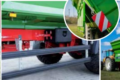
Details sind wichtig: der Anhänger kann sehr umfangreich zusätzlich ausgestattet werden. Dazu gehören z. B. unterschiedliche Anhängerkupplungen, Stützfüße, Plane, Werkzeugkasten oder seitliche Schutzeinrichtung.
