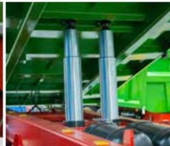
Zwei Zylinder sorgen für eine schnelle Entladezeit einer hohen Materialmenge.
