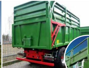
Dank den Silo-Aufsätzen kann das Ladevolumen des T669 auf 27,7m³ erhöht werden.
