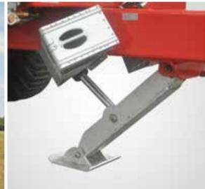
Leicht bedienbarer hydraulischer Schragstützfuß.
