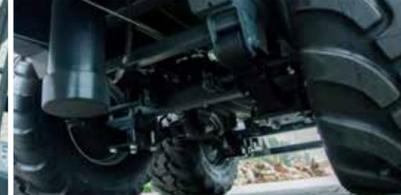
Der Fahrgestellrahmen aus rechteckigen geschlossenen Stahlprofilen garantiert die Zuverlässigkeit des Anhängers und 4 Parabelfedern mit Ausgleichsarmen absorbieren alle Vibrationen des Anhängers während des Transports.
