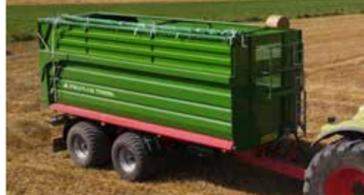
Aufsätze 600 mm aus Blech 2 mm mit dem perforierten Sichtfenster und PLEXI-Scheibe erhöhen die Ladevolumen des Anhängers bis 34,8m³.
