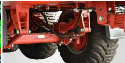
1. und 3. Nachlaufachse verbessern die Fahreigenschaften, erhöhen die Fahrsicherheit und minimieren den Verschleiß der Bereifung.
