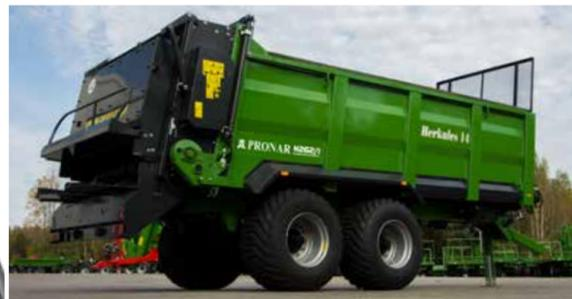
Stark und robust – die Mulde des Modells N262/1 hat eine Höhe von 1265 mm und eine Kapazität von 14 m³
