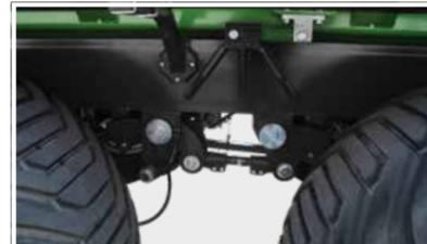
Fahrgestell des T740 mit Tandemaufhängung, Parabelfederung und Achsabstand von 1810 mm
