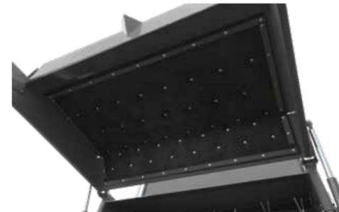
Gummiverkleidung der Innenseite der Heckklappe
