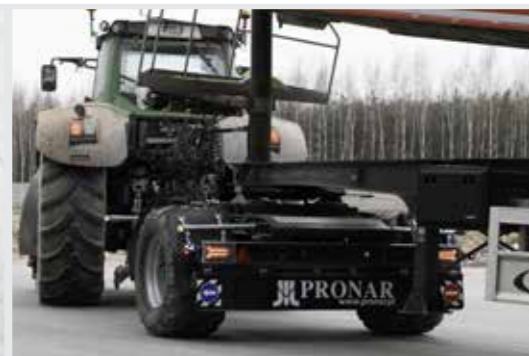
TD111 bei Teleskopausfuhr, während der Arbeit
