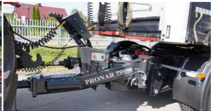
Starre Y-Deichsel mit Untenaufhängung
