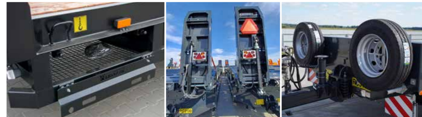
Stahlkorb zur Aufbewahrung der Holzbretter für die Bodenverbreiterung Wahlweise mechanisch o. hydraulisch gesteuerte Auffahrampen bei RC2100/2, RC3100 und RC3100/1 Ersatzradhalterungen am vorderen Teil des Anhängers
