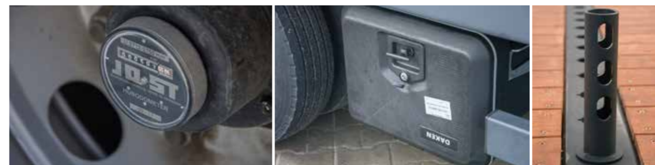
Optionaler Kilometerzähler zur einfachen Bestimmung von Wartungsintervallen und Reifenchecks Werkzeugkasten (ca. 50l, Option) Begrenzungsrungen zur Stabilisierung länglichen Ladegutes (z.B. Stahlprofile)
