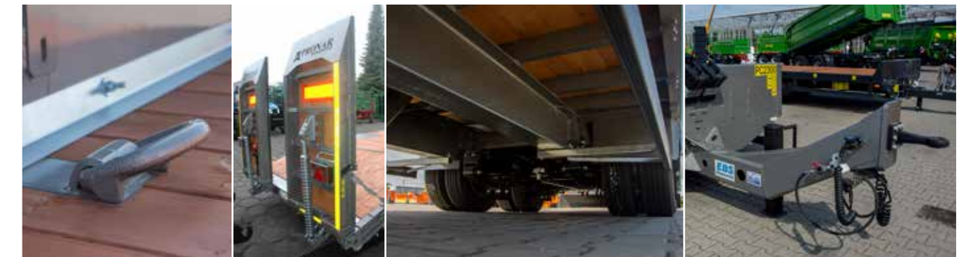
Zurringe für Spannseile Auffahrampen mit Reflektoren Fahrwerk mit Unterfahrschutz Starre Deichsel mit Obenanhängung
