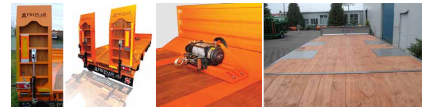
Hydraulische Auffahrampen (Standard bei PB3100, Option bei PC2300) Hydraulische Seilwinde 6500 kg oder 8000 kg (als Option) Nadelholzboden (45mm)
