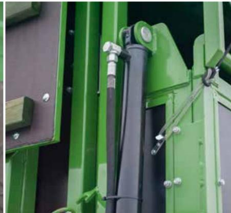
Hydraulisch gesteuerte Heckklappen
