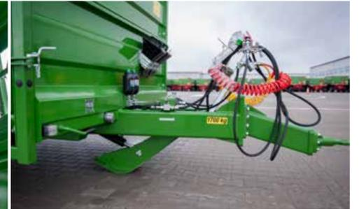
Zeit- und kraftschonender hydraulischer Schrägstützfuß mit Kugelventil (Option)
