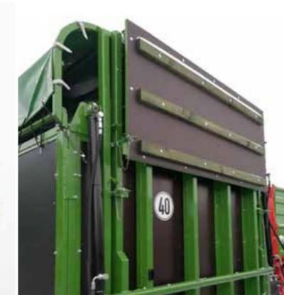
Verlängerte Heckklappe, hydraulisch (Option) zur Abflachung des Abstiegswinkels
