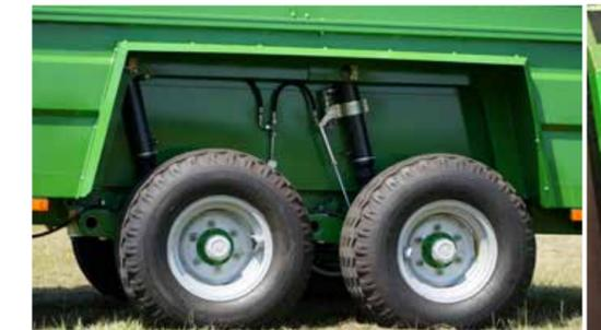
Hydraulische Dämpfung, sowie Halbachsen zur Erhöhung des Fahrkomforts für die Tiere
