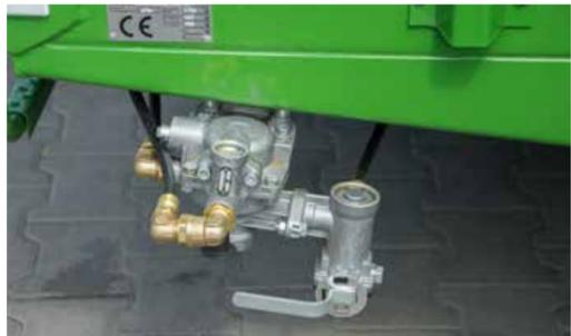
Manuelle Bremskraftregelung entsprechend des Transportgewichts in der Standardausführung
