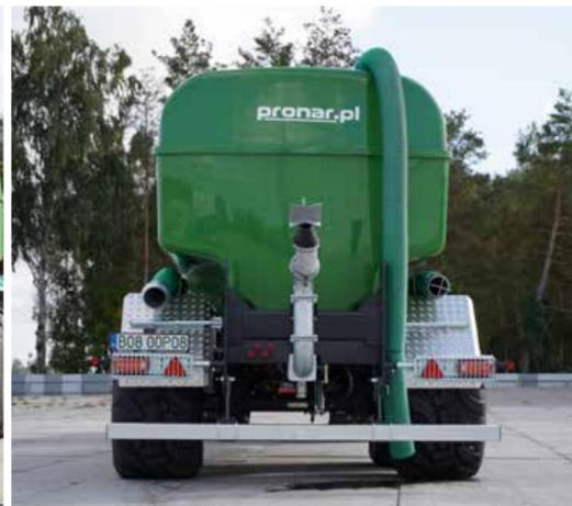
Tieferer Gewichtsschwerpunkt (im Vergleich zu Gülletankwagen aus Stahl) gewährleistet die Stabilität während der Fahrt
