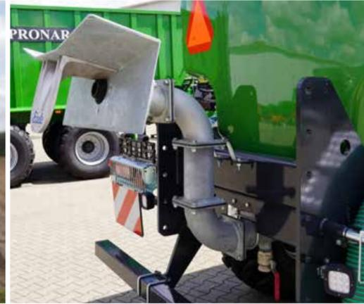
Exaktverteiler "Eisele" mit bodenwärtsgerichtetem Prallkopf ermöglicht windunabhängig breite Ausbringung
