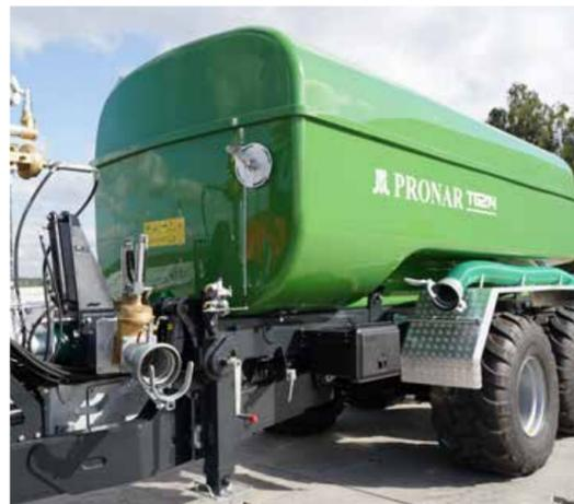
Das mit rechteckig geschlossenen Profilen (Ø250x100x8) konstruierte Fahrwerk wurde aus hochwertigem Stahl gefertigt
