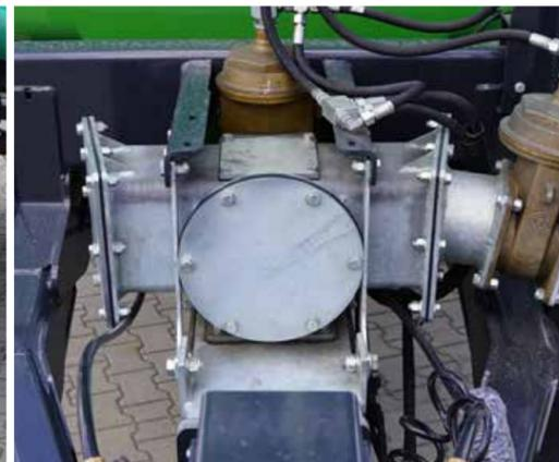
Schraubenspindel-pumpe erlaubt nahezu drucklosen Betrieb mit hohem Wirkungsgrad, geringer Schaumbildung und vergleichsweise tieferem Saugpunkt als bei Vakuumpumpen
