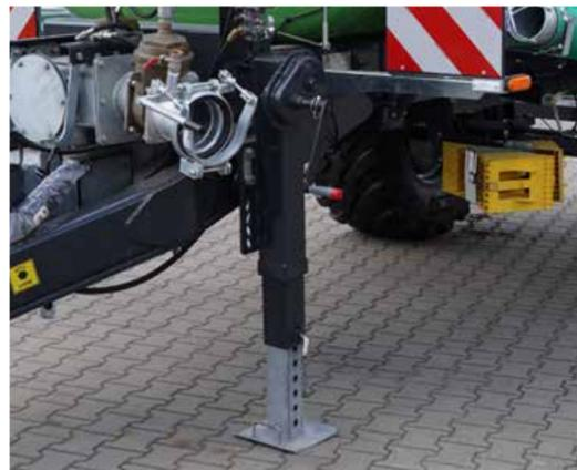
Teleskopstützfuß mit zweistufigem Getriebe
