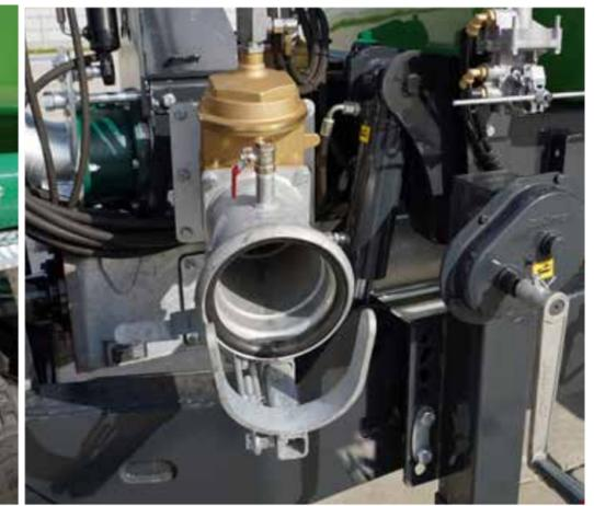
Perrot-Schnellkupplung und Ventil mit Hydraulikzylinder
