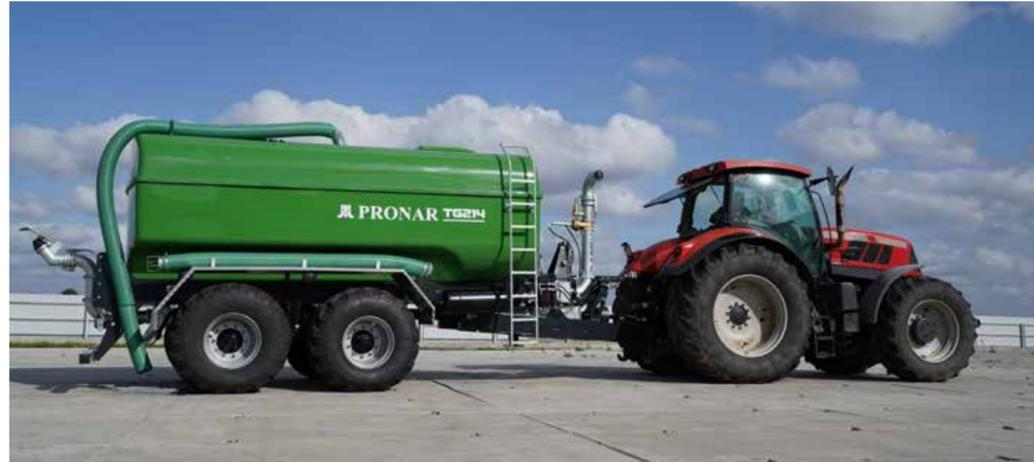
Der mit Glasmatten verstärkte Komposittank, sowie dessen optimale Beschichtungsstärke garantieren eine enorme chemische Widerstandsfähigkeit und erhöhen die Lebensdauer des Produktes
