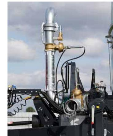
Saugrohr sowohl vertikal, als auch horizontal verstellbar - individuell angepasst an jeden Betrieb
