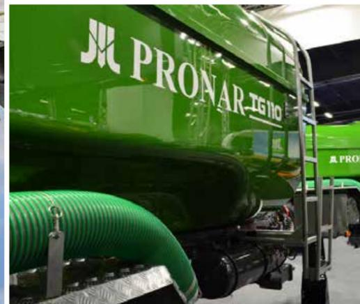
Aufstiegsleiter (einklappbar) erleichtert den Zugang zur Tankkluke
