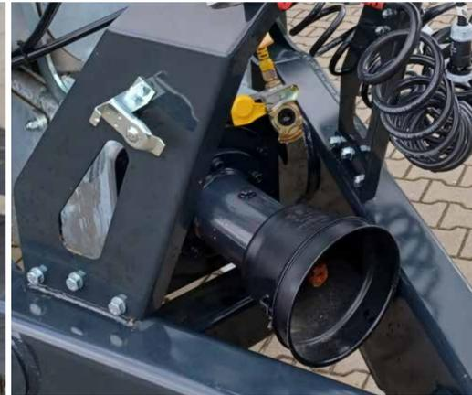
Teleskop-Gelenkwelle zum Anschluss der Schneckenpumpe an die Zapfwelle des Traktors (540 U/min)
