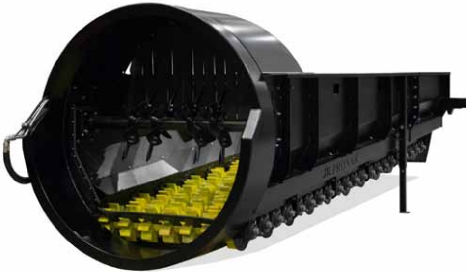
Walze zum Verteilen des Materials auf dem Deck
