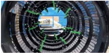
Sackaufreißmesser können in alle Siebtrommeln eingebaut werden
