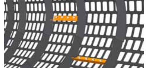
In der Siebtrommel montierte Schwellen helfen, das Material gründlicher zu reinigen
