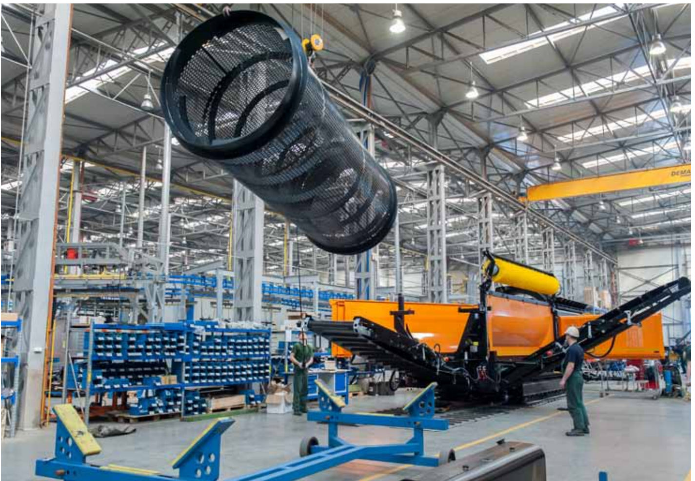
↑ Eines der wichtigsten Elemente des Trommelsiebs ist ein Stahltrommel
