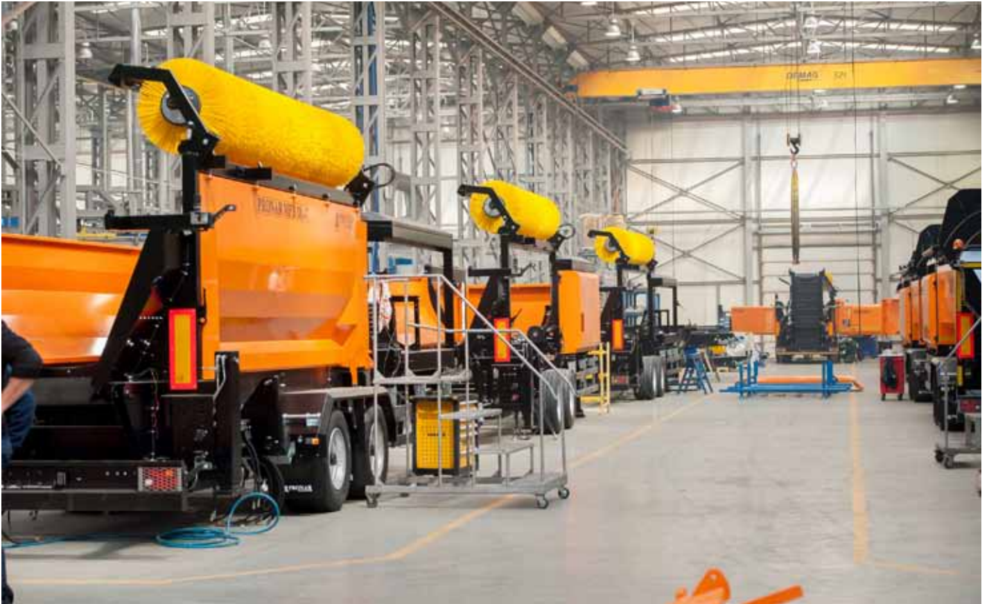
↑ Montagelinie der mobilen Trommelsiebe MPB 18.47
