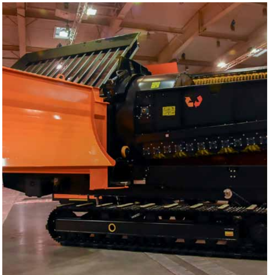
↑ In der Maschine eingebautes Sternsiebdeck
