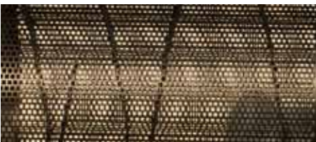
Dank des Güters um die Trommel ist es möglich, ein Sieb mit einer Perforation von weniger als 10 mm herzustellen
