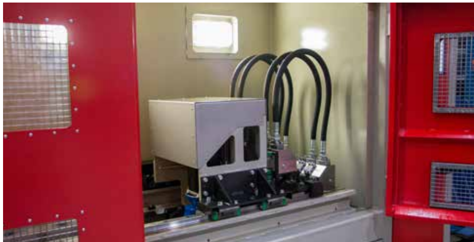
Der Forschungsstand ermöglicht die Untersuchung von hydraulischen Leitungen und Anschlüssen unter den Betriebsbedingungen (Arbeitsbedingungen), ohne dass die Montage im Zielprodukt erforderlich ist.
