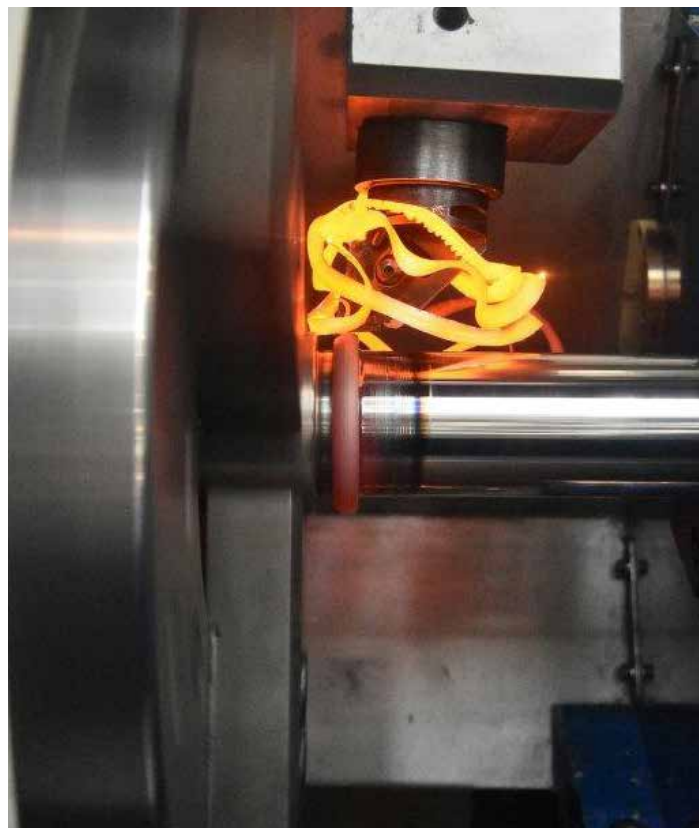
Das Reibschweißgerät ermöglicht eine dauerhafte Verbindung von Elementen infolge der Reibung von deren Kontaktflächen.
