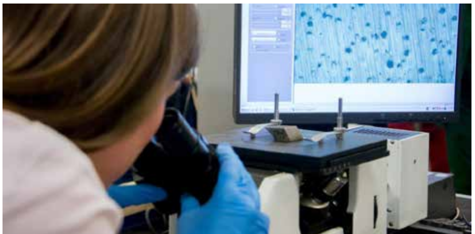
Der Arbeitsplatz für metallographische Untersuchungen ermöglicht die Prüfung der Mikrostruktur von Metallen und deren Legierungen, u. a. Analyse der Korngröße, Fremdkörpereinträge, der Porosität, Brüche und sonstiger Materialfehler.
