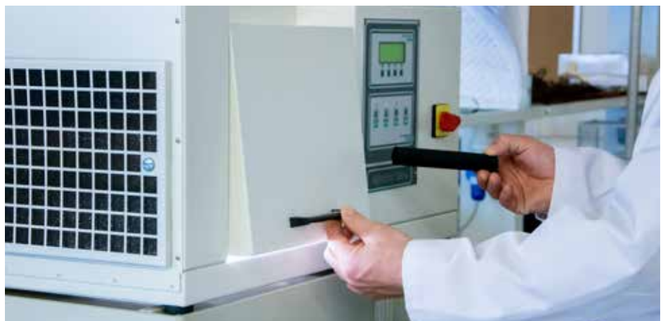
Die UV-Kammer ermöglicht eine Simulation der sich verändernden Wetterbedingungen, u. a. Temperatur, UV-Strahlung und Feuchtigkeit.
