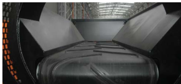
Bewehrtes Fördererband des Aufgabesiebes
