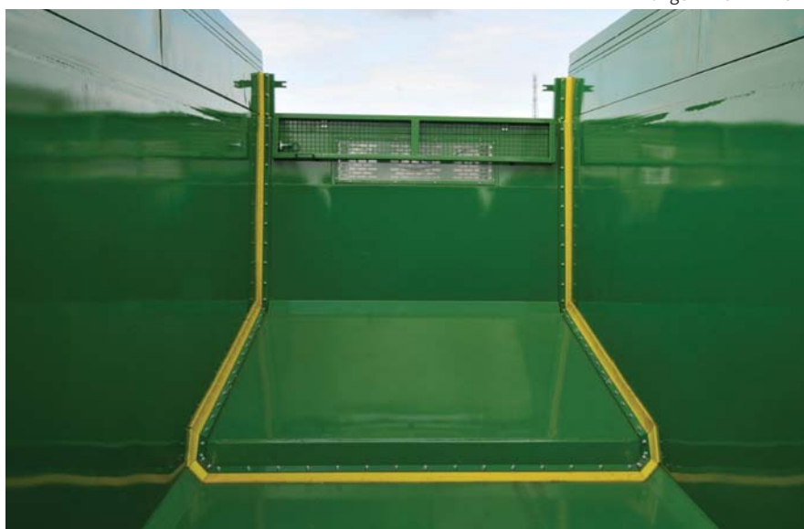
Der Mechanismus der verstellbaren Wand (power-push) in dem Anhänger PRONAR T900
