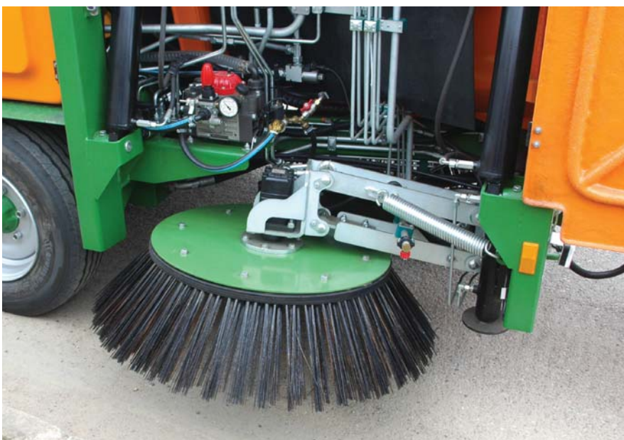
Die Tellerbürsten sind mit einem Regulierungsmechanismus ausgestattet, der den Winkel und die Neigung der Bürsten beim Fegen erleichtert
