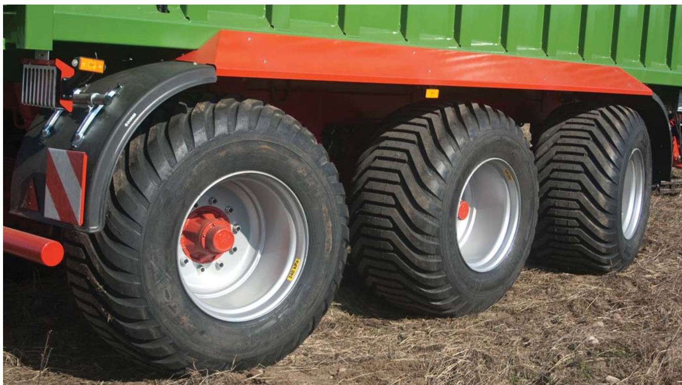
Pronar T900 folgt dank der vorderen und hinteren Drehachse dem Schlepper präzise
