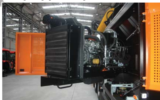
Der Motor und das Hydrauliksystem befinden sich auf dem Drehrahmen, was einen guten Zugang bei Service-Aufgaben sicher stellt.
