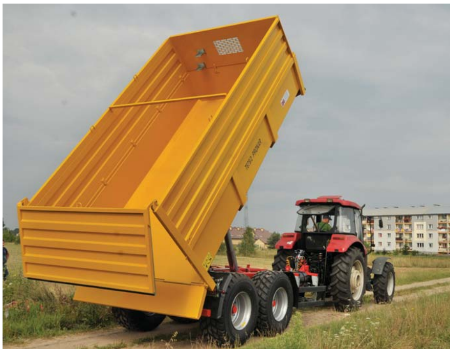
Anhänger PRONAR T679/2 mit montierten Aufsätzen, welche das Volumen bis auf 16,6 m 3 erweitern
