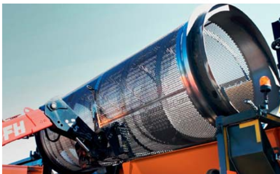
Schneller und einfacher Austausch der Siebtrommel
