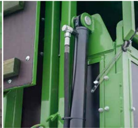
Verlängerte Heckklappe, hydraulisch (Option)
