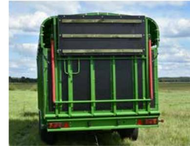
Verlängerte klappbare Heckklappe
