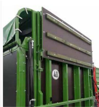
Verlängerte Heckklappe, hydraulisch (Option)
