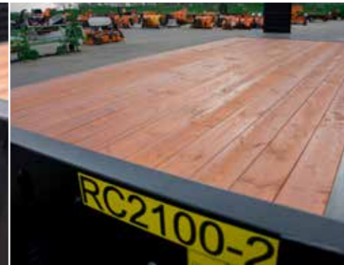
Plattformboden aus Nadelholz (45 mm)
