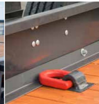
Zurringe für Spannseile, Nadelholzboden (45 mm)
