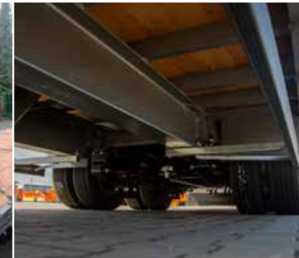
Fahrwerk mit Unterfahrschutz
