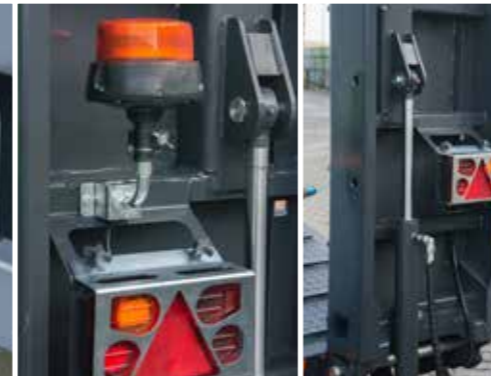
Hydraulisch gesteuerte Auffahrrampen mit Warnlicht (Option)
