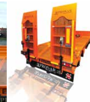
Hydraulische Auffahrrampen (Standard bei PB3100, Option bei PC2300)
