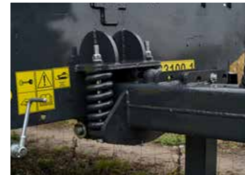
Gefederte Deichsel und Kurbelbremse am Vorderrahmen
