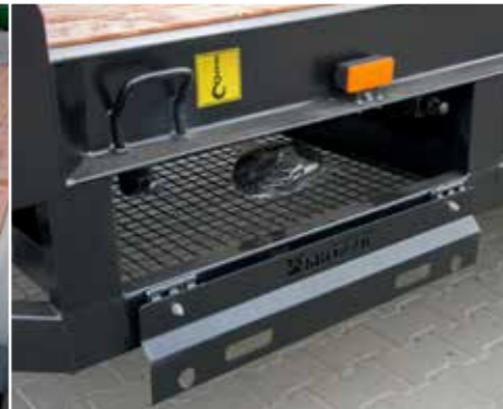
Stahlkorb zur Aufbewahrung der Holzbretter für die Bodenverbreiterung
