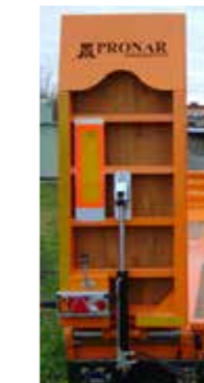
Hydraulische Auffahrrampen (Standard bei PB3100, Option bei PC2300)
