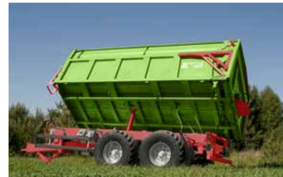
Das Modell T669 ist als Heckkipper bekannt. Das Modell T669/1 ermöglicht das Kippen sowohl nach rechts, links als auch nach hinten.
