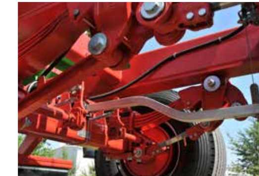
Starkes und solides Fahrwerk mit Parabelfederung und Nachlaufachse erleichtert den Transport sowohl im unwegsamem Gelände als auch während längerer Fahrten.
