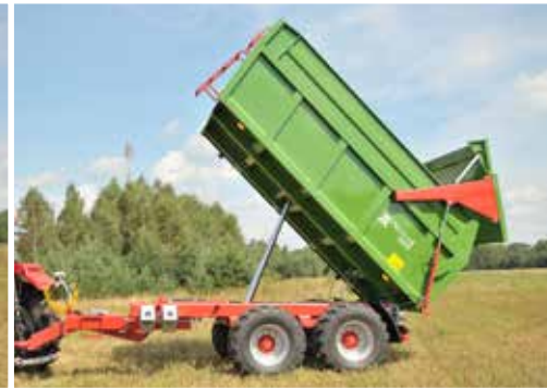
Der aus rechteckigen Stahlprofilen geschweißter Rahmen garantiert eine hohe Belastbarkeit.
