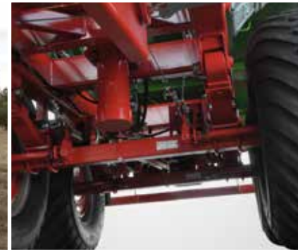
Starkes und solides Fahrwerk mit Parabelfederung erleichtert den Transport im unwegsamem Gelände.
