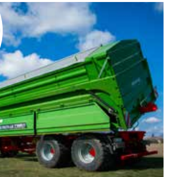
Seitenkippen ermöglicht schnelles und effizientes Entladen.
