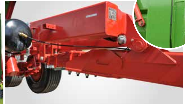
Die gefederte Deichsel überträgt keine Schwingungen an den Schlepper.
