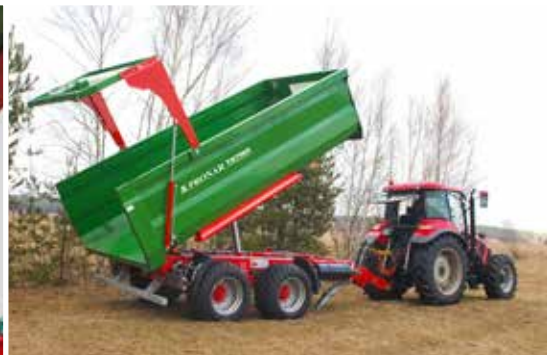
Dank der Gummidichtung in der Heckklappe des T679M kann das Schüttgut sicher und ohne Verlust transportiert werden.
