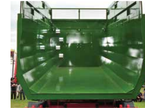
Die Seitenborwände des T700M wurden aus einem Stück Blechtafel angefertigt. Dadurch ist der Anhänger sehr belastbar.
