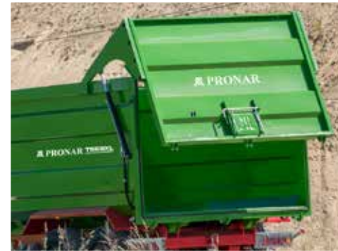
Hydraulische Heckklappe mit automatischer Verriegelung und Gummidichtung bei dem T669 XL.
