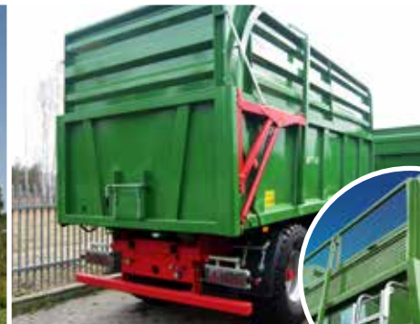
Dank den Silo-Aufsätzen kann das Ladevolumen des T669 auf 27,7m 3 erhöht werden.
