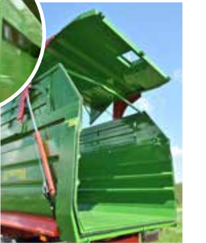
Das neue Hydrauliksystem der Heckklappe mit Gummidichtung garantiert eine exakte Verriegelung und Dichtigkeit der Ladekiste.
