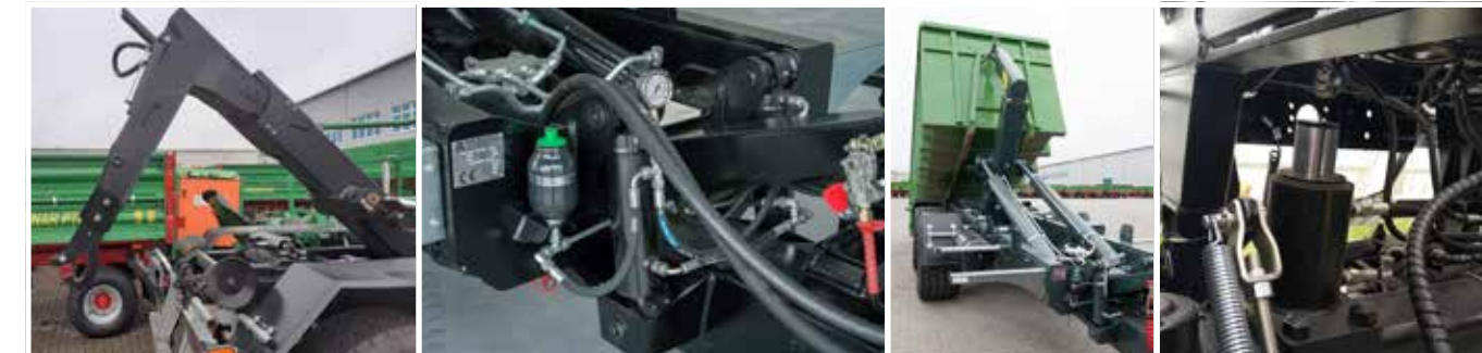
Schub- und Knickarm zur Abflachung des Aufzugswinkels Höhenverstellbare, hydraulisch gefederte Deichsel, zur Optimierung des Fahrkomforts und Erleichterung des Ankuppelns Problemlose Entladung und Aufziehung des Containers dank der zwei Kippzylinder Hinterachsabstützung zur Stabilisierung des Anhängers während der Verladung des Containers
