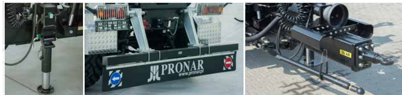
Hydraulischer Stützfuß (klappbar) als Option
