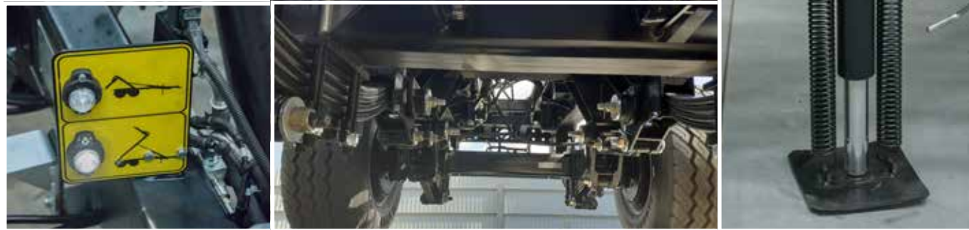
Hydraulische Umschaltung der Funktionen: Haken/Kippen beim T185/1, erleichtert die Bedienung Tandemfahrwerk mit Parabelfederung beim T185/1 zur Optimierung des Fahrkomforts Hydraulischer Stützfuß mit Kugelventil
