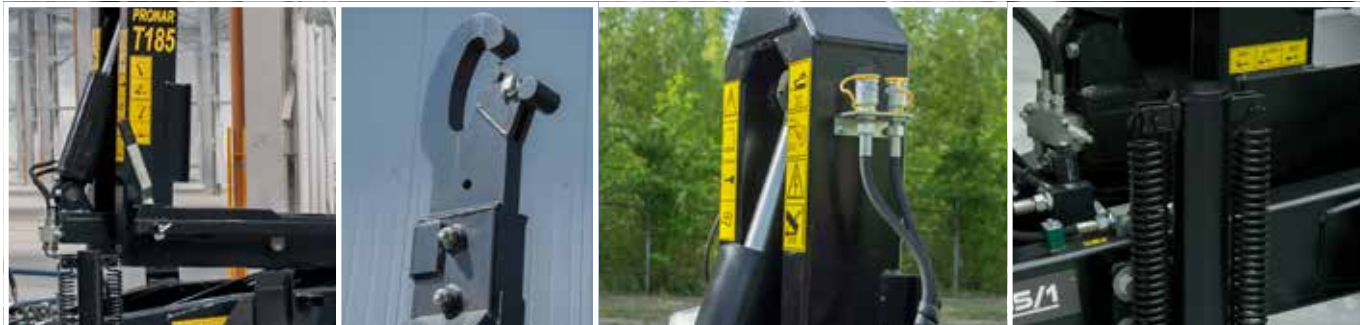
Mechanische Einstellung der Funktionen: Haken/Kippen beim T185 Haken mit zwei höheneinstellbaren Positionen und automatischer Containerverriegelung Nützliche Zusatzausstattung: Hydraulikanchlüsse auf dem Haken
