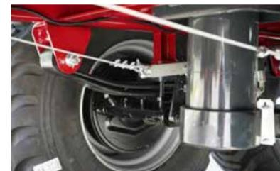
Tandemaufhängung mit Längslenkern; mit Halbachsen mit Trommelbremsen ausgestattet
