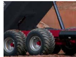
Tandem – Fahrwerk mit Trommelbremsen 300x90mm
