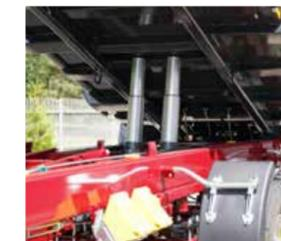
Zwei Teleskopzylinder zur zuverlässigen Entladung
