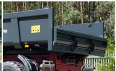
Hydraulische Heckklappe 370 mm hoch
