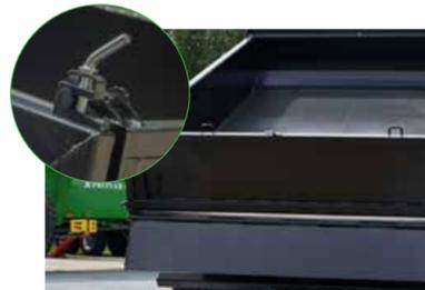
Pendelnde Heckklappe zur bequemeren Entladung
