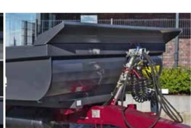
Abgerundete Vorderwand des Aufbaus (angepasst für die Verwendung des Grabenlöffels)
