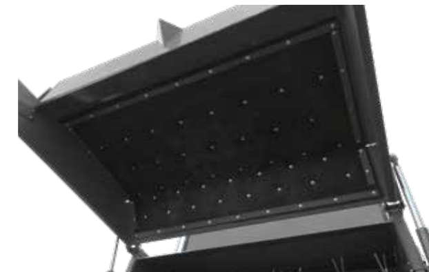
Gummiverkleidung der Innenseite der Heckklappe
