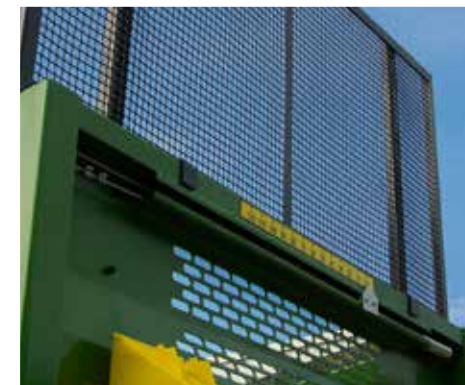
Höhenanzeiger der Rückwand
