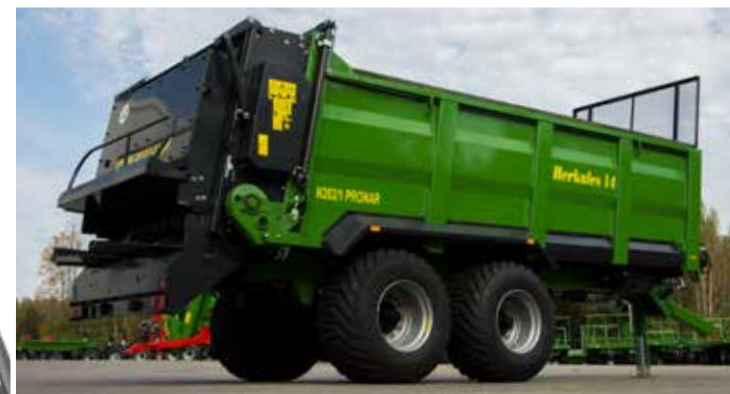
Stark und robust - die Mulde des Modells N262/1 hat eine Höhe von 1265 mm und einer Kapazität von 14 m³
