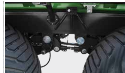
Das Fahrwerk des T740 mit einer Tandemfederung und Parabelfedern bei einem Achsabstand von 1810 mm
