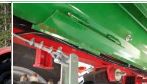
Vier Revisionsfenster am Boden (vorderes Revisionsfenster hydraulisch gesteuert) zum leichten Entfernen von Restmaterial
