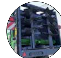
Streudapter mit zwei vertikalen Walzen
