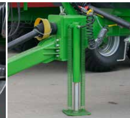
Einfach und sehr praktisch - hydraulischer Stützfuß
