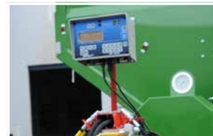
Zur genauen Abschätzung der Getreidemenge im Tank können die Anhänger T740 und T743 optional mit einem elektronischen Wiegesystem ausgestattet werden
