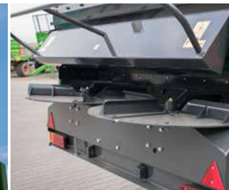
Adapter AH20 mit zwei breiten Streuern, ausgewuchteten Tellern
