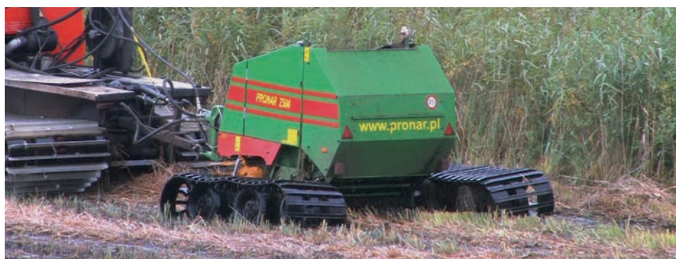
Presse PRONAR Z500G – avec système de roulement à chenilles qui permet de travailler sur des terrains mous et marécageux
