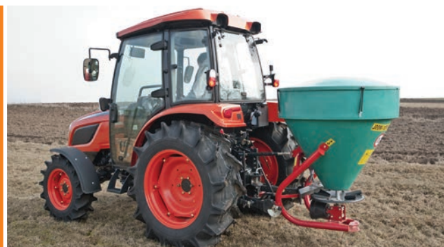
Épandeur d'engrais FD1-M05 de capacité 500 dm 3
