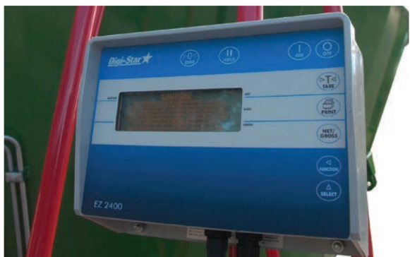
Affichage pour surveiller le poids des ingrédients de fourrage et le temps de travail
