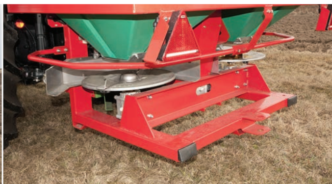
Disques d'épandage en acier résistant aux acides et à la corrosion
