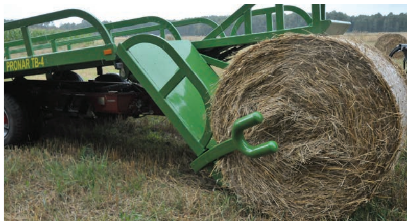
Plate-forme de chargement (2550mm) permet le chargement des balles dans deux rangs
