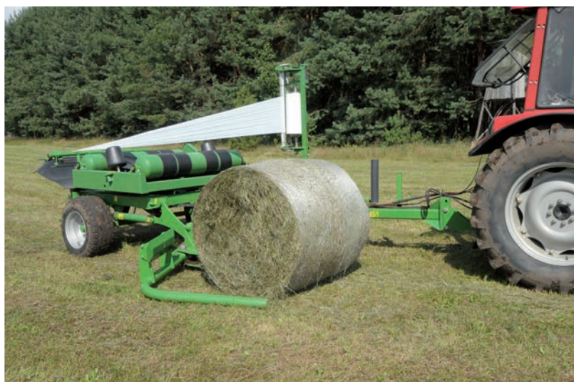
Chargement frontal avec accès latérale à la balle
