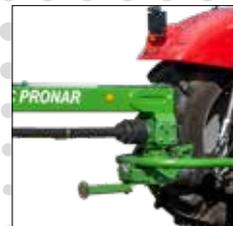
• geeignet für den Antrieb von 540 und 1000 U/min
