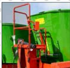
• Plattform mit Stufen und Schutzplanke
