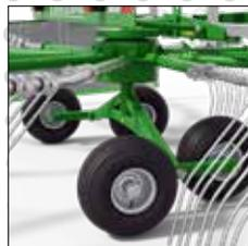
● 4-Rad-Fahrwerk in Tandem-Anordnung
