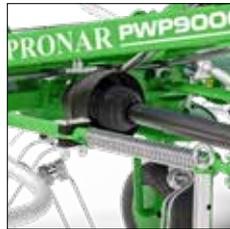
• Federdämpfer zur Stabilisierung der Maschine
