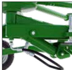
● hydraulische Federung ermöglicht die Umwandlung der Betriebsstellung in die Transportstellung
