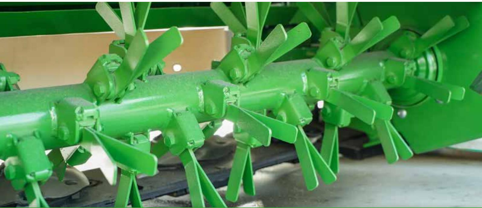
Der Aufbereiter beschädigt die Wachsschicht der Pflanzen und reibt sie ab, wodurch die Trocknung beschleunigt, die Belüftung erleichtert und eine lockere Schwade abgelegt wird. Die Grubberzinken sind durch ein Gummielement gedämpft. Rechenzinken aus Metall erleichtern die Lenkung des Materialflusses.
