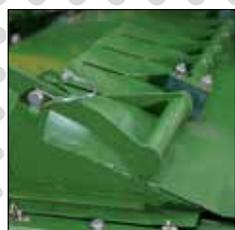
5-stufige Leistungseinstellung der Schwadgutaufbereitung (PDF301C)
