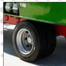
• verstärkte Achse auf Doppelbereifung
