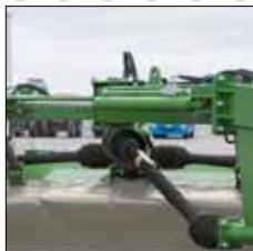
• mittige Deichsel ermöglicht das Mähen auf der rechten oder linken Seite der Zugmaschine
