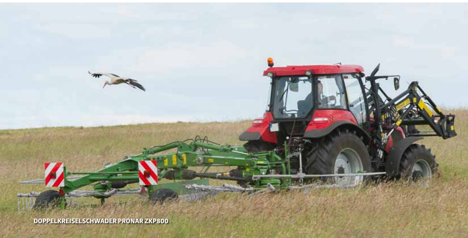
Hydraulizylinder zur Einstellung der Arbeitsbreite der Maschine - 7-8 m
