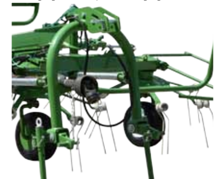
Wartungsfreies fettgeschmiertes Karussellgetriebe
