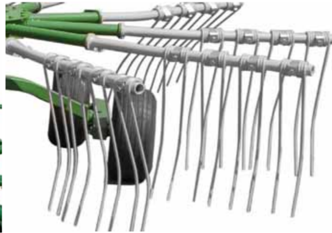
Schwaderfinger aus hochfestem Stahl
