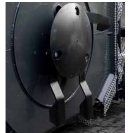
Drei horizontal rotierende Köpfe, bestückt mit drei Schneidmessern
