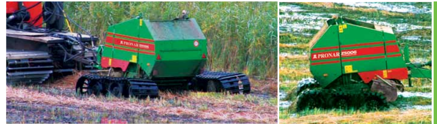
RUNDBALLENPRESSE PRONAR Z500G - Raupenfahrwerk ermöglicht die Arbeit auf den Feuchtgebieten
