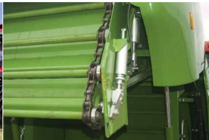
Rollenkette ermöglicht die Sammlung sowohl vom stark aufgetrockneten, als auch feuchtem Material
