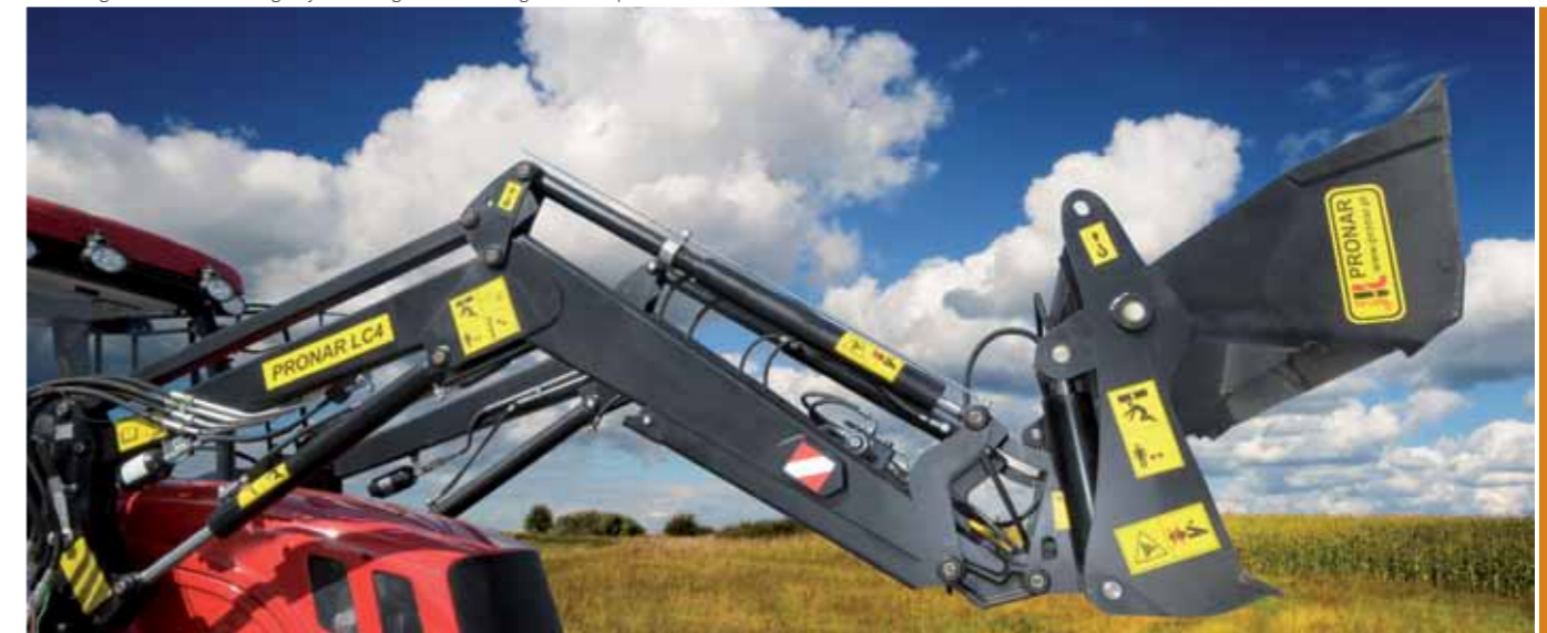
Werkzeugloses Schnell-Montage-System der gesamten Ausleger-Produktpalette. Auf dem Foto mit dem Multifunktionslöffel PRONAR CW-18E.
