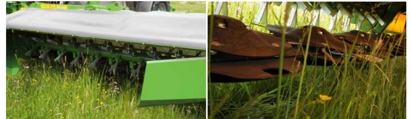
Ein Bodenlockerer beschleunigt die Aufbereitung des Futters und gewährleistet gleichzeitig hohe Qualität Die Maschinenfinger aus verschleißfestem Stahl fangen das Mähgut vom Mähbalken ab
