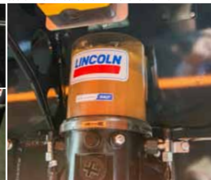
Центральная система смазки обеспечивает хорошее состояние наиболее важных элементов машины.
