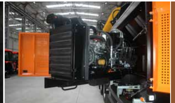
Двигатель и гидравлическая система размещаются на поворотной раме, что обеспечивает удобный доступ при проведении сервисных работ
