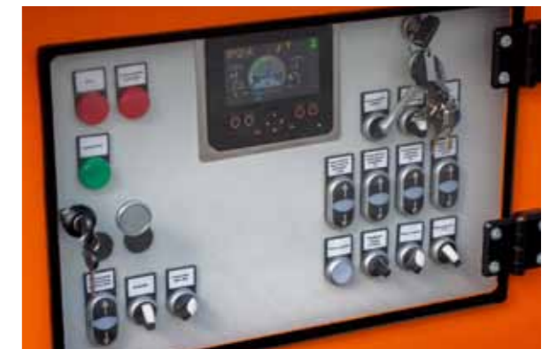
Функциональная панель управления позволяет контролировать и настраивать рабочие параметры конвейера
