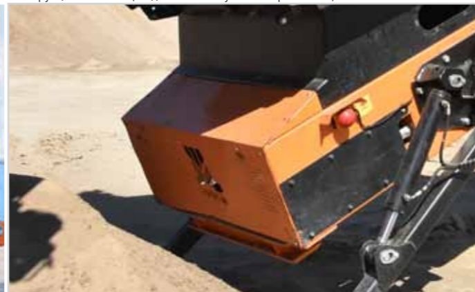
Опора на задней стороне конвейера защищает от повреждений при укладке конструкций на землю (когда не используются опорные ноги)
