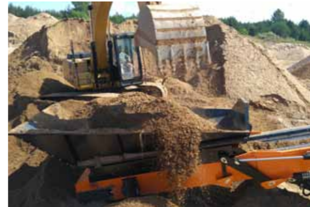
Высокая проность конвейера позволяет использовать бункер прямой загрузки 8 м 3 без дополнительных модификаций конвейера
