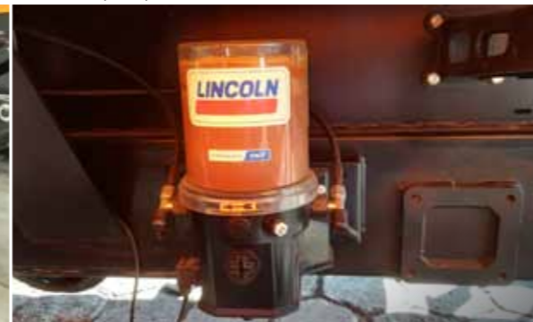
Центральная система смазки обеспечивает хорошее состояние наиболее важных элементов машины. Имеется в двух размерах.
