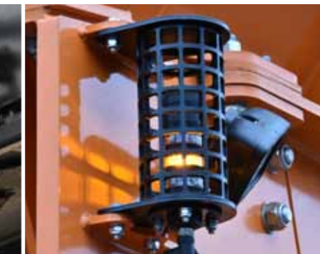
Проблесковый маячок для сигнализации режима работы.
