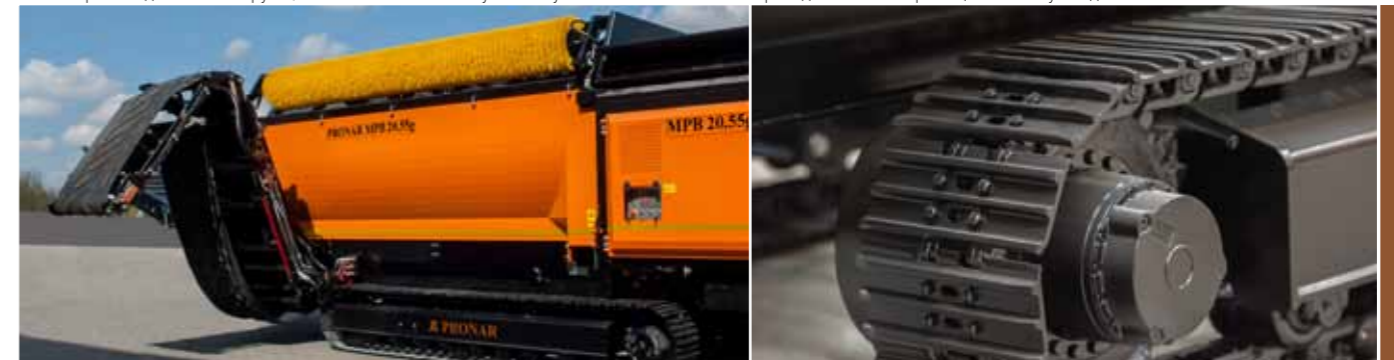
Конвейеры складываются снаружи, позволяя на более низкую высоту.
