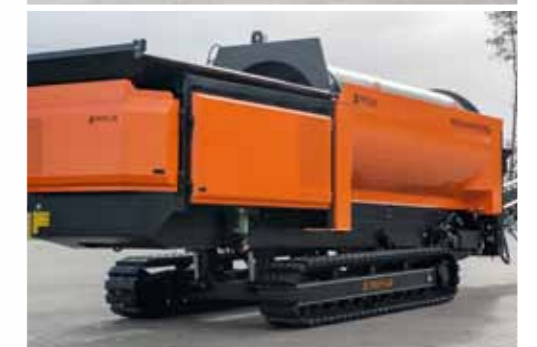
Гидравлически подъемная рама позволяет MPB 20.55gh выровнять машину для работы на склонах и увеличивает дорожный просвет для облегчения преодоления пересеченной местности.
