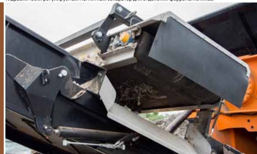
Гидравлически регулируемый магнитный сепаратор для отделения ферромагнетиков.
