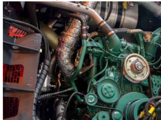
Двигатель Volvo Penta (EU Stage 4, 12, 8л; 405 кВт; 550 ЛС/1900 об/мин)
