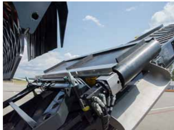
Магнитный сепаратор Применение неодимового магнита обеспечивает эффективное разделение с материала ферромагнитных элементов
