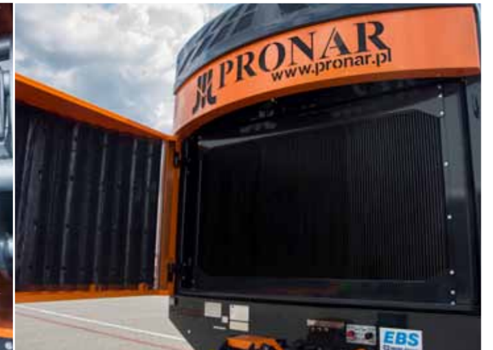
Система очистки радиаторов Позволяет держать в чистоте радиаторы двигателя и гидравлического масла. Разработан для работы в запыленной среде
