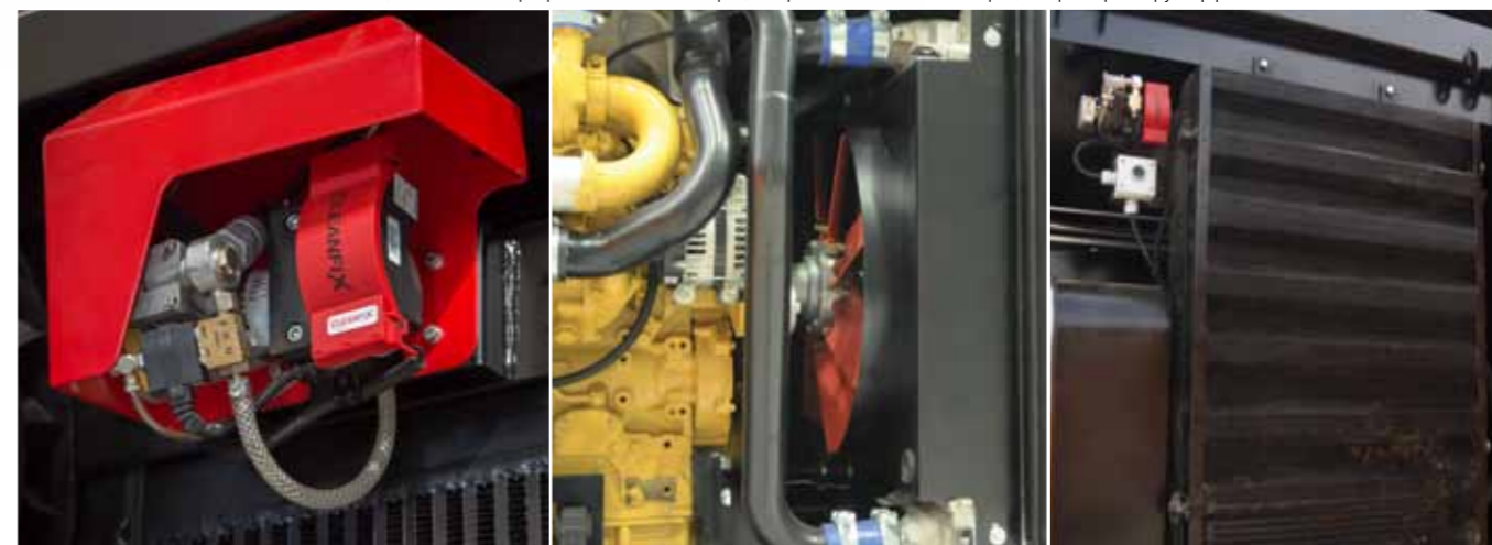
Система Cleanfix защищает двигатель от перегрева из-за забитого радиатора, циклически очищая радиатор и гарантируя эффективный теплообмен
