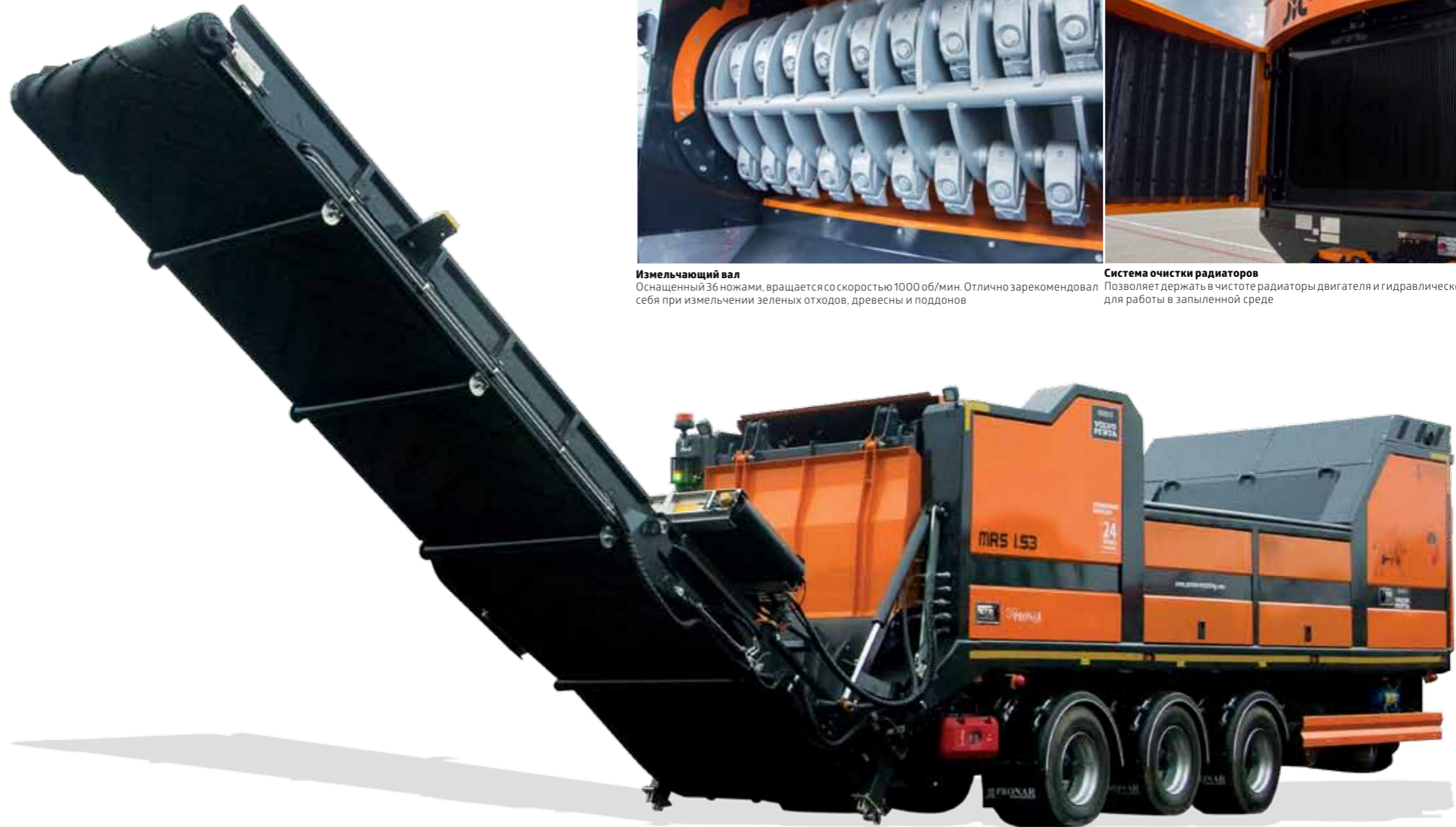
Сито Размер получаемой фракции регулируется через сменное сито, расположенные под измельчающим валом. Инновационная технология резки водой позволяет сохранить основные свойства материала во время обработки
