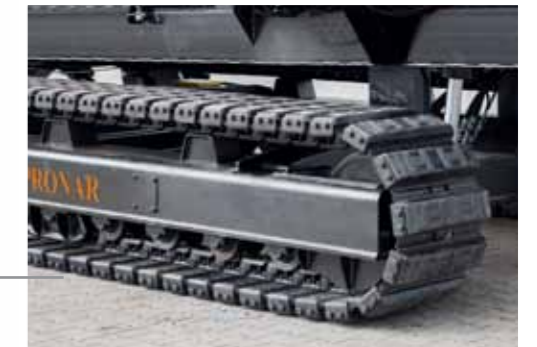
Гидравлически подъемная рама позволяет MPB 20.55gh выровнять машину для работы на склонах и увеличивает дорожный просвет для облегчения преодоления пересеченной местности.
