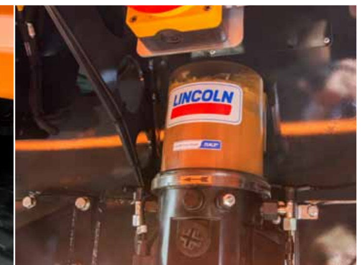
Машина может выполнять базовые маневры без необходимости участия дополнительного оборудования Центральная система смазки. Обеспечивает хорошее состояние наиболее важных элементов машины
