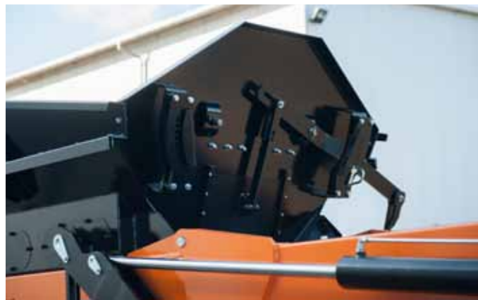
Засов хопера предотвращает слишком быструю сливанию материала из бункера
