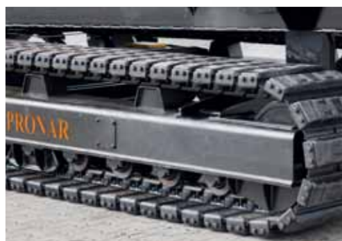
Резиновые прокладки на гусеницы защищают грунт от повреждений стальными элементами
