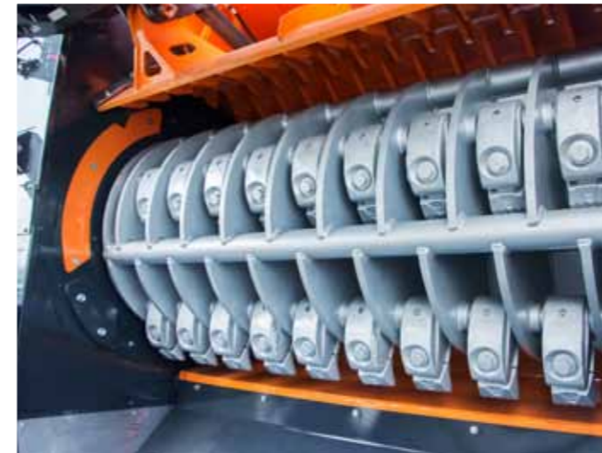
Измельчающий вал Оснащенный 36 ножами, вращается со скоростью 1000 об/мин. Отлично зарекомендовал себя при измельчении зеленых отходов, древесины и поддонов
