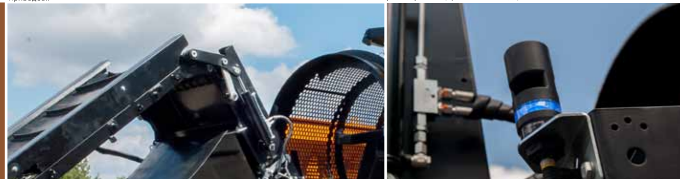
Многофункциональный проблесковый маячок указывает на режим работы (просеивание/езда).
