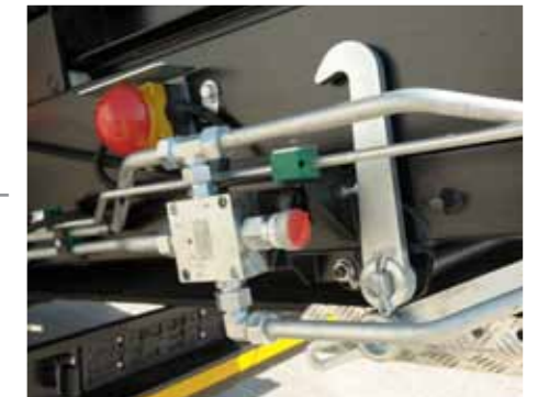
Регулирование скорости передвижения ленты подающих механизмов позволяет подобрать скорость в зависимости от типа просеиваемого материала таким образом, чтобы максимально использовать производительность мобильного барабанного просеивателя. Также позволяет насыпать большое количество материала каждой фракции без необходимости перемещения машины
