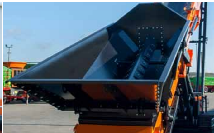
Балка с регулируемыми заслонками облекает ремень и устраняет динамические нагрузки во время загрузки
