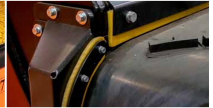
Уплотнения в бункере защищают от проникновения исходного материала в машину.
