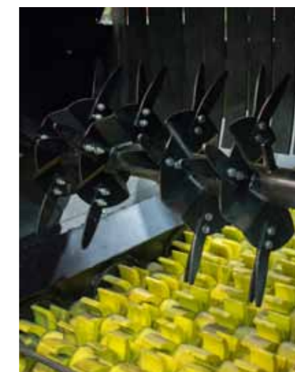
Вал распределяющий материал на дек
