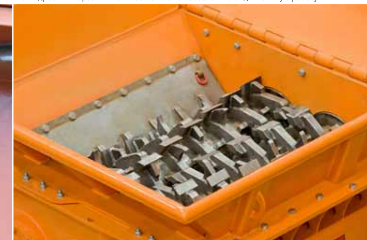
Валы дробилки с разным количеством ножей обеспечивают длительную работу.
