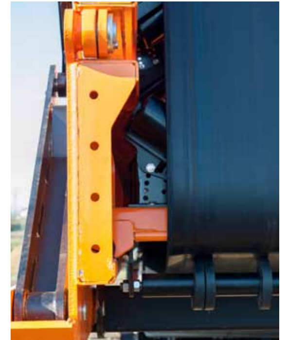
Возможность изменения угла наклона рулонов, поддерживающих ленту, для формирования потока транспортируемого материала (изменение профиля ленты)
