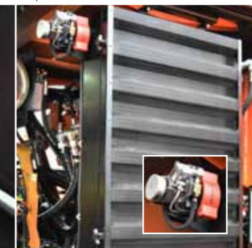
Система Cleanfix автоматически очищает радиатор двигателя и радиатор гидравлического масла.
