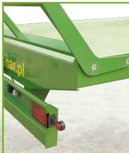
Instalación de iluminación con contornos laterales.
