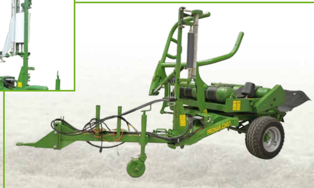
Alimentador para 500 y 750 mm de ancho de lámina plástica
