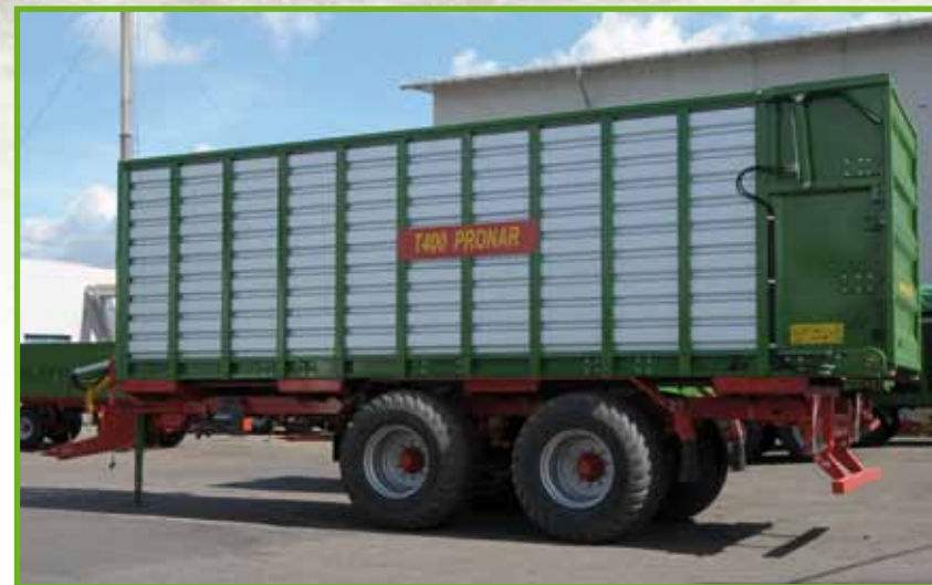
Paredes con perfiles trapezoidales revestidas de ALUZINC
