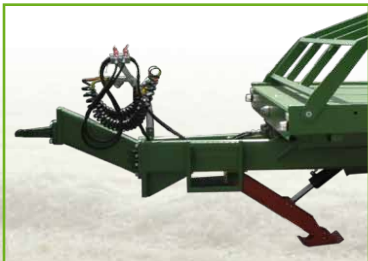
Soporte hidráulico del enganche de las cuchillas.
