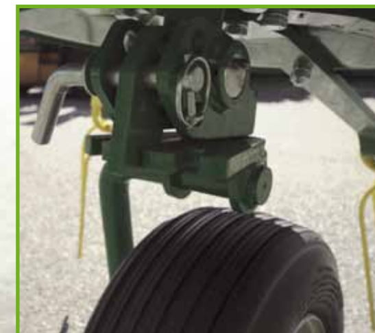
Ajuste del ángulo de expulsión - inclinación 13° 16° 19°
