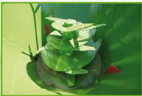
Agitador helicoidal con cuatro cuchillas
