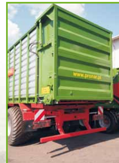
Pared trasera elevada hidráulicamente
