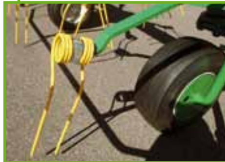
Parámetros óptimos de fijación de las púas de la henificadora - alta resistencia junto con la flexibilidad adecuada
