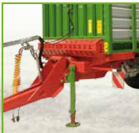
Soporte de lanza simple, mecánico y telescópico
