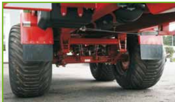
Tándem de ballestas parabólicas con sistema de dirección pasivo
