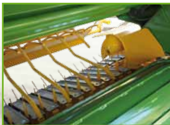
Dispositivo alimentador con púas, rastrillo y listón compensador - ajuste del espesor de la capa del material.
