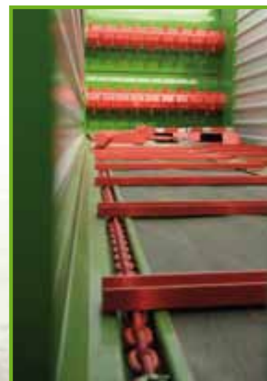
Placa solera de madera con guías metálicas de las cadenas del transportador
