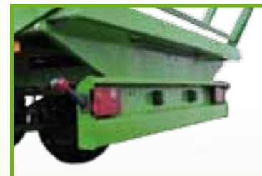
Protección de carrera trasera integrada con lámpara trasera
