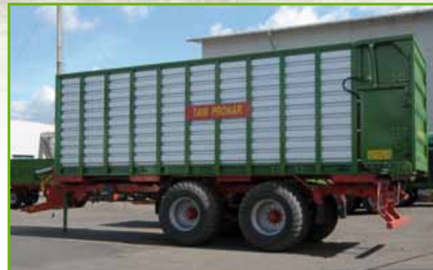
Paredes con perfiles trapezoidales revestidas de ALUZINC
