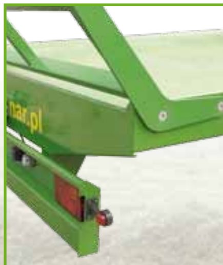
Instalación de iluminación con contornos laterales.
