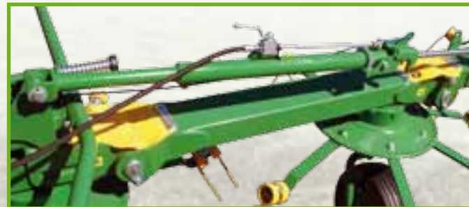
Los rotores se pliegan y despliegan de forma sincrónica - sistema hidráulico
