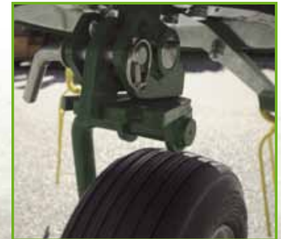
Ajuste del ángulo de expulsión - inclinación 13° 16° 19°
