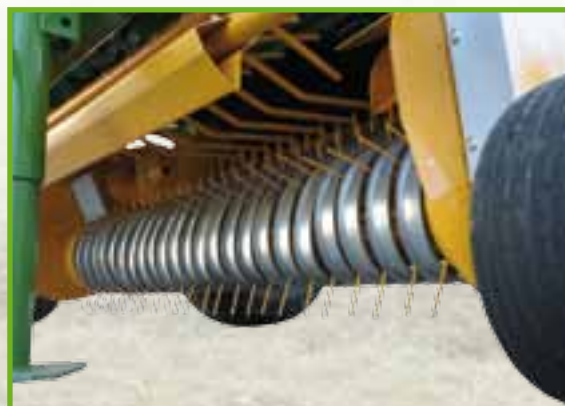
Dispositivo alimentador con púas, rastrillo y listón compensador - ajuste del espesor de la capa del material.
