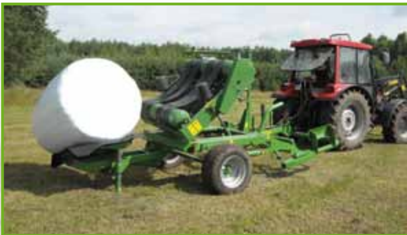
Carga frontal con acceso lateral a las pacas
