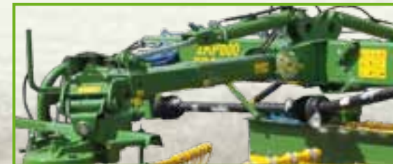
Los brazos de la rastrilladora se elevan y descienden de forma hidráulica y sincronizada
