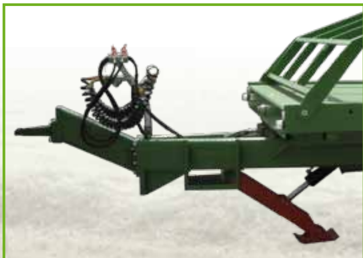
Soporte hidráulico del enganche de las cuchillas.
