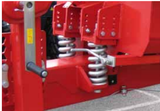
T700XL - dyszel amortyzowany sprężynami stalowymi
