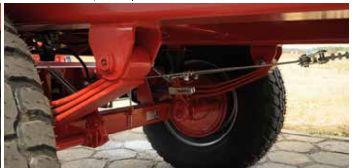
Solidne osie na resorach parabolicznych
