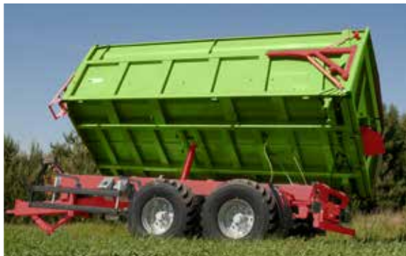
Wywrót na prawą stronę pod kątem 45° w T669/1
