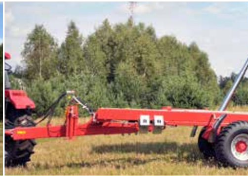
T700 - Uniwersalny dyszel sztywny amortyzowany resorem stalowym piórowym, z regulacją wysokości, do łączenia z dolnym lub górnym zaczepem ciągnika
