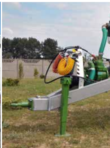
Podpora dyszla: prosta mechaniczna teleskopowa
