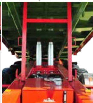
Dwa siłowniki wywrotu do tyłu - kąt 50°
