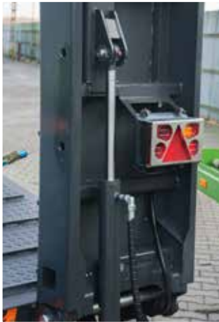
Mechaniczny system opuszczania/podnoszenia najazdów
