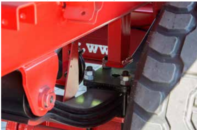
Zawieszanie na resorach parabolicznych z odbojnikiem stalowym
