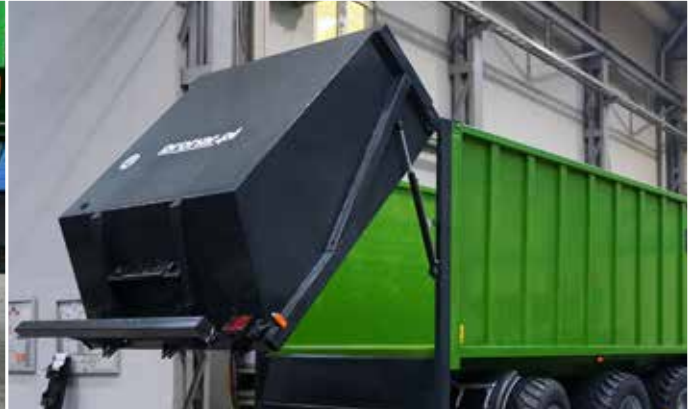
Hydraulicznie podnoszona kłapa tylna z automatycznym dociskiem i ryglowaniem
