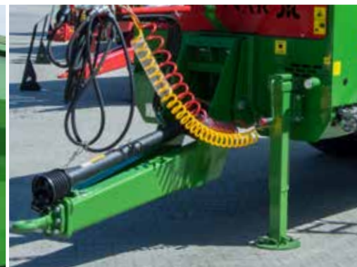
Podpora dyszla teleskopowa z jednostopniową przekładnią Instalacja hamulcowa
