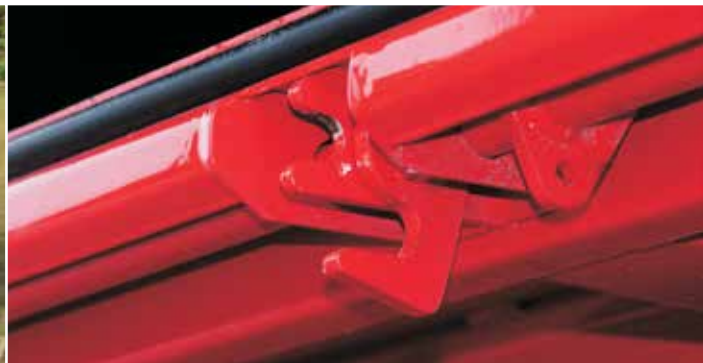
Solidny system ryglowania ścian przy podłodze
