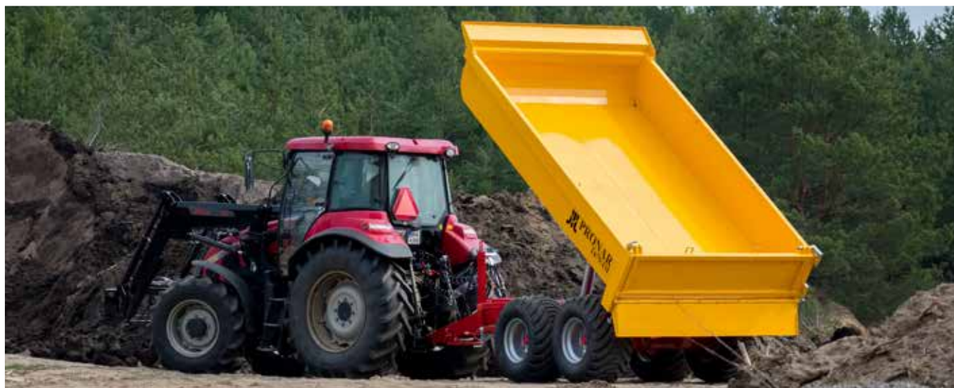
T679/4M - Skrzynia ładunkowa o budowie skorupowej (wersja budowlana); ściana boczna i połowa podłogi wykonane z jednego arkusza blachy
