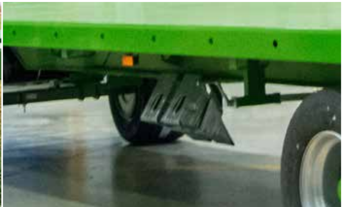
T027M - Dwa kliny do kół umieszczone w ocynkowanych kieszeniach
