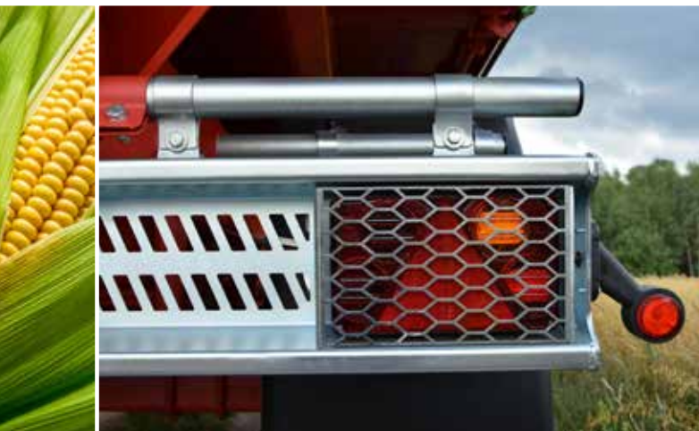
Lampy tylne LED, kratki zabezpieczające szybkodemontowalne
