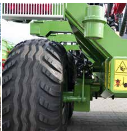
Zawieszenie tandemem z 2 wahaczami podłużnymi
