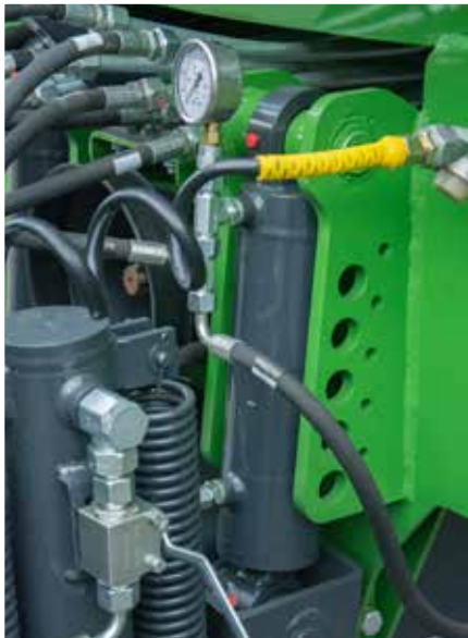
Regulowany hydraulicznie dyszeldoskonale amortyzuje maszynie
