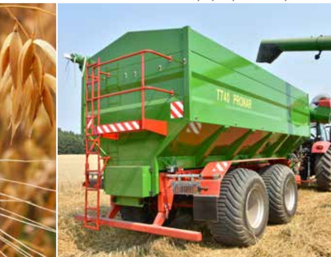
Balkon i składana drabinka na ścianie tylnej skrzyni ładunkowej
