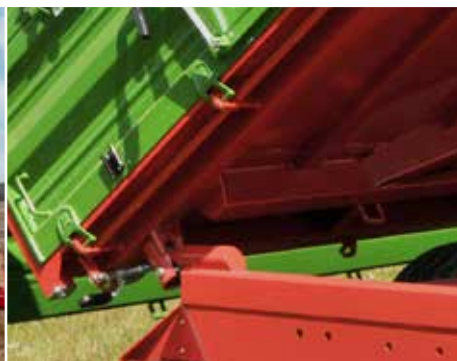
System wywrotu z przegubami kulowymi z tyłu
