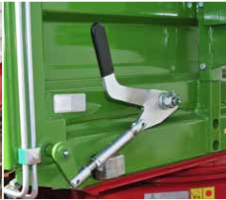
Manualne, centralne ryglowanie ściany wahadłowej
