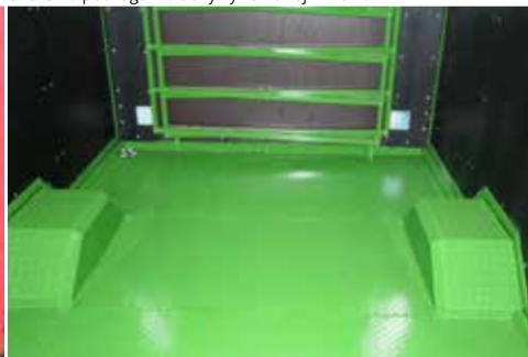
Szczelna podłoga z blachy ryflowanej w T046
