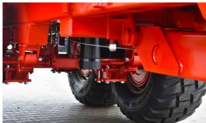
Zawieszenie tandem na resorach parabolicznych
