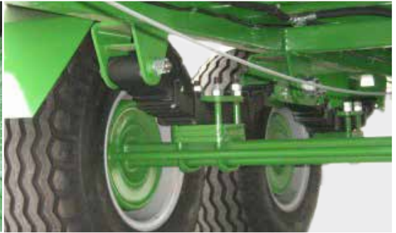
Zawieszenie tandem na resorach piórowych w T046/1
