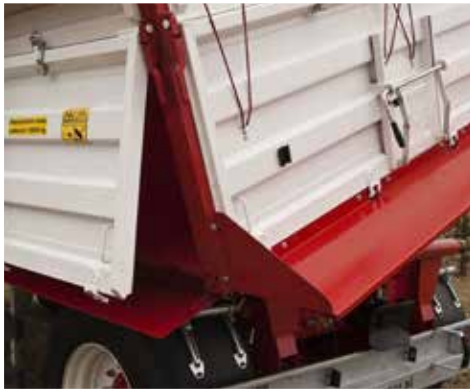
Rywna zsympowa tylna na całej szerokości przyczepy
