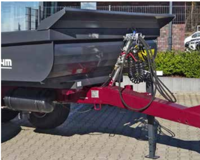
T679/4M - zaokrąglona ściana przednia skrzyni, (dostosowana do korzystania z tyżki skarpówki)
