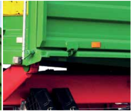
Hydrauliczny system ryglowania i podnoszenia ściany bocznej (T683H)
