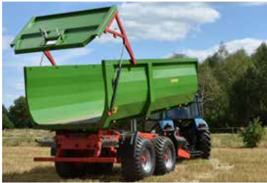
T700 - Skrzynia ładunkowa z profilowanymi ścianami z pionowym zębem wzmacniającymi po bokach, ze ścianą tylną podnoszoną hydraulicznie
