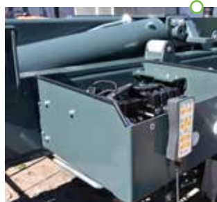
Centralny układ hydrauliczny sterowany elektrycznie
