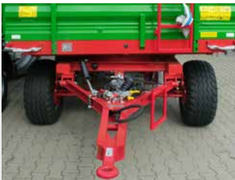
Dyszel typu Y z okiem 40mm
