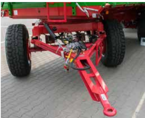
Dyszel typu Y z zaczepem sztywnym z okiem \varnothing 40\text{mm}
