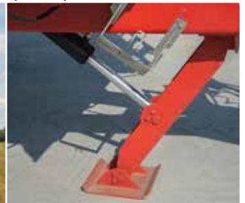
Hydrauliczna nożycowa podpora dyszla z ruchomą stopą i zabezpieczającym zamkiem hydraulicznym
