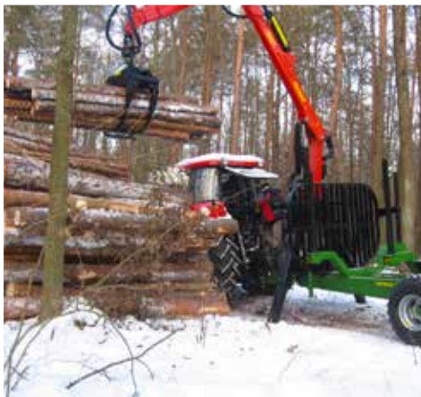
Hydrauliczne teleskopowe podpory ładowacza
