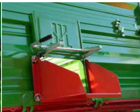
Szyber zsypany z blokadą i rynną do precyzyjnego rozładunku
