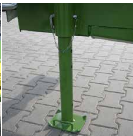
Podpora dyszla: prosta, mechaniczna
