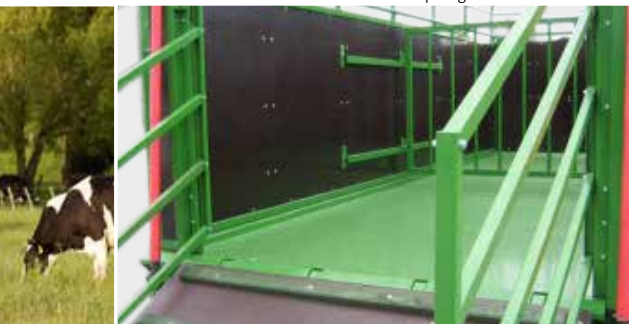
Platforma załadunkowa z barierkami oraz przegroda wewnętrzna
