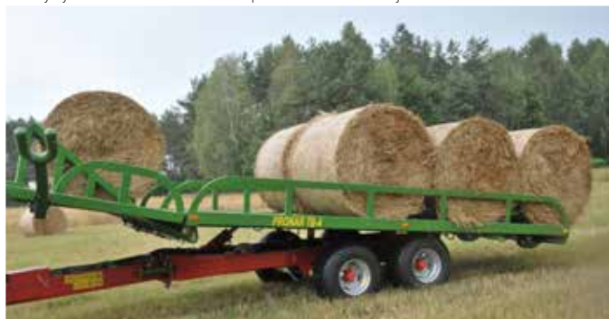
Prosty system rozmieszczenia bel na platformie ładunkowej
