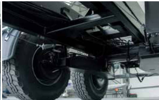
Zawieszenie tandem sztywne typu boogie
