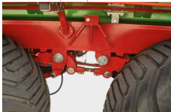
Zawieszenie na resorach parabolicznych
