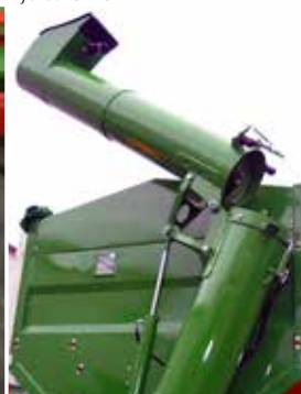
Dwusegmentowy przenośnik ślimakowy przedni rozkładany hydraulicznie
