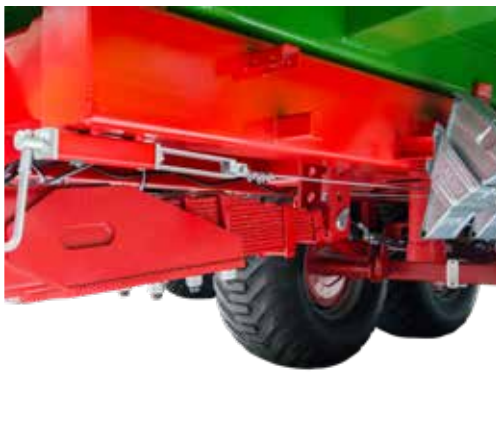
Dyszal resorowany resorem stalowym
