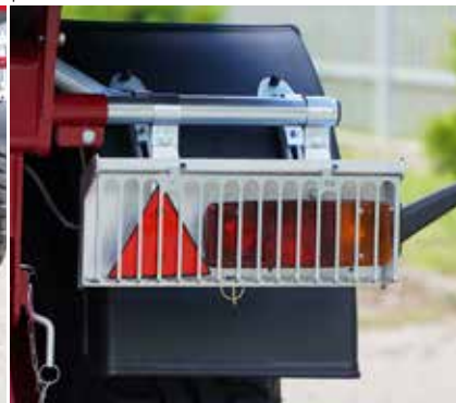
Tyłne lampy oświetleniowe z kratkami zabezpieczającymi przed uszkodzeniem
