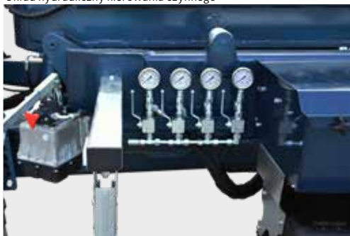
Układ hydrauliczny kierowania czynnego
