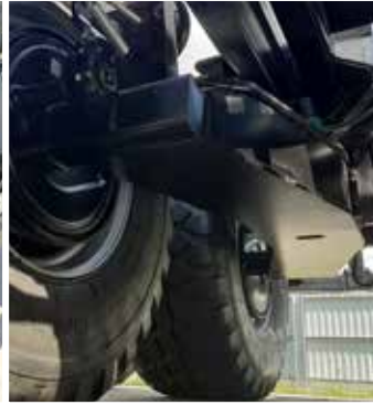
Zawieszenie tandem sztywne typu boogie
