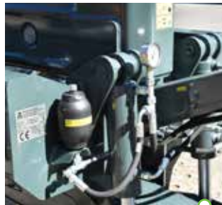
Dyszel amortyzowany hydraulicznie
