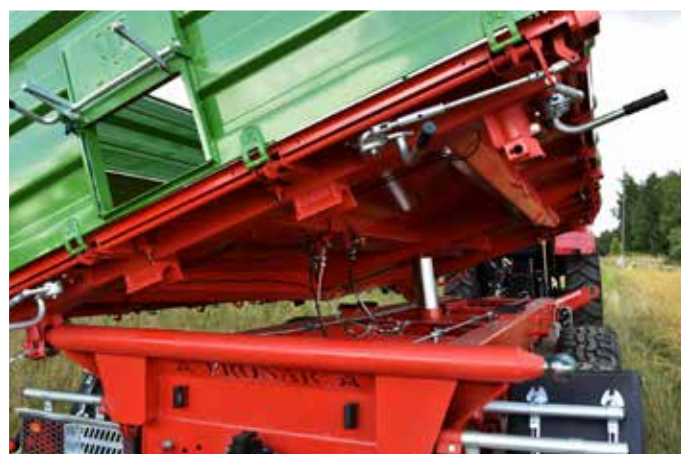
System wywrotu trzysronnego z przegubami kulowymi tylnymi amortyzowanymi
