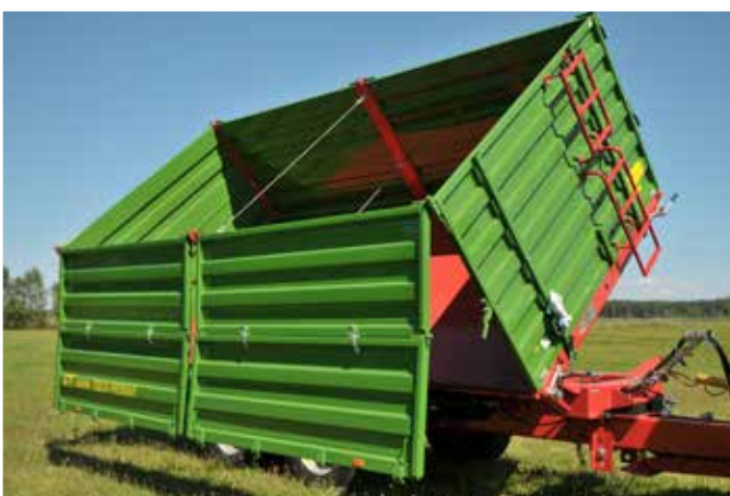
Skrzynia ładunkowa z uniwersalnym, wahadłowym, systemem otwierania ścian ze stabilnymi słupkami tylnymi i środkowymi (T683)
