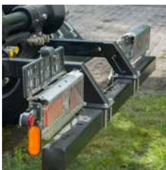
Zderzak tylny wysuwany ze światłami
