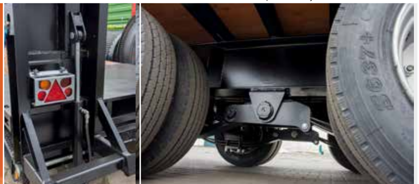
Zawieszenie tandem na resorach parabolicznych
