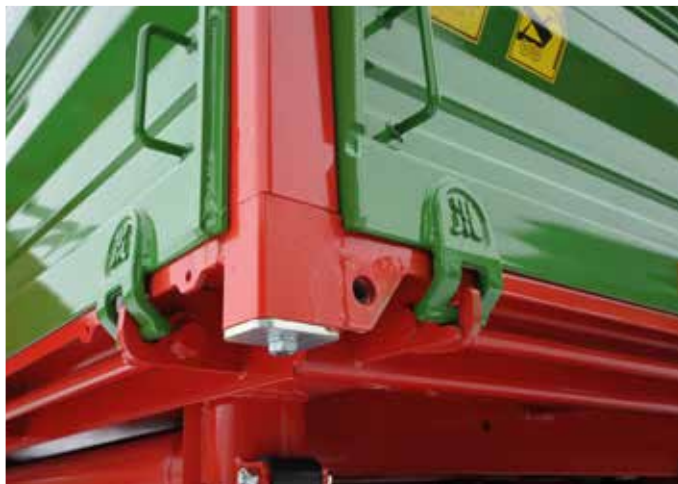
Centralne ryglowanie przy podłodze ścian bocznych i ściany tylnej
