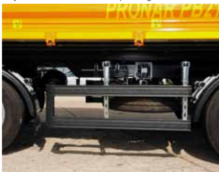
PB2100 - koło zapasowe, w wyposażeniu opcjonalnym montowane pod ramą przyczepy. Wciągarka ułatwia zdejmowanie i zakładanie koła zapasowego
