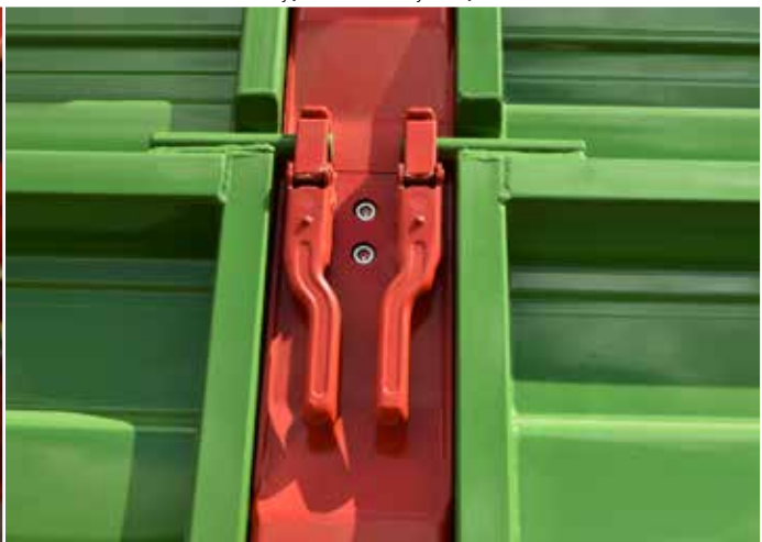
Solidne markowe zamki ścian bazujące na odkuwanych częściach
