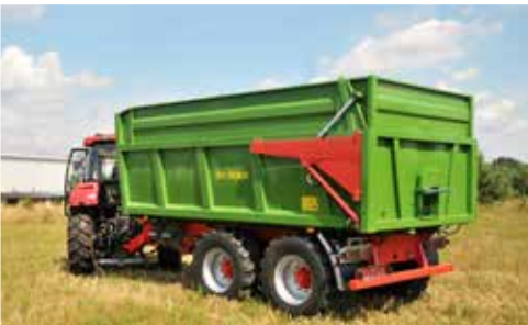
Skrzynia ładunkowa o budowie skorupowej z pionowymi żebrami wzmocniającymi (T679)
