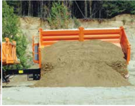
PC2100/1 - rozładunek przyczepy. Burtę boczną lewą otwierana i zamykana za pomocą siłowników hydraulicznych
