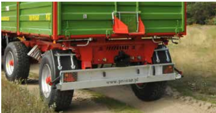
Mocna tylna trawersa oraz oświetlenie z lampami LED, z kratkami zabezpieczającym przed uszkodzeniem
