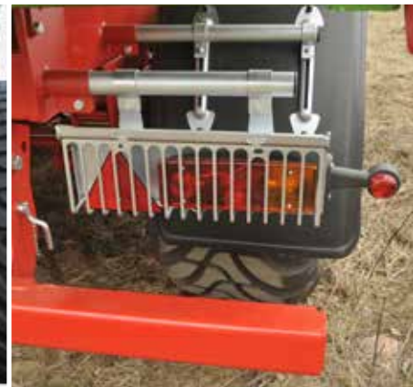
Tyłne oświetlenie przyczepy jest zabezpieczone przed uszkodzeniami specjalnymi kratkami
