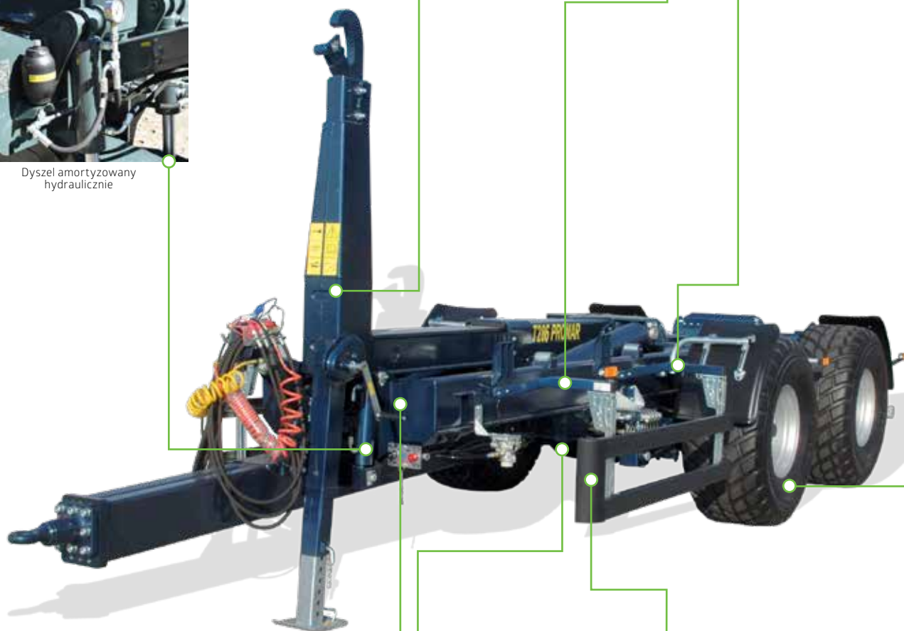
Rama podwozia o wysokiej wytrzymałości z rolkami podpierającymi kontener
