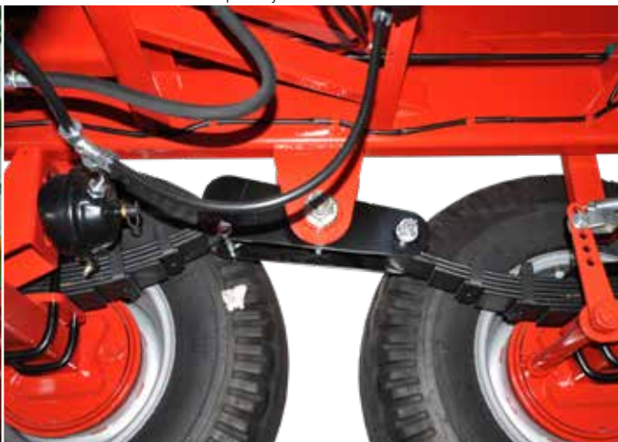
Zawieszenie tandem na 4 resorach piórowych
