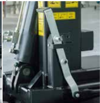
Manualne przełączenie funkcji hakowic-wywrotka
