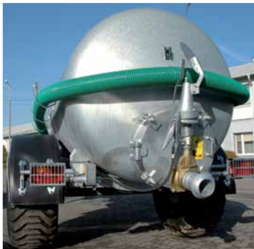
Króciec spustowy w najniższym punkcie zbiornika
