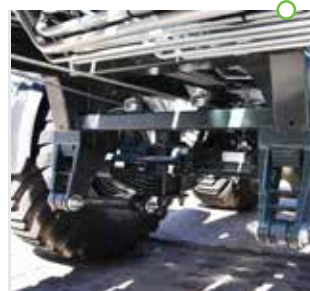
Zawieszenie tandem na resorach parabolicznych
