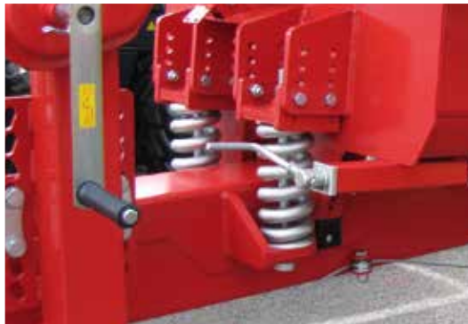
T700XL - dyszel amortyzowany sprężynami stalowymi
