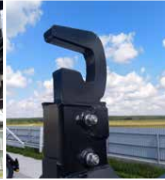
Hak bez zabezpieczenia kontenera
