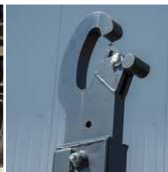
Hak z automatycznym zabezpieczeniem kontenera
