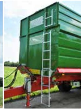
T700M - Drabinka ułatwiająca dostęp do skrzyni ładunkowej
