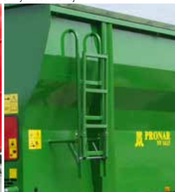
Składana drabinka ułatwiająca dostęp do skrzyni ładunkowej
