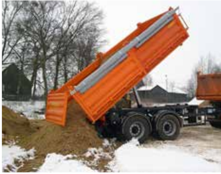
PC2100 - rozładunek przyczepy. Burtę tylną uchylną otwierana automatycznie w momencie wywrotu.
