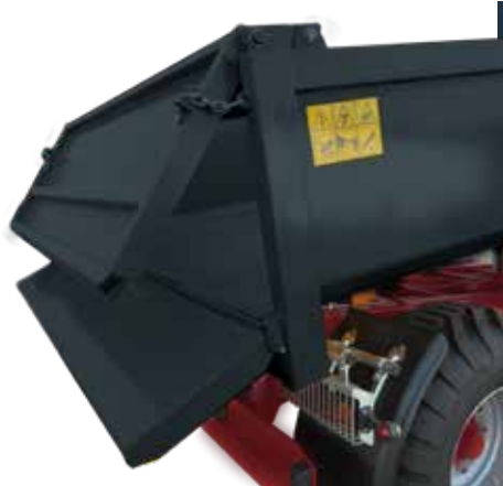
Hydrauliczna kłapa tylna o wysokości 450mm uchylana do dołu i odchylana kłapa tylna z otwieraną z prawej strony (opcja)
