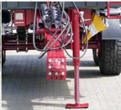
Dyszel amortyzowany resorem stalowym (T701)
