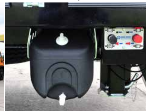
PC2200 - pneumatyczna instalacja hamulcowa z EBS Knorr-Bremse i zbiornik na wodę
