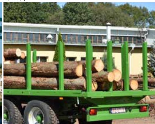
Kłonicy do transportu drewna z hakami do mocowania pasów napinających
