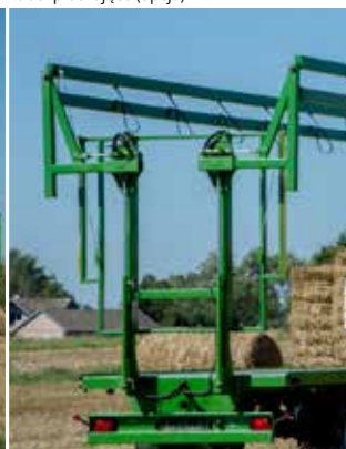
Hydraulicznie sterowane boczne ściany zabezpieczające (opcja)
