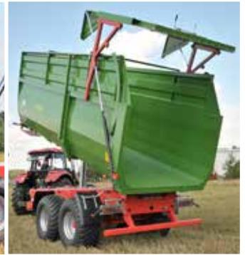
T700 - Hydraulicznie podnoszona ściana tylna z automatycznym ryglowaniem
