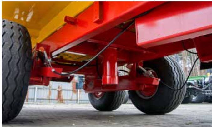
Zawieszenie tandem z wahaczami podłużnymi; z półosiami wyposażonymi w hamulce bębnowe
