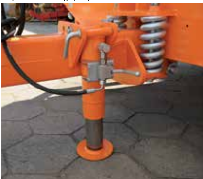
Amortyzowany mechanicznie dyszel i hydrauliczna noga podporowa
