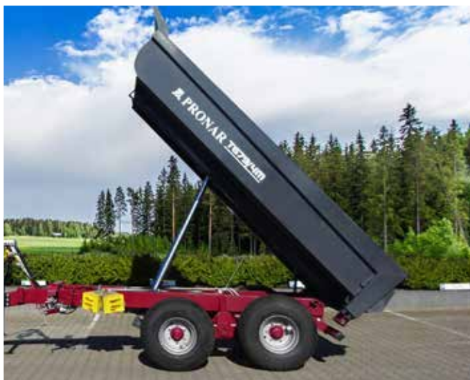
T679/4M - zaokrąglona ściana przednia skrzyni, (dostosowana do korzystania z tyżki skarpówki)
