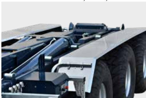
Stabilna rama z dwoma siłownikami hydraulicznymi
