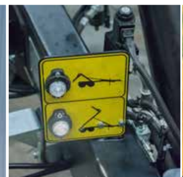
Automatyczne przełączenie funkcji hakowiec-wywrotka
