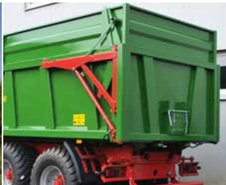
Hydrauliczny system unoszenia kłapy tylnej
