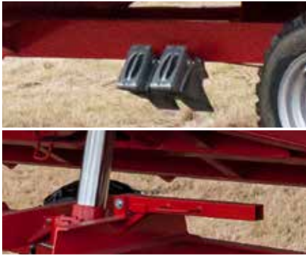
Kliny pod koła z kieszeniami w wyposażeniu standardowym i podpora serwisowa skrzyni ładunkowej
