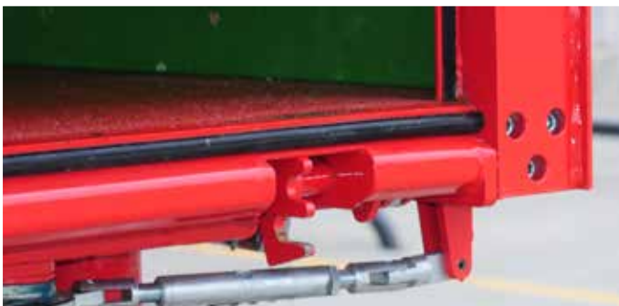
Wymienne uszczelki gumowe umieszczone na krawędzi podłogi zapewniające absolutną szczelność skrzyni (T680U)
