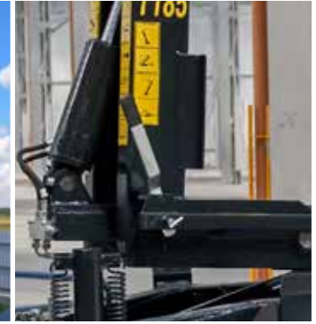
Manualne przełączenie funkcji hakowiec-wywrotka
