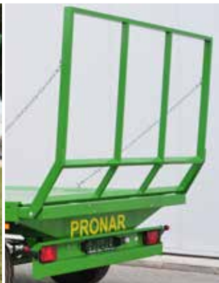
T022M - Drabinka oporowa o zaokrąglonych krawędziach
