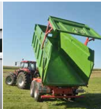
Wywrót do tyłu pod kątem 50°
