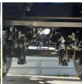
Zawieszenie typu tandem na 4 resorach parabolicznych
