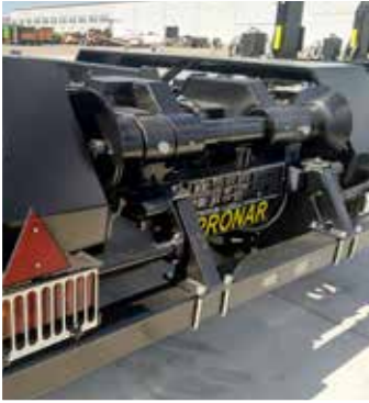
T185 - Zderzak tylny wysuwany bez światła
