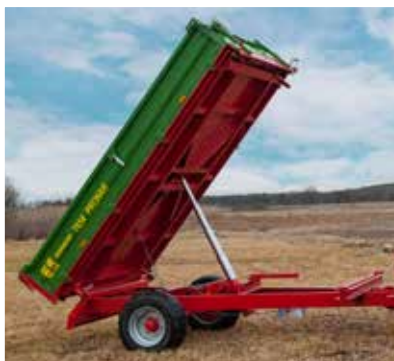
System wywrotu trzysstronny z siłownikiem teleskopowym, z zawieszem przegubowym
