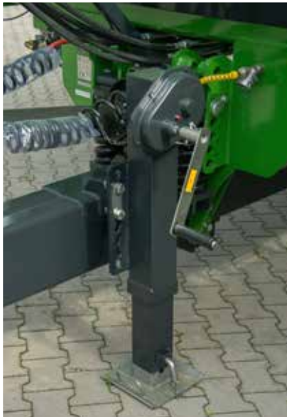
Podpora dyszla teleskopowa z dwustopniową przekładnią
