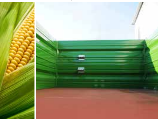
Skrzynia ładunkowa o trapezowym kształcie (skrzynia rozszerza się o 50mm w kierunku do tyłu), stopnie burtowe wewnątrz
