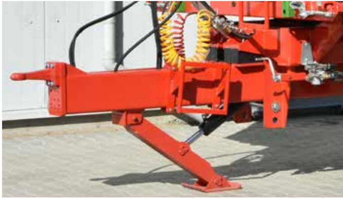
Dyszel uniwersalny sztywny do łączenia z dolnym lub górnym zaczepem ciągnika, amortyzowany resorami gumowymi
