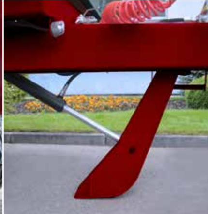
Hydrauliczna, nożycowa noga podporowa
