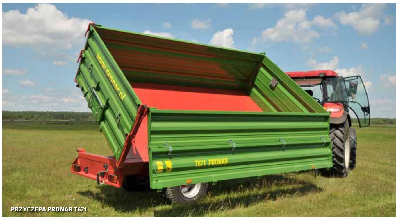
System wywrotu trzysstronny z siłownikiem teleskopowym, z zawieszem przegubowym
