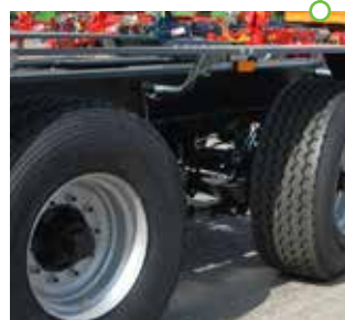
Zawieszenie z tylną osią skrętną kierowaną biernie
