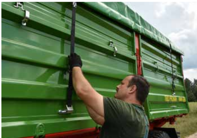
Rolowana plandeka z mocnymi napinaczami pasów
