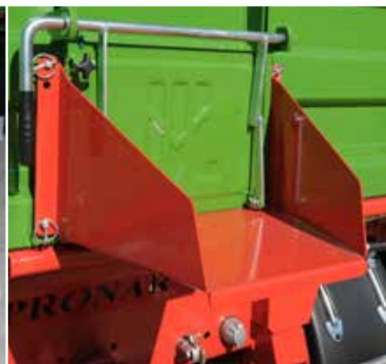
Szyber zsypowy do ziarna, z blokadą, w ścianie tylnej
