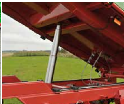
Rama podwozia spawana z prostokątnych zmkniętych profili ze stali konstrukcyjnej o wysokiej wytrzymałości
