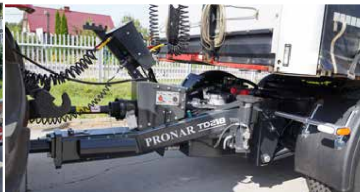
Starre Y-Deichsel mit Untenaufhängung
