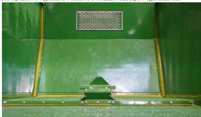
Ściana przesuwna wyposażona w elastomerowe uszczelniacze zapewniające szczelność
