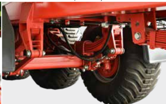
Zawieszenie tridem na resorach parabolicznych
