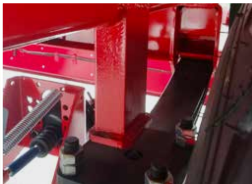
Zawieszenie na resorach parabolicznych z odbojnikiem stalowym
