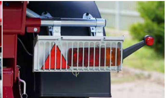
Tyłne lampy oświetleniowe z kratkami zabezpieczającymi przed uszkodzeniem
