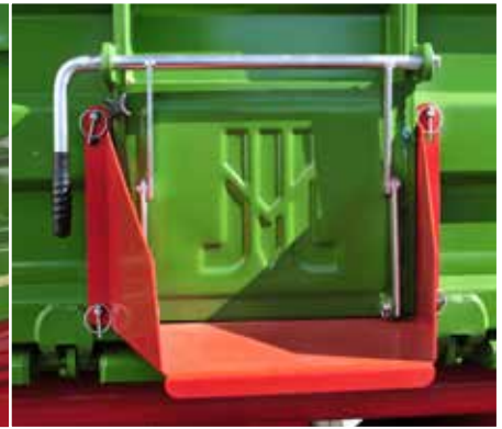
Szyber zsympowy z blokadą i rywną do precyzyjnego rozładunku
