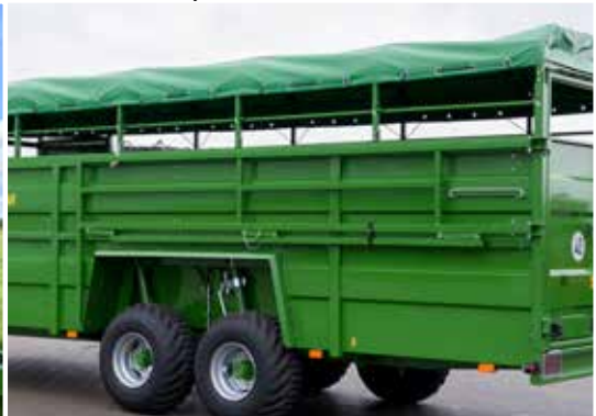
Barierki boczne ułatwiające załadunek
