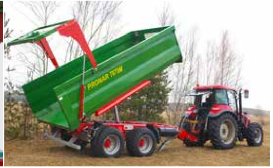
Skrzynia ładunkowa o budowie skorupowej z profilowanymi ścianami ze wzmocnionym obrzeżem górnym (T679M)
