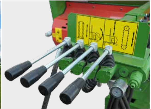
Rozrzutnik PRONAR N262/1 - hydrauliczny napęd przenośnika
