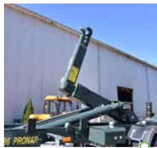
Podnoszenie realizowane dwoma siłownikami hydraulicznymi
