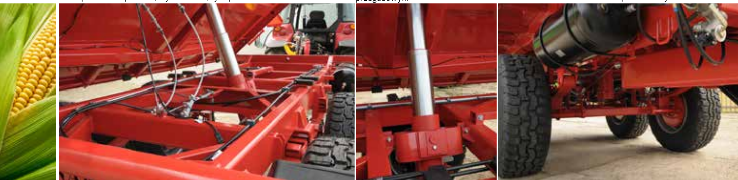
Rama podwozia z prostokątnych zamkniętych profili
