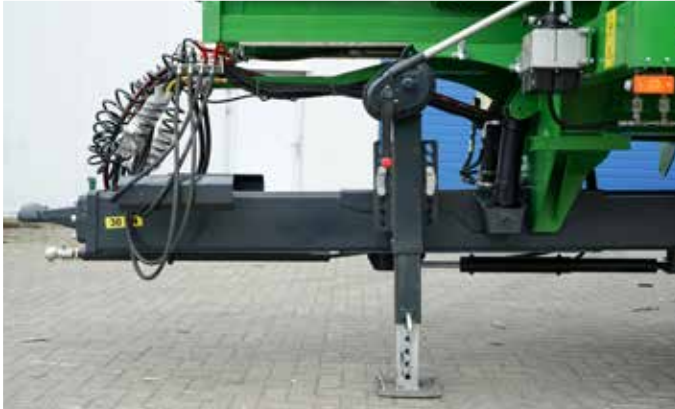
Dyszel uniwersalny sztywny amortyzowany hydraulicznie
