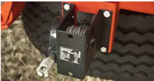
Winda koła zapasowego pod ramą podwozia
