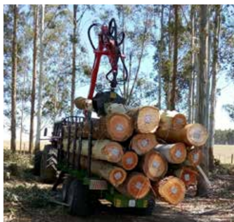
Żuraw na teleskopowych podporach z chwytakiem obrotowym
