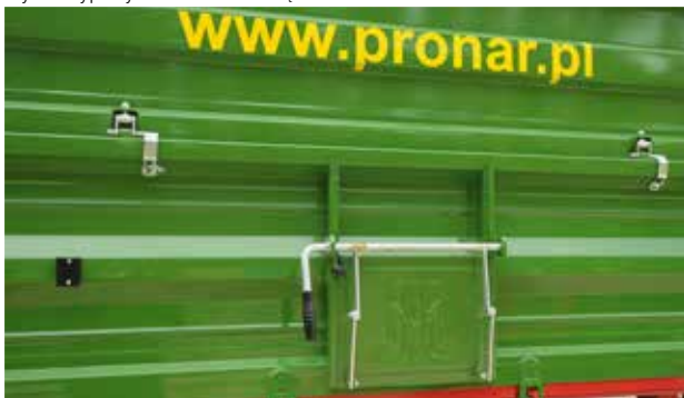
Szyber zsypany do ziarna z blokadą
