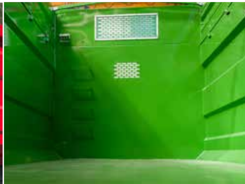
T700XL - Okno z przezroczystej PLEXI na przedniej ścianie skrzyni ładunkowej i stopnie burtowe ułatwiające dostęp do skrzyni ładunkowej
