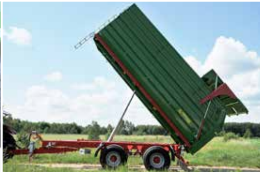
T700M - Kąt wychylenia skrzyni ładunkowej - do tyłu 55°
