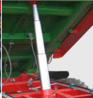
Teleskopowy siłownik wywrotu skrzyni ładunkowej z zawiesiem przegubowym
