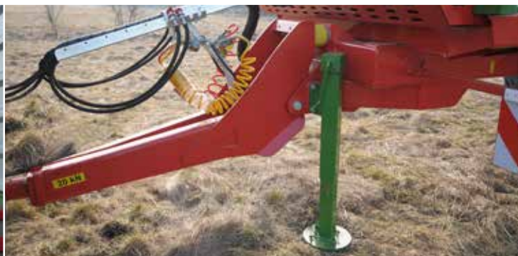
Dyszel amortyzowany elastomerami
