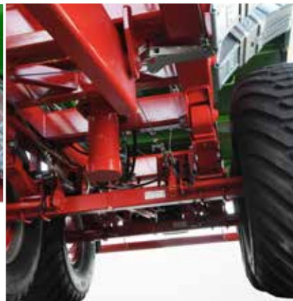
Mocne i solidne podwozie na resorach parabolicznych ułatwia transport w trudnym terenie
