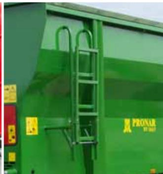
Klappbare Aufstiegsleiter erleichtert den Zugang zur Ladekiste
