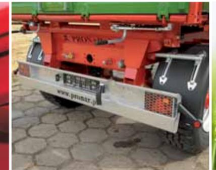
Hintere Stoßstange mit integrierten LED Rückleuchten (gesichert durch abnehmbare Gitter).
