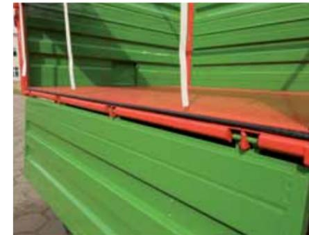
Austauschbare Gummidichtungen am Bodenrand (T680U).
