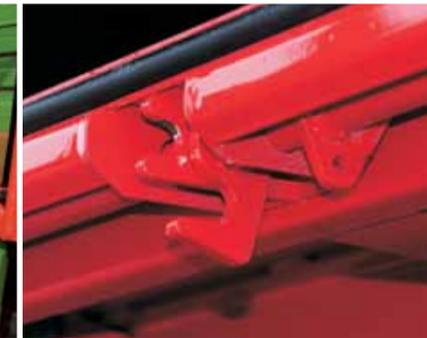
Solide Bordwandverriegelung im Bodenbereich.
