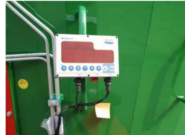
Wiegesystem mit einer LCD Anzeige für Monitoring des Beladungsgewichts
