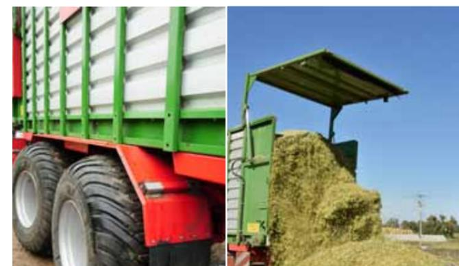
Hydraulisch gesteuerte Heckwand
