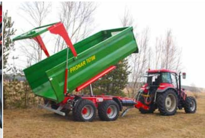
Muldenkiste mit profilierten Seitenwänden als Verstärkung im oberen Bereich (T679M).
