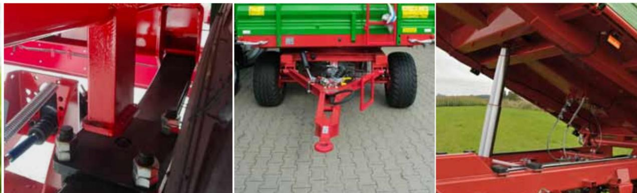
Parabelfederung mit Anschlagpuffer
