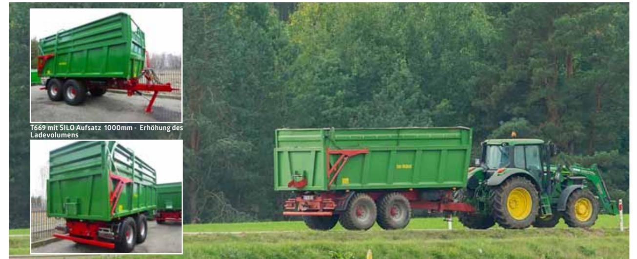
T669 mit SILO Aufsatz 1000mm - Erhöhung des Ladevolumens
