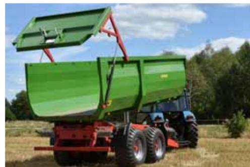
**T700** - Das Fahrgestell aus rechteckigen, geschlossenen Profilen, verschweißt, mit hydraulischer Heckklappe.
