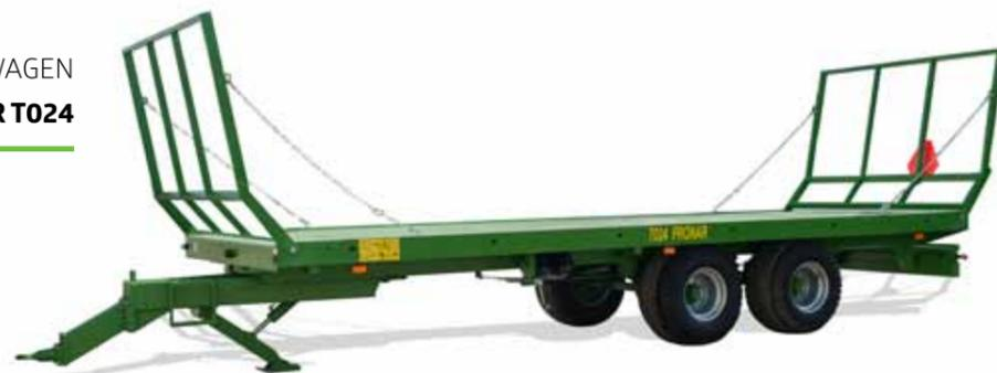
Die seitliche Profilaufkantung sichert die Ladung und verhindert Beschädigungen der in Folie eingewickelten Ballen
