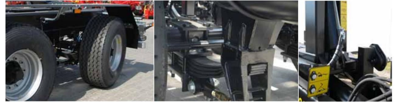
Tandemfahrwerk mit Parabelfederung (4 Federn)
