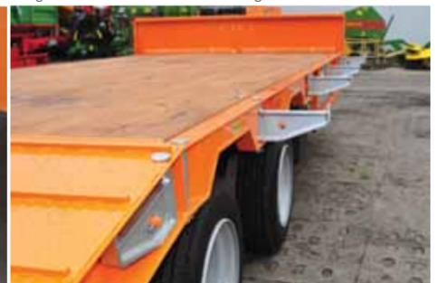
Laderampen mechanisch gesteuert (als Option hydraulische Steuerung).
