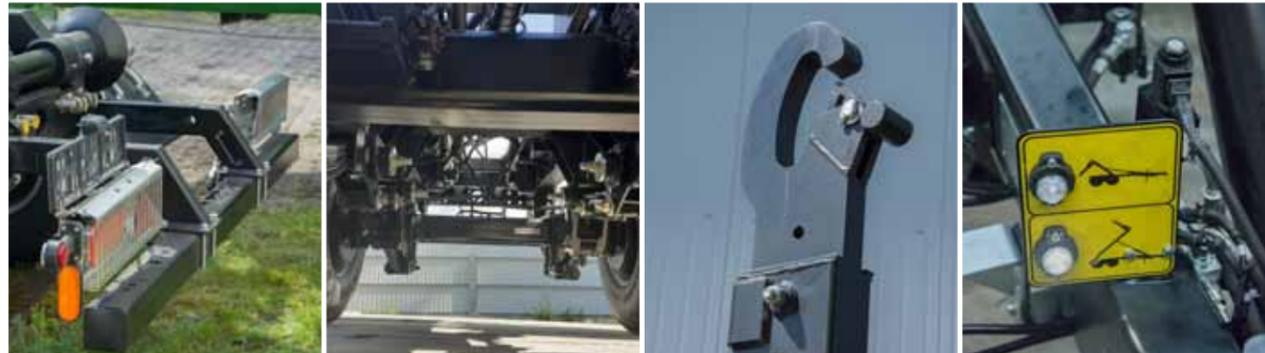
Hinterer Unterfahrschutz ohne Beleuchtung    Tandemfahrwerk mit Parabelfederung (4 Federn)    Haken mit automatischer Containerverriegelung    Automatische Umschaltung von Funktionen Abrollkipper
