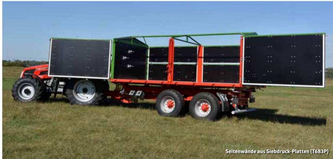
Seitenwände aus Siebdruck-Platten (T683P)
