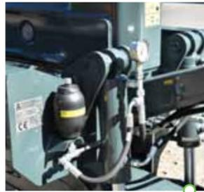
Hydraulisch gefederte Deichsel, höhenverstellbar mit Hydro-Akku macht die Fahrt komfortabel
