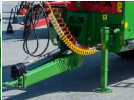
Teleskopstützfuß mit Getriebe
