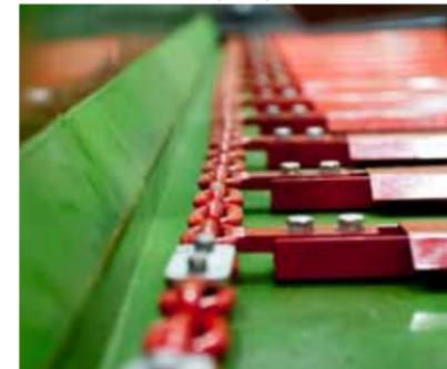
Förderanlage mit hydr. Antrieb und stufenloser Regulierung
