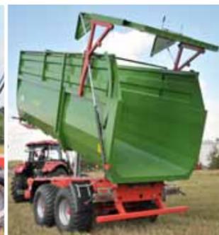
**T700** - Hydraulische Heckklappe mit automatischer Verriegelung
