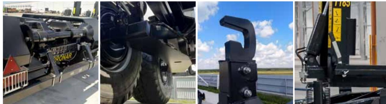
T185 - Hinterer Unterfahrschutz ohne Beleuchtung    Starre Tandem-Boogie-Aufhängung    Haken ohne Container-Sicherung    Manuelle Umschaltung des Abrollkippers
