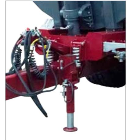
Hydraulischer Stützfuß mit Kugelventil
