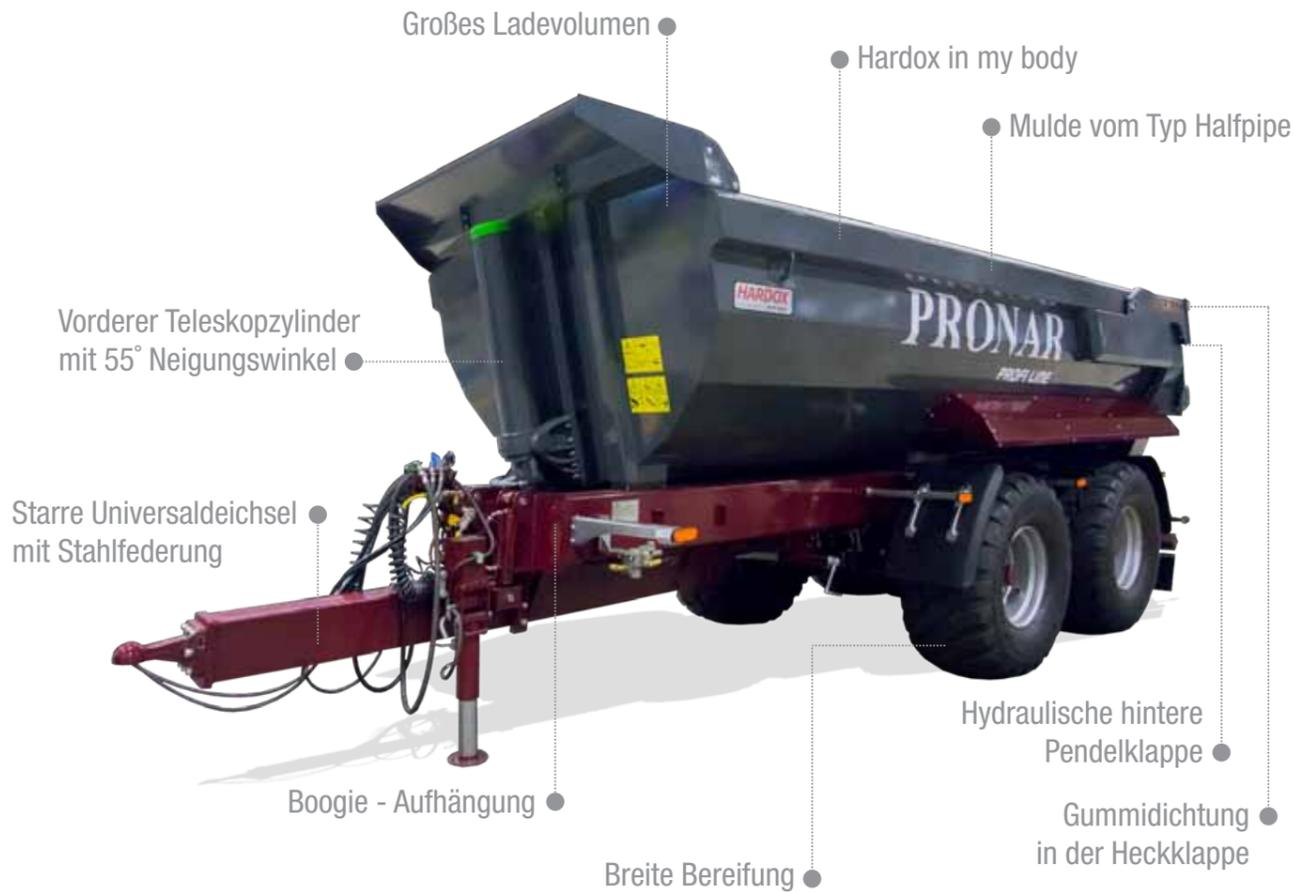
Boogie - Fahrwerk mit 4 Parabelfedern (24 Tonnen), Achsenabstand 1600mm, Trommelbremse 406x140mm
