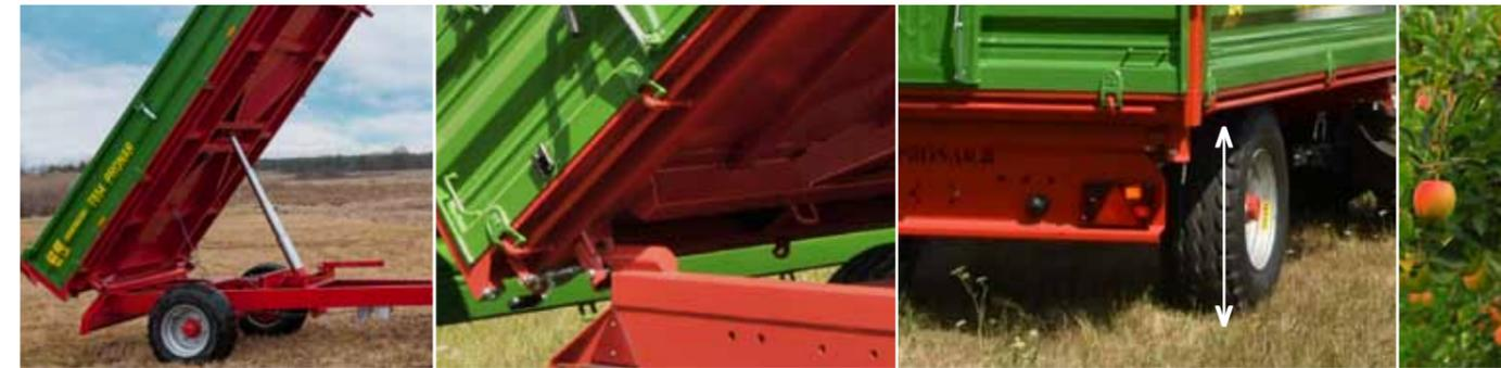
Dreiseitiges Kippsystem mit einem Hydraulikzylinder
