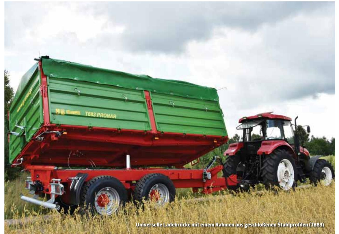
Universelle Ladebrücke mit einem Rahmen aus geschlossenen Stahlprofilen (T683)
