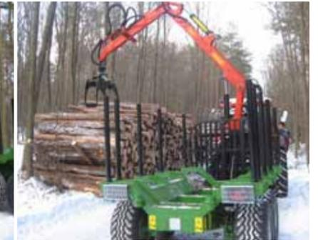
Hydraulisch ausziehbarer Rahmen mit Rungen.
