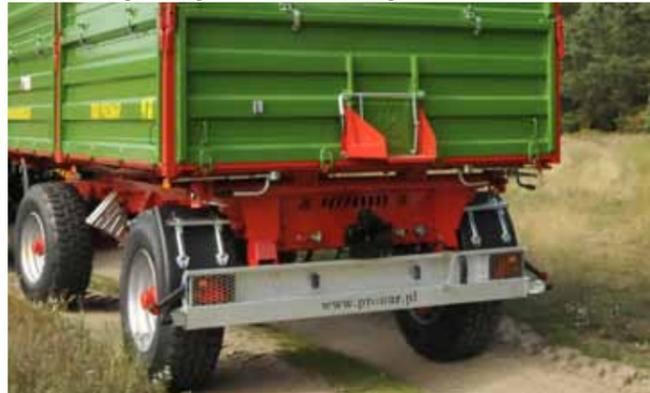
Solide Bordwandverriegelung im Bodenbereich
