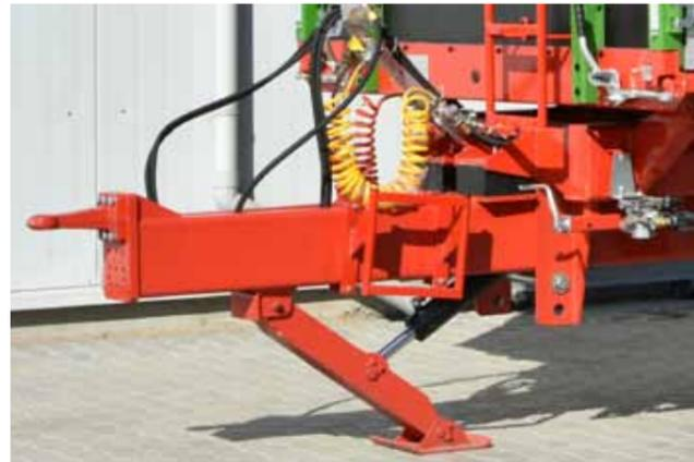
Gefederte Deichsel mit Gummidämpfern zur Unten- und Obenanhangung
