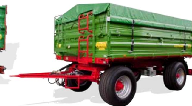
2 - Leiter Druckluftbremse + manueller Bremskraftregler
