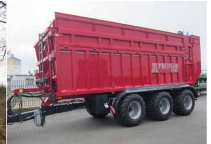
**PRONAR T900** ausgestattet mit einer hydraulisch gesteuerten linken Wand, Aufsätze 500 mm und hydraulisch klappbare Stützdeichsel. Sonderlackierung nach Kundenwunsch
