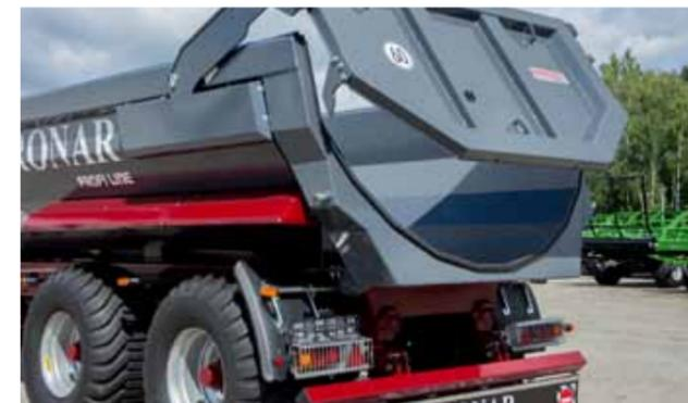
Das Fahrgestell aus rechteckigen, geschlossenen Profilen, verschweißt
