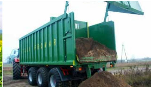
**Pronar T902** Tandem-Fahrwerk mit Parabelfederung, hintere Nachlaufachse
