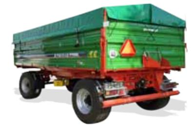
Ladefläche für den Transport von Europaletten mit verstärkter Bodenplatte
