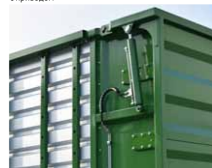
Задний борт открывающийся с помощью гидравлики. Кузов предусмотрен для дополнительной установки дозирующих вальцов с приводом
