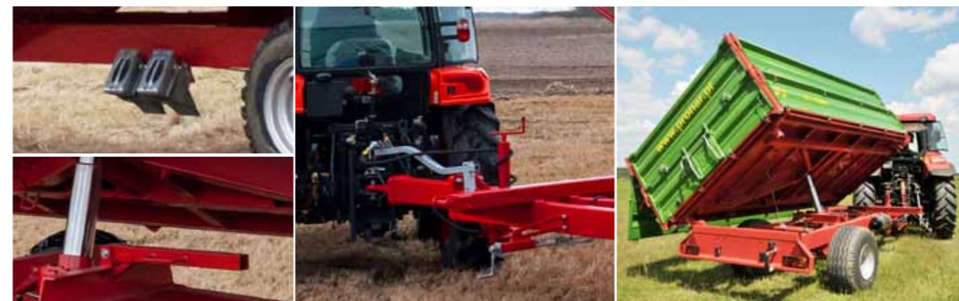
Клинья под колеса с карманами и сервисная опора кузова - в стандартной комплектации. Сервисная опора кузова T654/2 - Неподвижное дышло для соединения с верхним прицепным устройством трактора Система трехсторонней разгрузки с задними шаровыми шарнирами с оптимальным расстоянием
