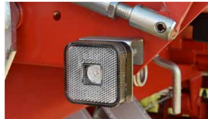
Установка освещения с фарами LED
