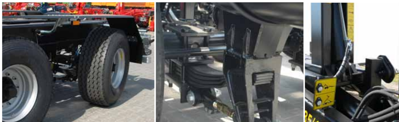
Подвеска типа тандем на 4 параболических рессорах
