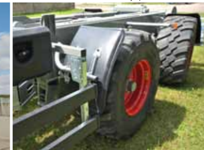
T285/1 - Задняя ось пассивно управляемая
