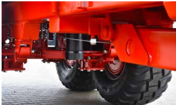
Подвеска тандем на параболических рессорах
