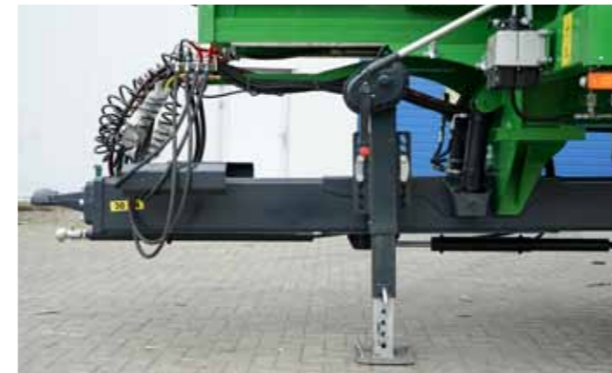
Гидравлически амортизированное жесткое универсальное дышло
