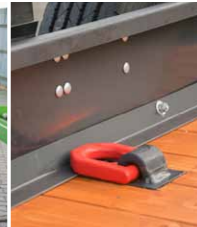
Буксировочная проушина для крепления груза
