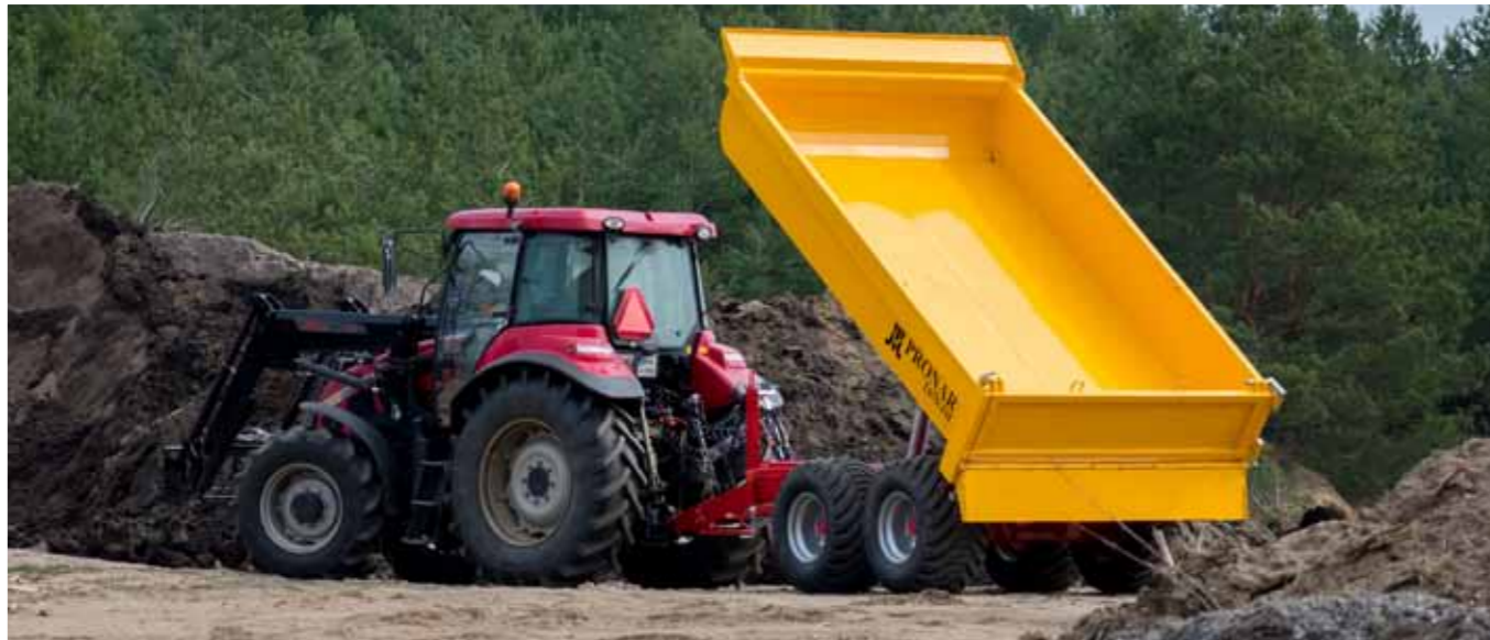
T679/4M - Монолитный кузов (строительная версия); боковой борт и половина пола сделаны из одного листа металла
