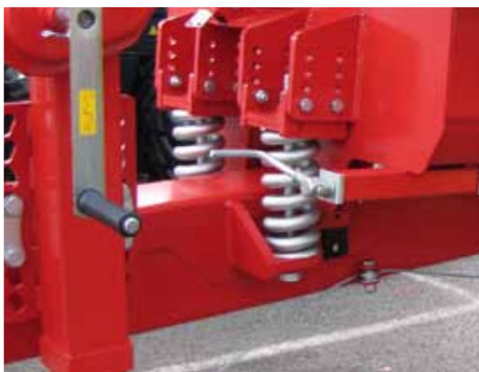
T700XL - Дышло амортизированное стальными пружинами
