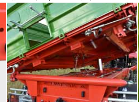
Трёхсторонняя система опрокидывания кузова с задними амортизированными шарнирами.
