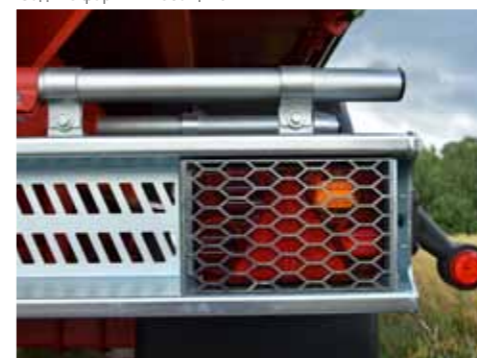
Задние фары LED с защитой
