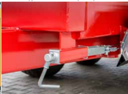
Стойачный ручной механический тормоз с кривошипом
