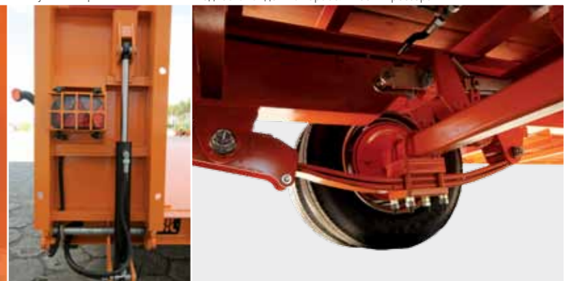
Подвеска тандем на параболических рессорах
