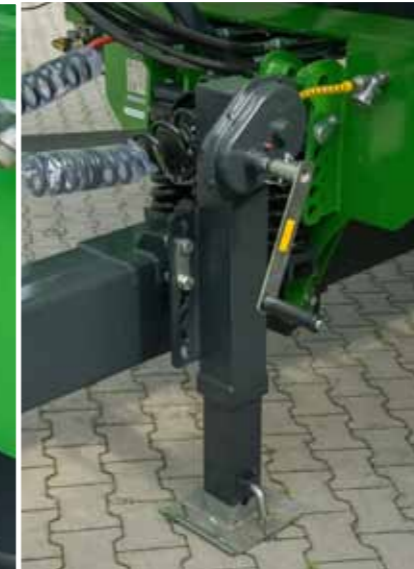
N262/2 - телескопическая опора дышла с двухступенчатой передачей
