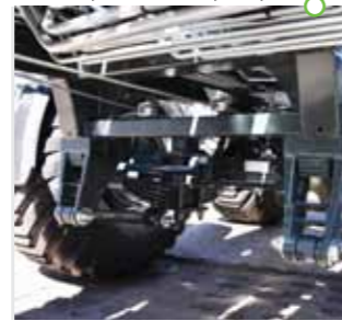
Подвеска тандем на параболических рессорах
