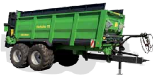
Разбрасыватель PRONAR N262/1 – Адаптер AH20 с двумя тарелками для равномерного и широкого разброса
