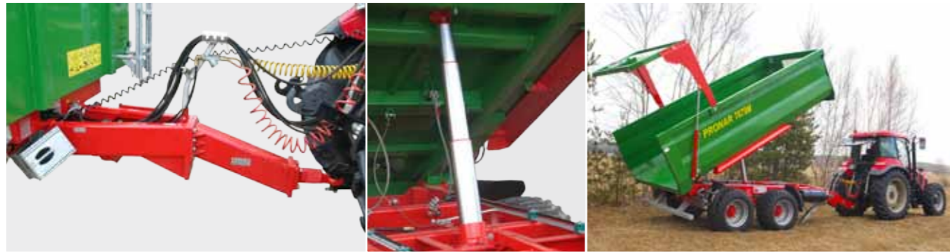
Универсальное дышло приспособлено к соединению с нижним или верхним сцепным устройством трактора
