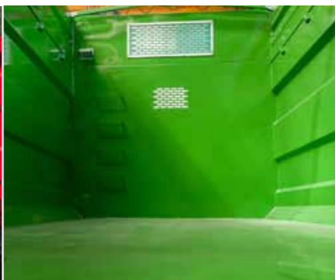
T700XL - Прозрачное окно PLEXI на передней стенке кузова и ступени облегчающие доступ к кузову
