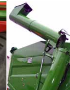
Двухсегментный передний выгрузочный шнек гидравлически раскладываемый
