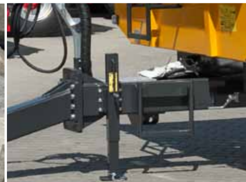
Механическая опора дышла, с угловой передачей, с неподвижной стопой
