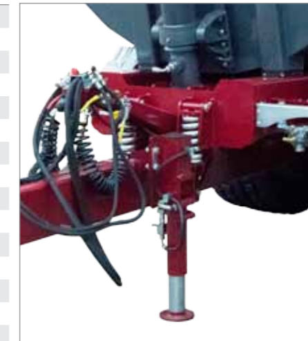
Гидравлическая опора дышла складываемая с блокировочным шаровым клапаном
