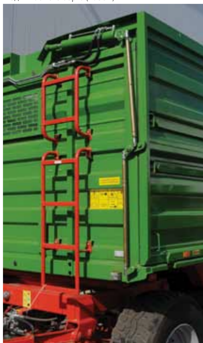
Гидравлическое управление и блокировка бокового поднимаемого борта (Т680H)
