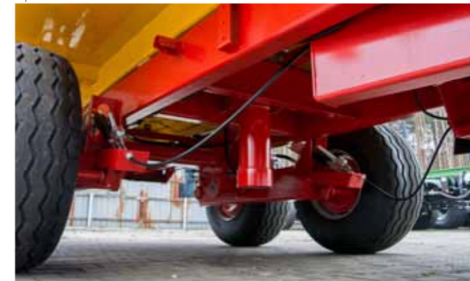
Подвеска тандем с продольными балансиром, с полуосями оснащенными барабанными тормозами
