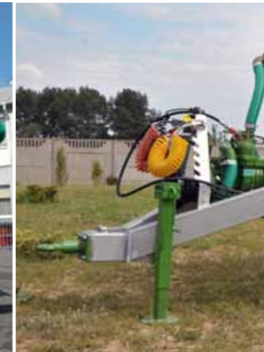
Опорта дышла: простая механическая телескопическая
