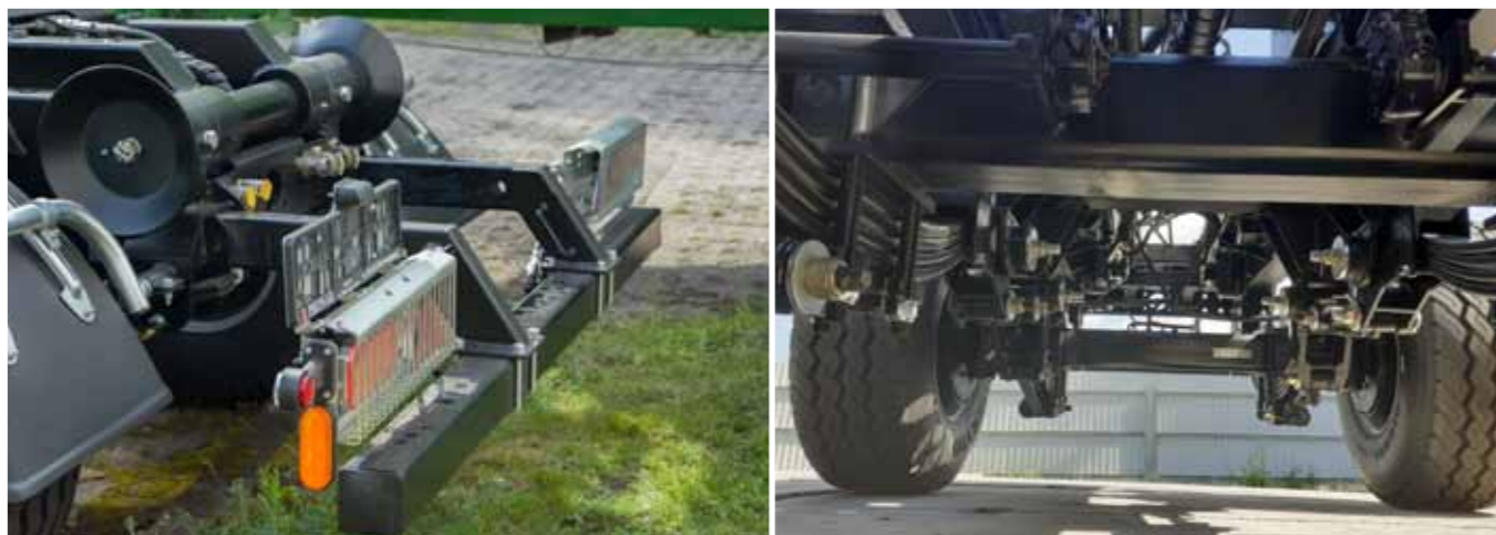
Выдвижной задний бампер с освещением
