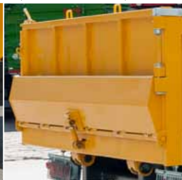
Задний борт высотой 325 мм, открываемый гидравлическим способом, открывается вниз
