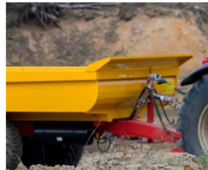
T679/4M - закругленная передняя стенка кузова (приспособлена для вывращения груза с помощью ковша)
