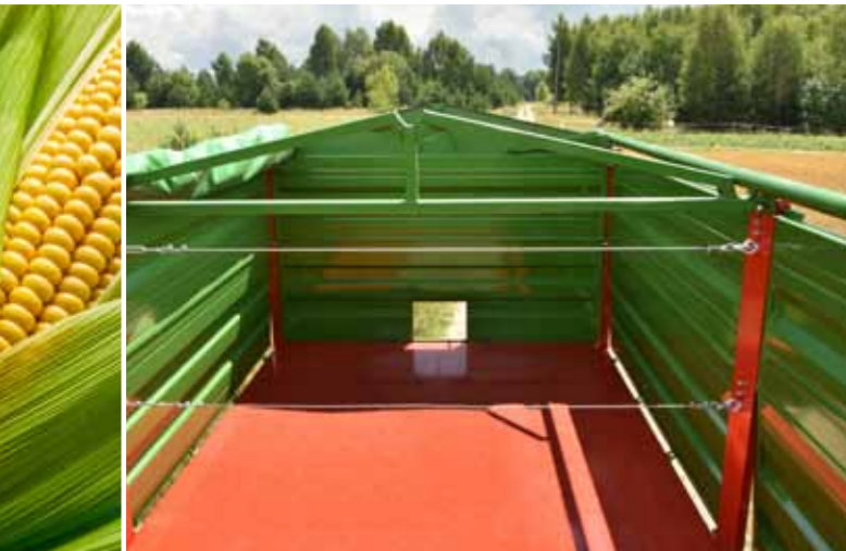
Грузовая платформа предназначена для перевозки европоддонов, с центральными стойками защищенными с помощью тросов
