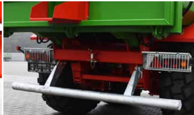
Tylnie lampy oświetleniowe z kratkami zabezpieczającymi przed uszkodzeniem
