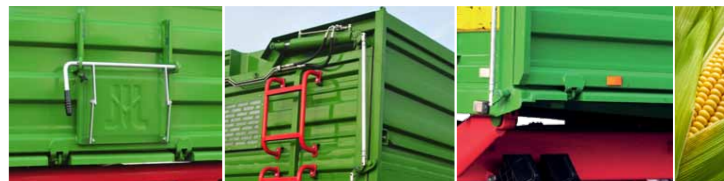
Ссыпной люк для зерна с задвижкой в задней стенке.
