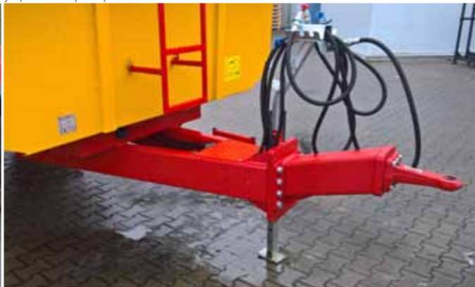
Универсальное, жесткое дышло для агрегации с нижним либо верхним тягово-сцепным устройством трактора
