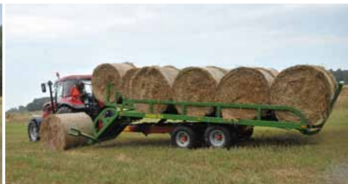
Широкая грузовая платформа (2250мм) позволяет загружать рулоны в два ряда.
