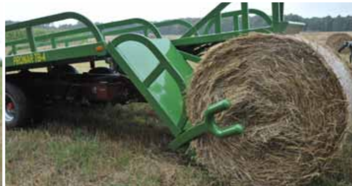
Широкая грузовая платформа (2250мм) позволяет загружать рулоны в два ряда.
