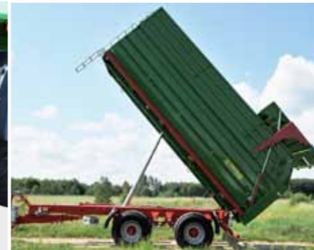
T700M - Разгрузка назад под углом 50 градусов 55°
