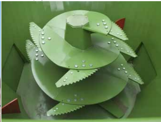
Шнек с девятью режущими ножами
