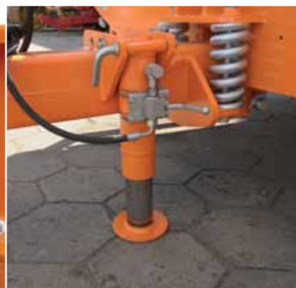
Амортизированное механическое дышло и гидравлическая опорная нога
