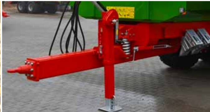
T669XL - Универсальное амортизированное стальными пружинами дышло, с регулировкой по высоте, для соединения с нижним или верхним тягово-сцепным устройством трактора (без омологации)
