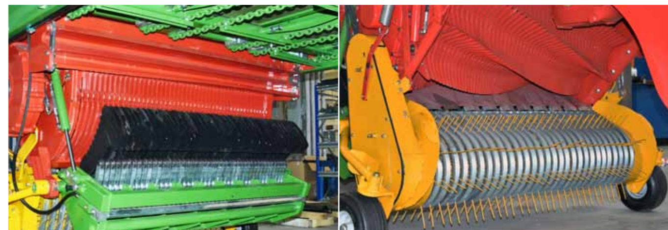
Подборщик кулачковый с восемью рядами подбирающих пальцев с роликом и копирующими поворотными колесами
