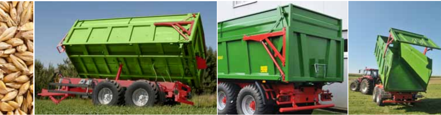
Прицеп Т669/1 с правосторонней разгрузкой с углом 45°
