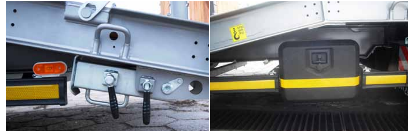
Опорные стопы задние – вращающиеся с механическим управлением,
