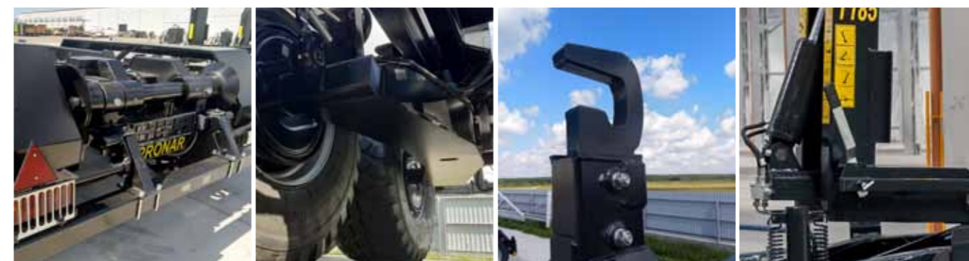
T185 - Выдвижной задний бампер без фонарей Жесткая тандемная подвеска типа "boogie" Крюк без защиты контейнера Ручное переключение с крюкового погрузчика на самосвал
