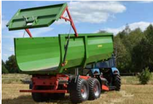
T700 - Монолитный кузов с профилированными стенами, с укрепляющими вертикальными ребрами жесткости, с гидравлически поднимаемым задним бортом
