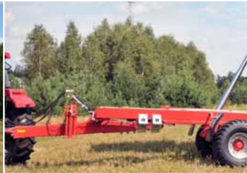
T700 - Жесткое, амортизированное рессорой, универсальное дышло с возможностью регулировки по высоте, для соединения с нижним или верхним тягово-сцепным устройством трактора
