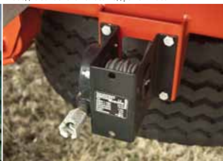
Блокировка портального борта защищающая от непроизвольного закрытия и повреждения
