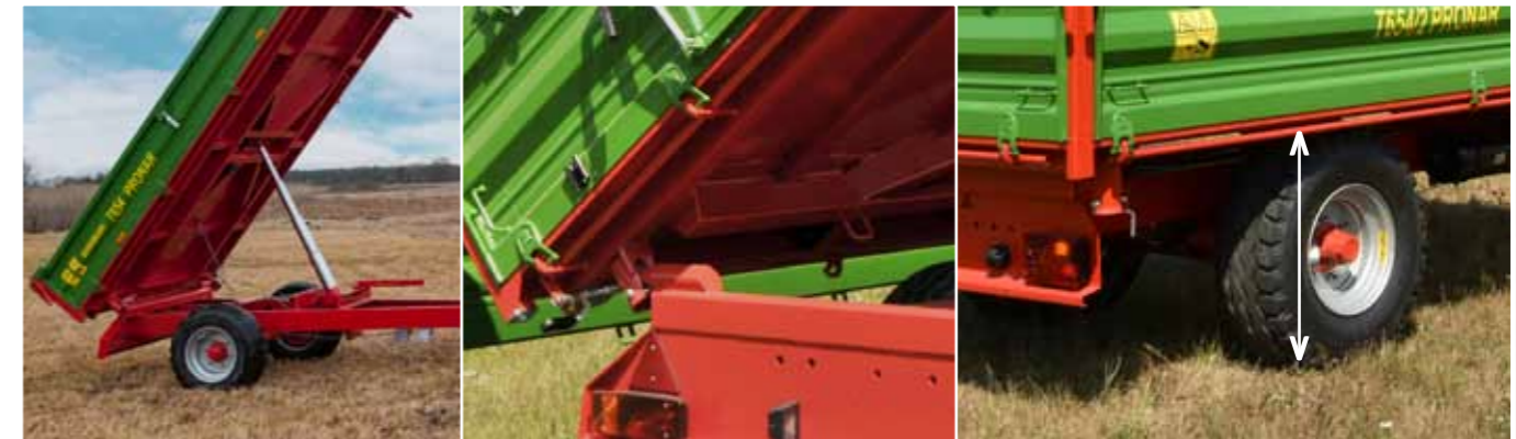
Система трехсторонней разгрузки телескопическим цилиндром, с шарнирным устройством Система разгрузки с шаровыми шарнирами сзади
