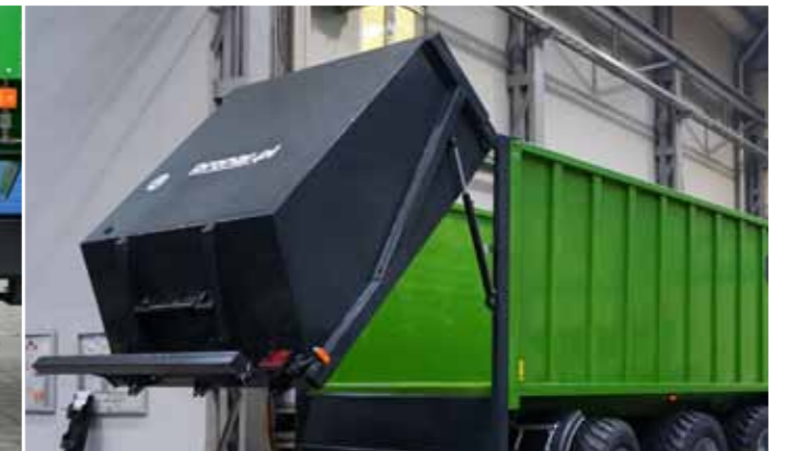
Гидравлически поднимаемый задний борт с автоматическим дожимом и запирающим
