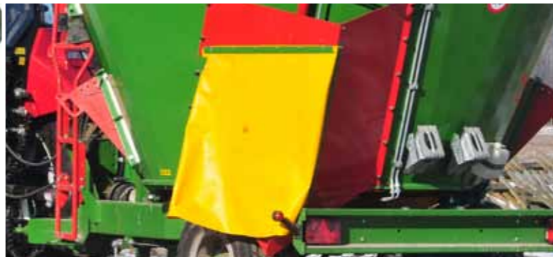
VMP-10S – выгрузочные окна с лотками и защитой
