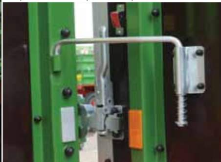
Блокировка портального борта защищающая от непроизвольного закрытия и повреждения
