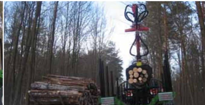
Задняя рама со стойками выдвигается гидравлически
