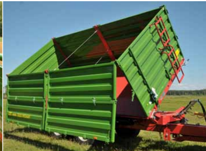
Грузовая платформа с универсальной системой открытия бортов с задними и центральными стойками (Т683, Т683U)
