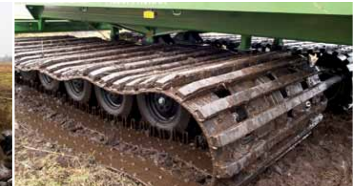
Гусеницы со сменными резиновыми накладками.
