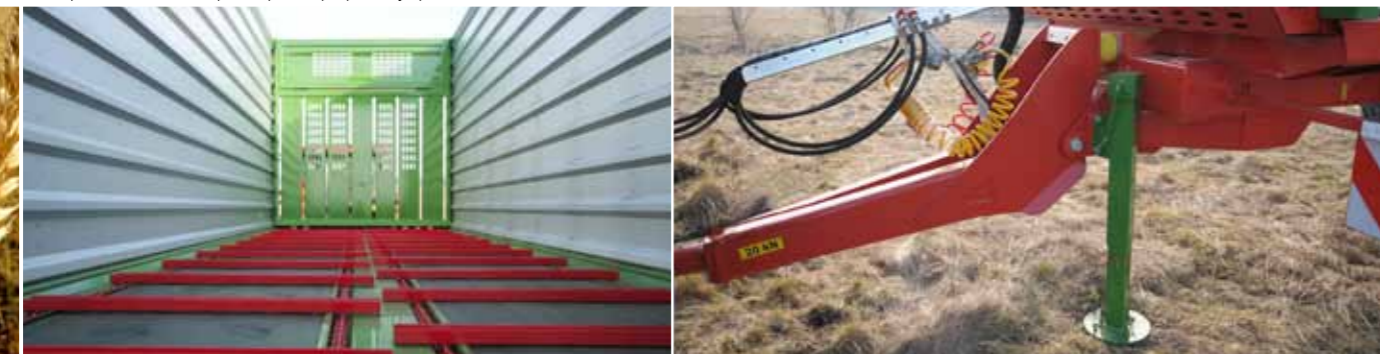
Четырехцепной конвейерный транспортер в полу прицепа
