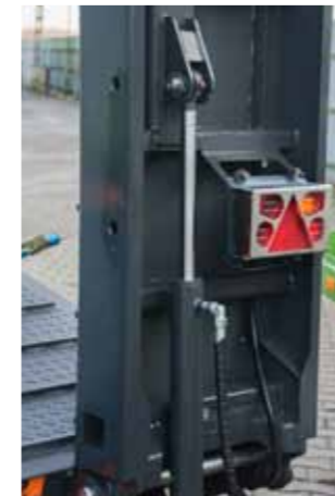
Механическая система подъема/опускания трапов
