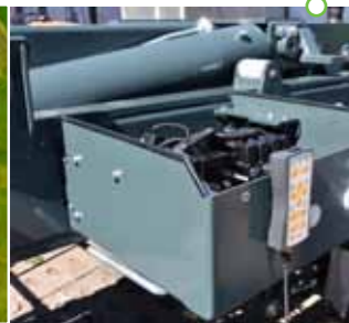
Центральная гидравлическая система с электрическим приводом
