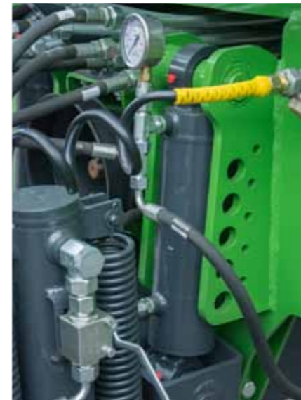
Гидравлический амортизированное дышло
