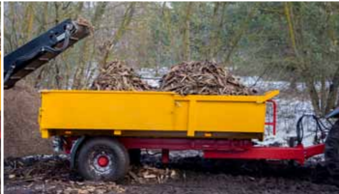
Универсальное, жесткое дышло для агрегации с нижним либо верхним тягово-сцепным устройством трактора
