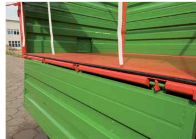
Сменные резиновые прокладки размещенные на краю пола, обеспечивающие абсолютную герметичность кузова (Т680U)
