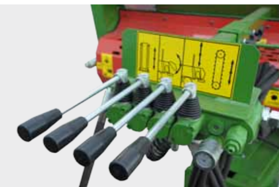
Разбрасыватель PRONAR N262/1 - гидравлический привод конвейера
