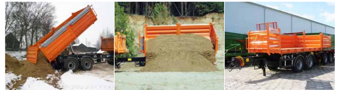
PC2100 - Разгрузка прицепа. Задний борт открывается автоматически при опрокидывании. PC2100/1 - Разгрузка прицепа. Левый борт открывается и закрывается с помощью гидравлических цилиндров. PC2100 - Левый борт открывается в стороны и вниз.
