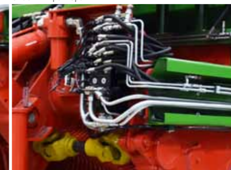
Центральная гидравлическая система управляемая с кабины трактора
