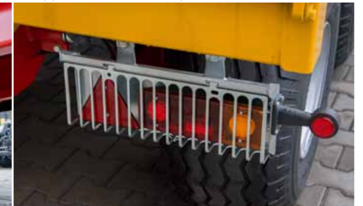
Задние фары с защитой от механических повреждений
