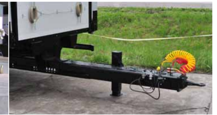
PC2200 - Дышло с регулируемой длиной в интервале ±300 мм
