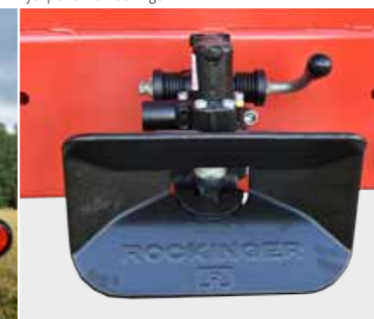
Заднее автоматическое прицепное устройство Rockinger
