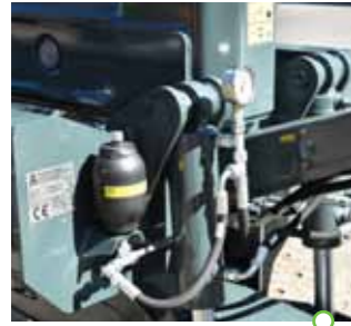
Дышло гидравлически амортизированное
