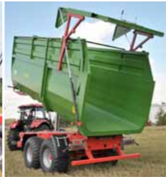
T700 - Гидравлически поднимаемый задний борт с автоматической блокировкой
