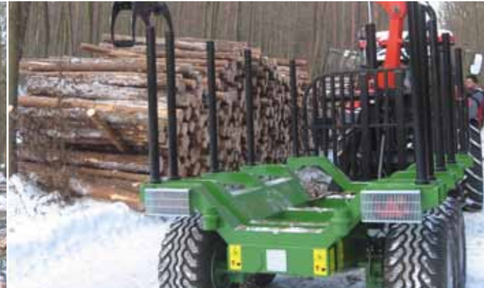
Задняя рама со стойками выдвигается гидравлически
