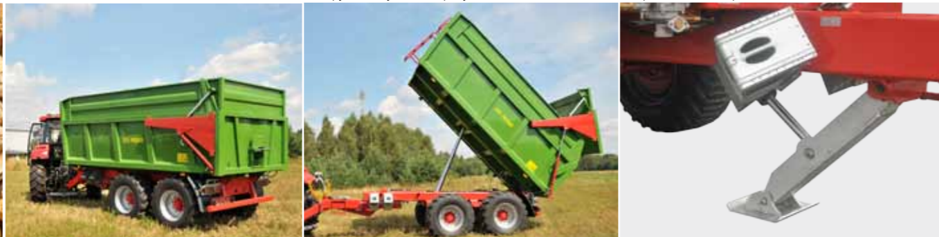
Цельнометаллический кузов с вертикальными ребрами жесткости
