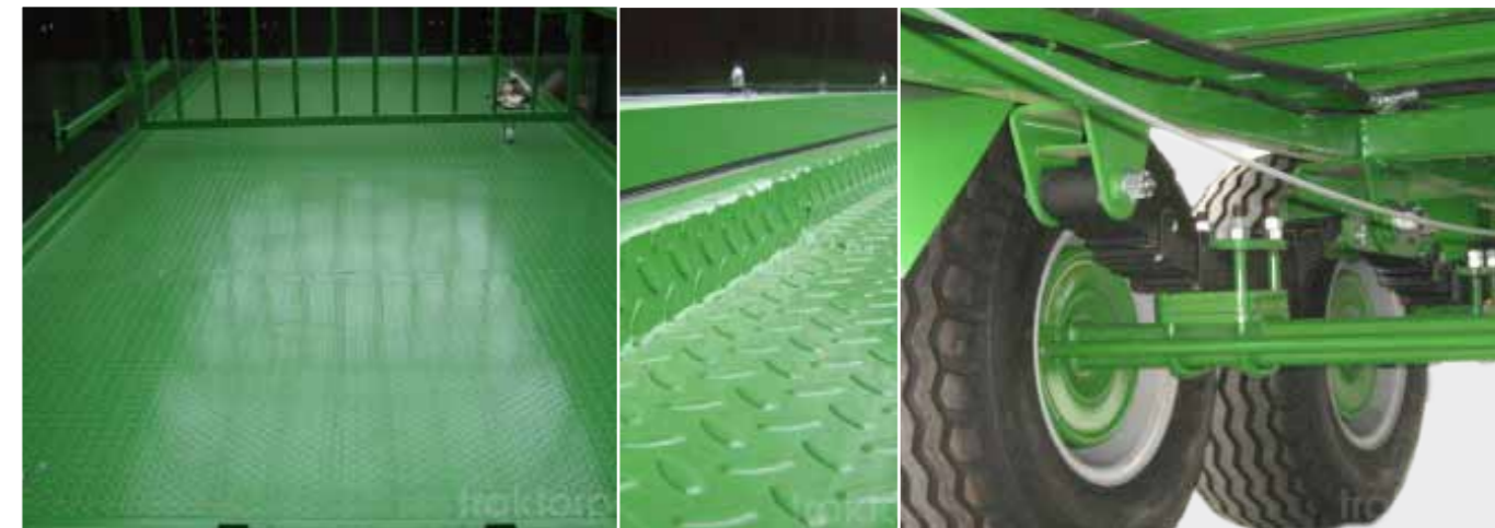
В T046/1 герметичный пол из рифленого металлического листа
