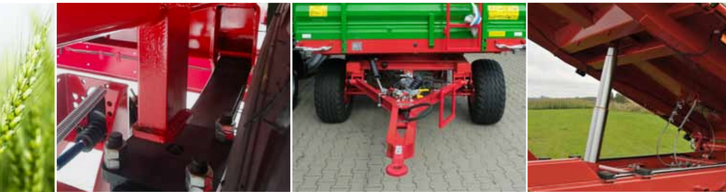
Подвеска на параболических рессорах с металлическим отбойником
