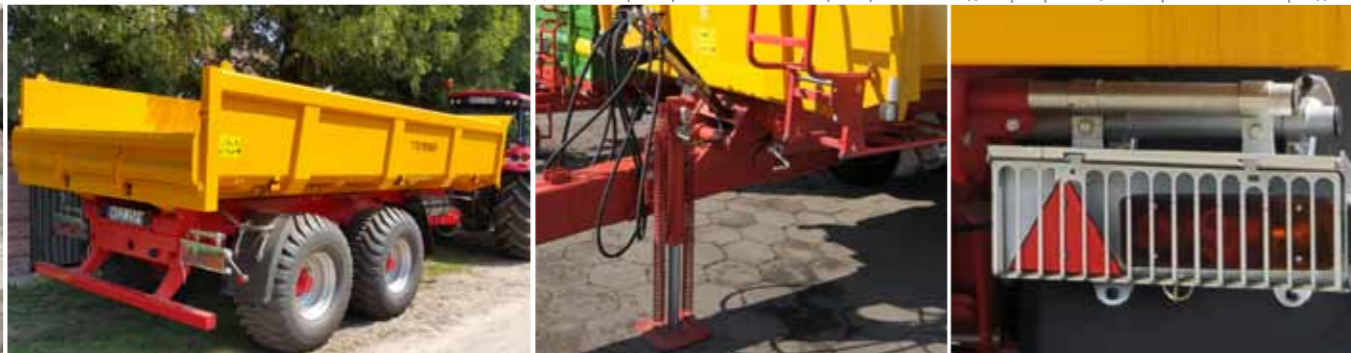
Гидравлически открываемый задний борт.
