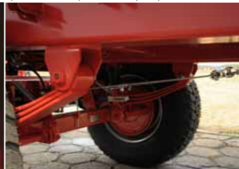
Прочные оси на параболических рессорах
