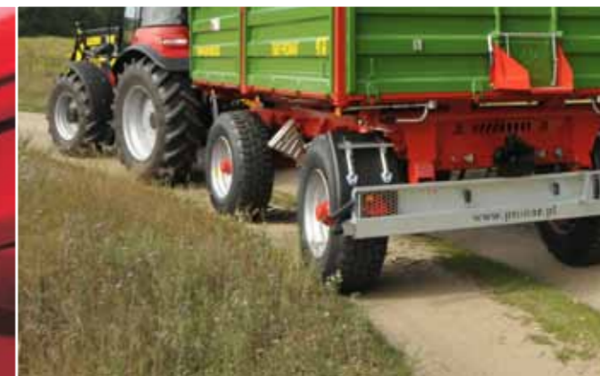
Прочная задняя траверса и освещение с лампами LED с решеткой для защиты от повреждений
