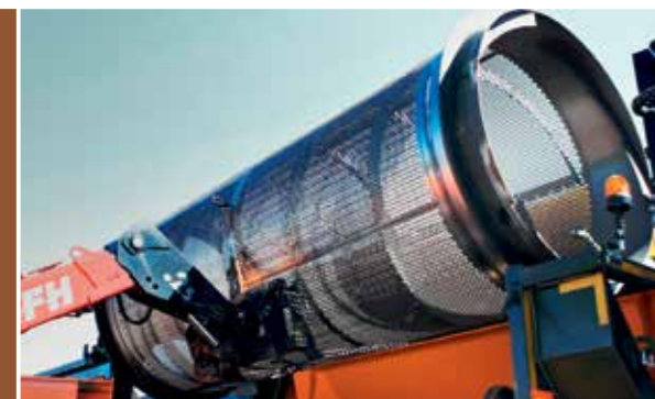
Schneller und einfacher Austausch der Siebtrommel.
