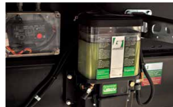
Zentrale Schmierung der Maschine.
