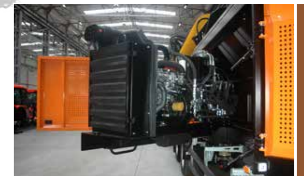
Der Motor und die Hydraulik befinden sich am Drehrahmen, was den einfachen Zugang bei Wartungsarbeiten gewährleistet.
