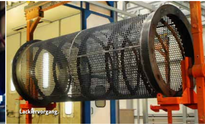
Fertigungsstraße für mobile Trommelsiebmaschinen der Fa. PRONAR.
