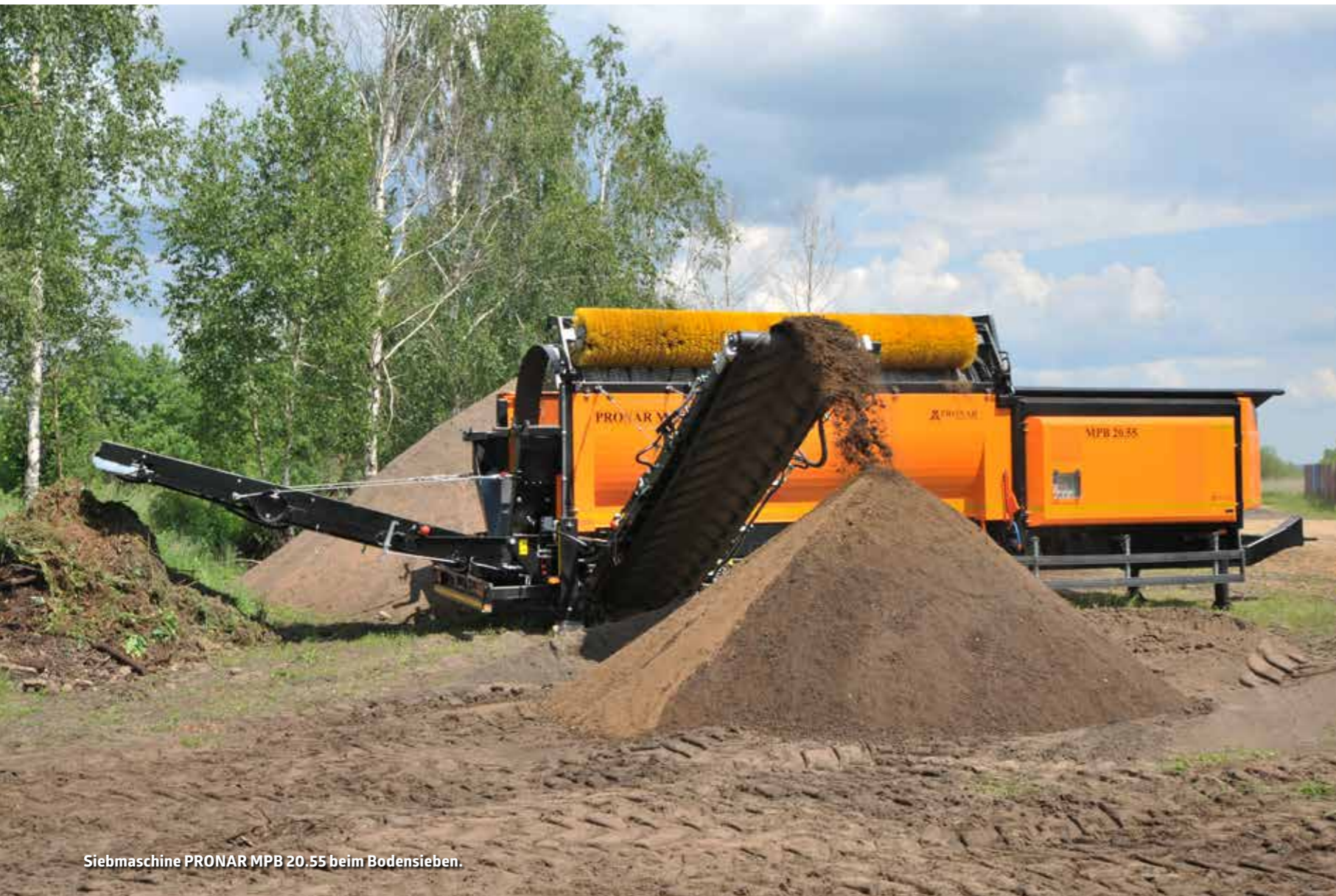
Siebmaschine PRONAR MPB 18.47 beim Sieben von Abfall nach biologischer Stabilisierung.
