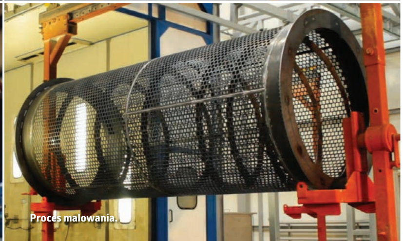
Linia montażowa mobilnych przesiewaczy bębnowych PRONAR.
