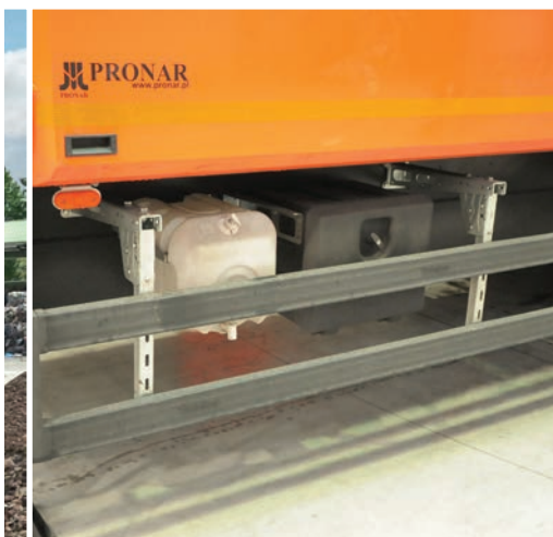
Zbiornik na wodę i mydło w tyłnie jako opcjonalne wyposażenie maszyny.
