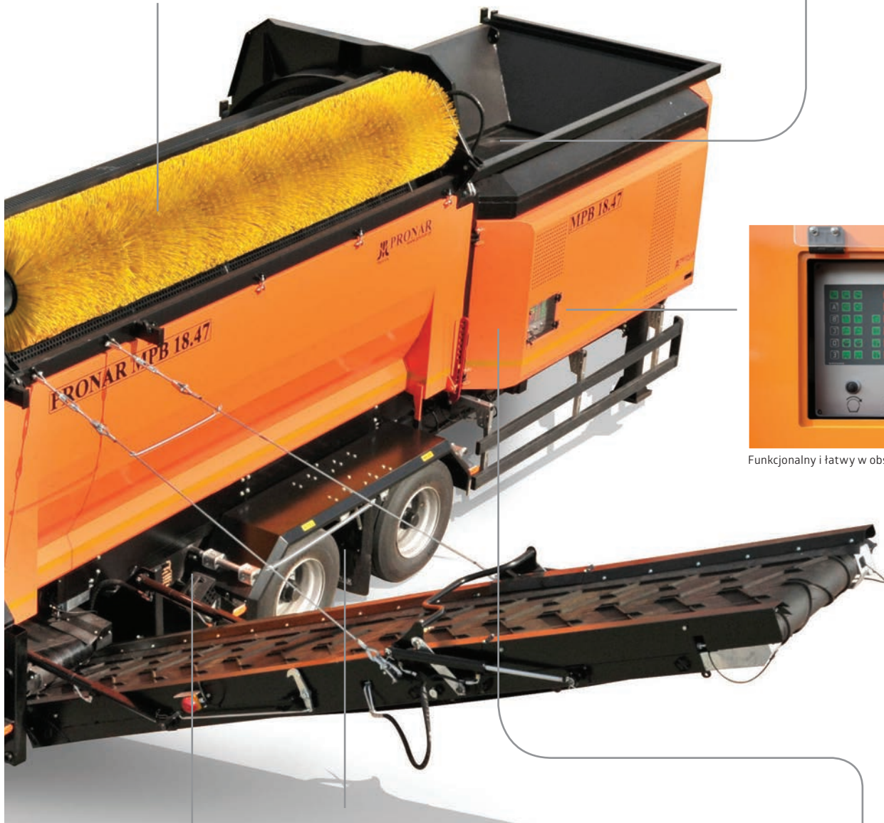
Homologacja przesiewacza zezwala na poruszanie się po drogach publicznych z prędkością do 100km/h.
