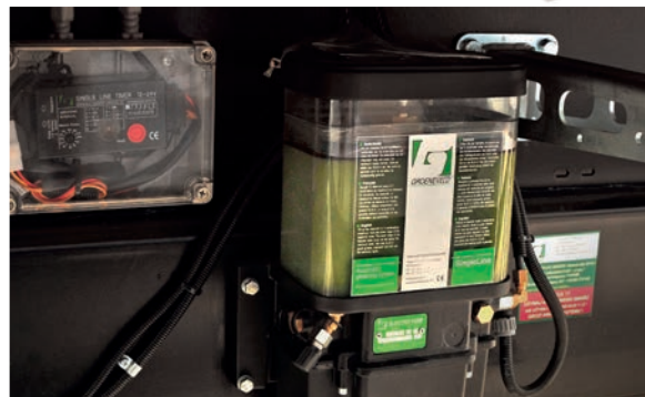
Układ centralnego smarowania maszyny.
