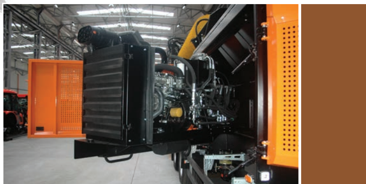
Silnik i układ hydrauliczny umieszczone są na obrotowej ramie co zapewnia łatwy dostęp przy czynnościach serwisowych.
