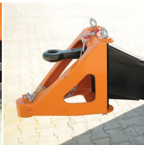
Przegub kulowy pozwala na przestawienie przesiewacza przy użyciu sprzętu budowlanego.
