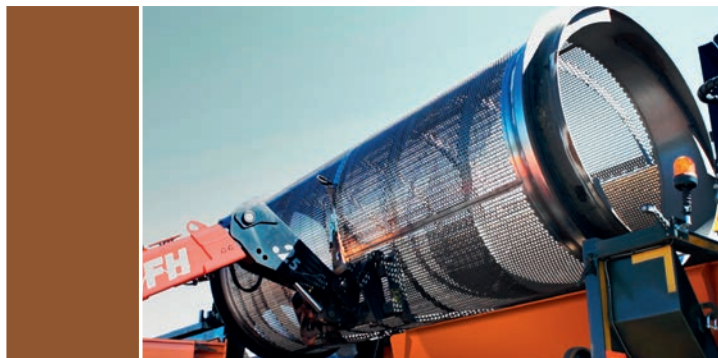
Szybka i łatwa wymiana bębna przesiewającego.
