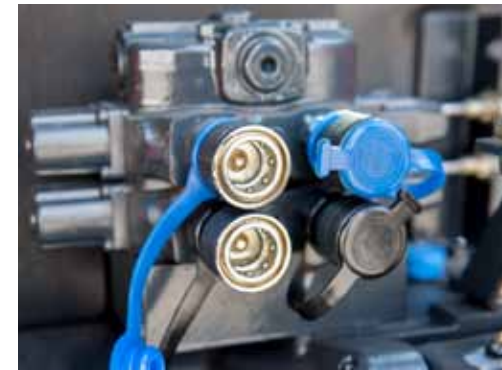
Hydraulika zewnętrzna. Standardowo montowane z tyłu dwie sekcje rozdzielacza hydraulicznego podwójnego działania umożliwiają podłączenie i sterowanie szeroką gamą osprzętu i narzędzi.
