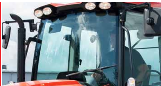
Przednia szyba z lepiej umiejscowioną wycieraczką i nowym uszczelnieniem kabiny zapewnia lepszą widoczność i ochronę przed hałasem.
