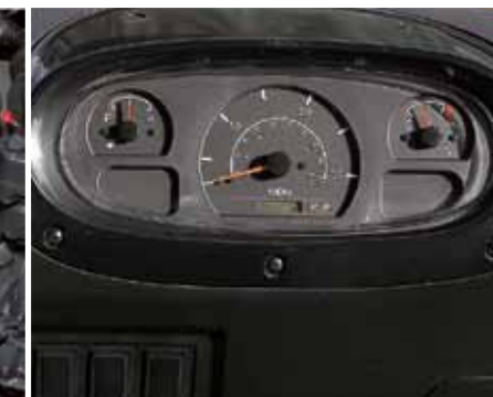
Zestaw wskaźników. Czytelne wskaźniki poziomu paliwa, temperatury, zegar oraz kierunkowskazy.
