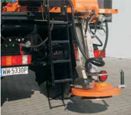
Regulowana wysokość adaptera rozsiewającego.
