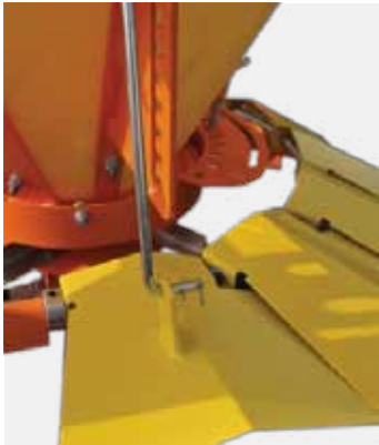
Regulacja szerokości posypu.
