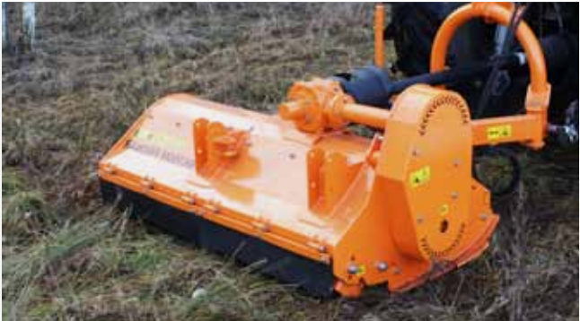
Przekładnia kątowna oraz przekładnia pasowa – zabezpieczenie przeciążeniowe kosiarek z serii BK.
