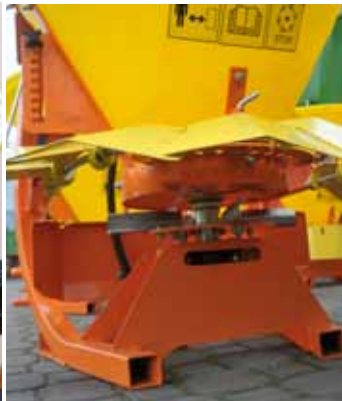
Talerz rozsypujący ze stali nierdzewnej.
