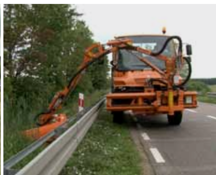
Wykaszanie trudnodostępnego pobocza za pomocą wysięgnika WWP500U i głowicy GK 110.
