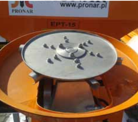
Tarcza rozsiewająca ze stali nierdzewnej.
