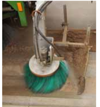
Hydraulicznie sterowana szczotka wysuwana do czyszczenia rynsztoków.
