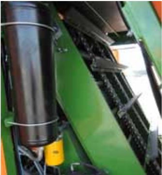
Podajnik zgrzeblowy transportujący zanieczyszczenia do kosza.
