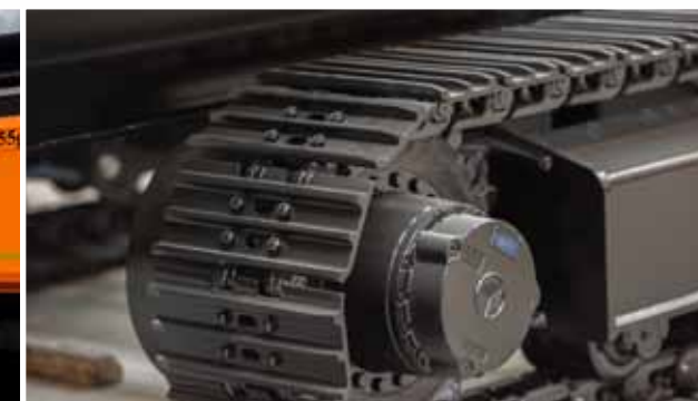
Napęd gąsienicowy pozwala na przemieszczanie po placu roboczym bez dodatkowych ciągników
