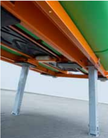
RORO (roll-on/folloff) - system dla łatwiejszego ładowania posypywarek PT70 na platformie ciężarówki
