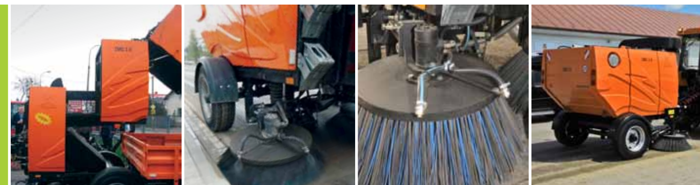
Hydrauliczny system opróżniania kosza.
