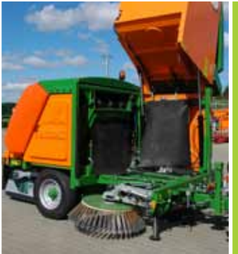
Hydrauliczne opróżnianie kosza.
