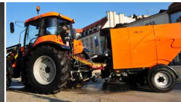
Hydraulicznie skrętny dyszel.
