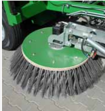
Hydrauliczna regulacja położenia szczotek talerzowych.
