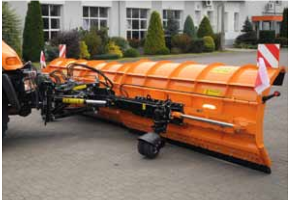
Sposób mocowania – Płyta komunalna DIN76060 typ A
