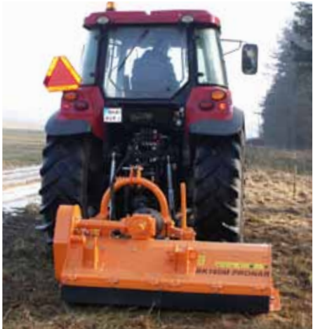
Przesuw hydrauliczny pozwala na koszenie poza obrysem ciągnika.
