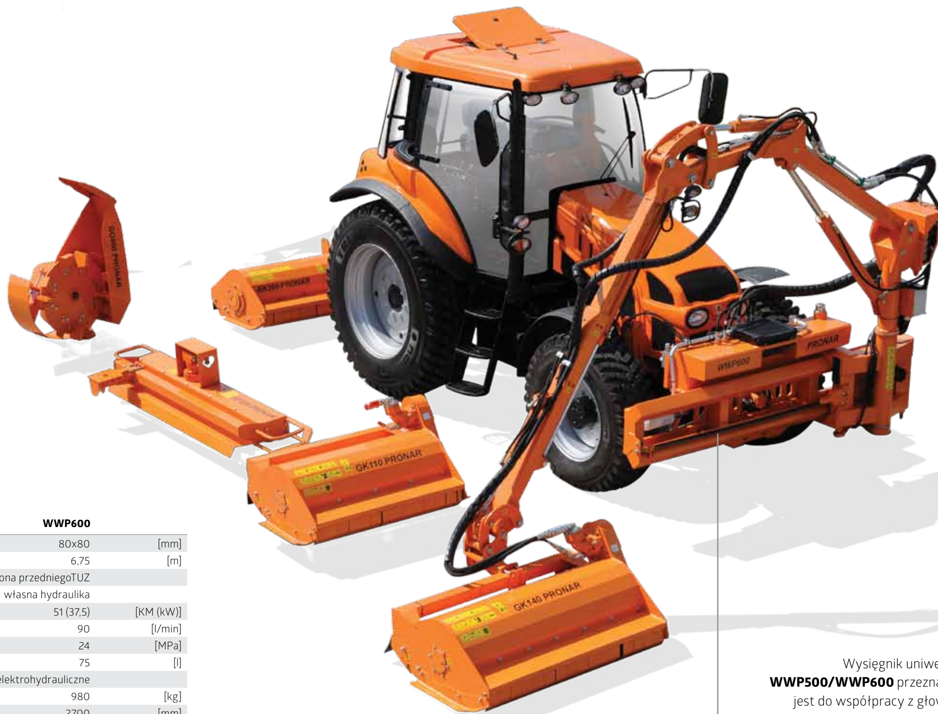
Wysięgnik WWP600 - przesuw hydrauliczny ramienia roboczego po prowadnicy.
