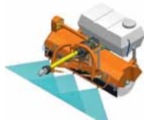
Napęd mechaniczny szczotki z WOM z układem zraszania
