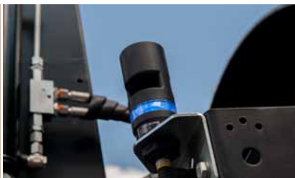
Wielofunkcyjny kogut sygnalizuje tryb pracy (przesiewanie/jazda)
