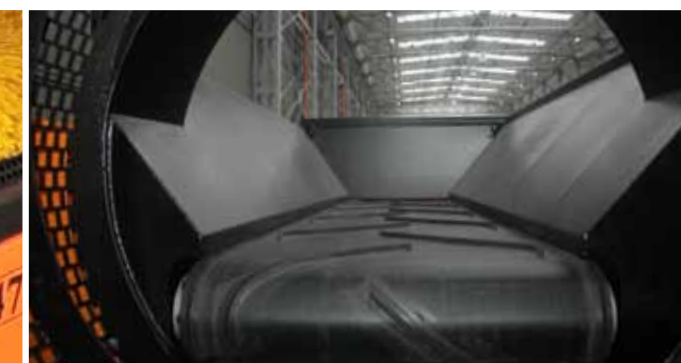
Zbrojona taśma podajnika kosza zasypowego
