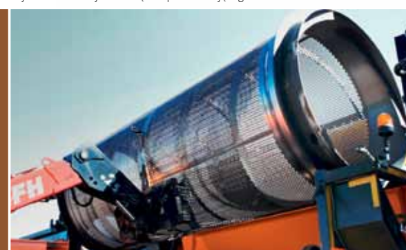
Szybka i łatwa wymiana bębna przesiewającego
