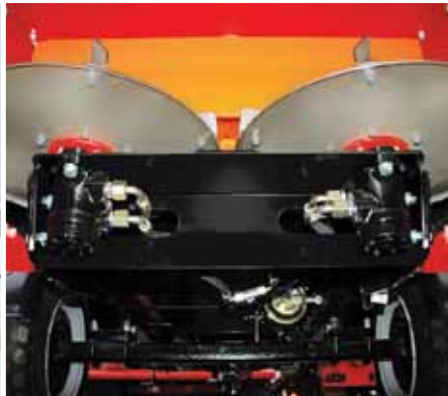
2 adaptory rozsiewające ze stali nierdzewnej.
