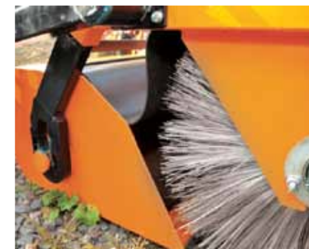
Szczotka i wanna zbierająca zanieczyszczenia.
