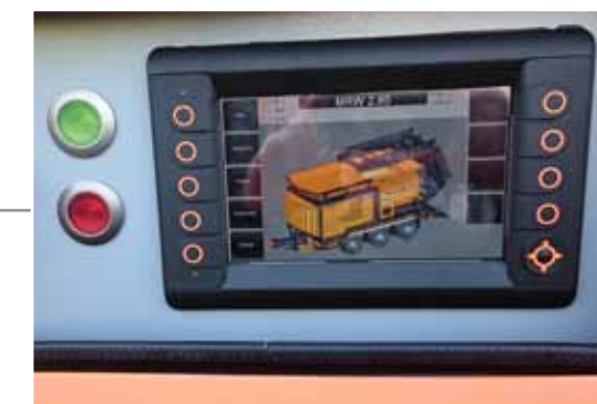
Dotykowy panel sterujący wszystkimi funkcjami maszyny
