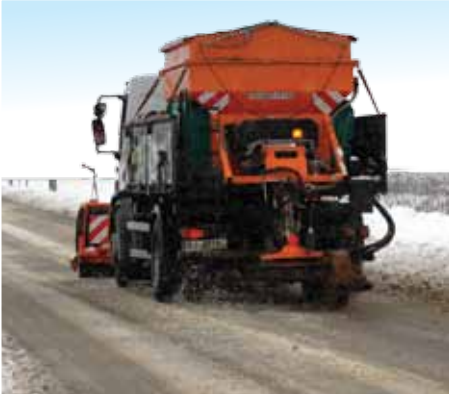
Posypywarka samochodowa z serii PT napędzana z koła wleczonego (KPT40).
