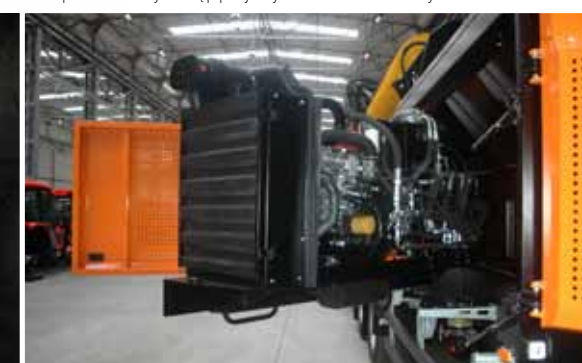
Silnik i układ hydrauliczny umieszczone są na obrotowej ramie co zapewnia łatwy dostęp przy czynnościach serwisowych
