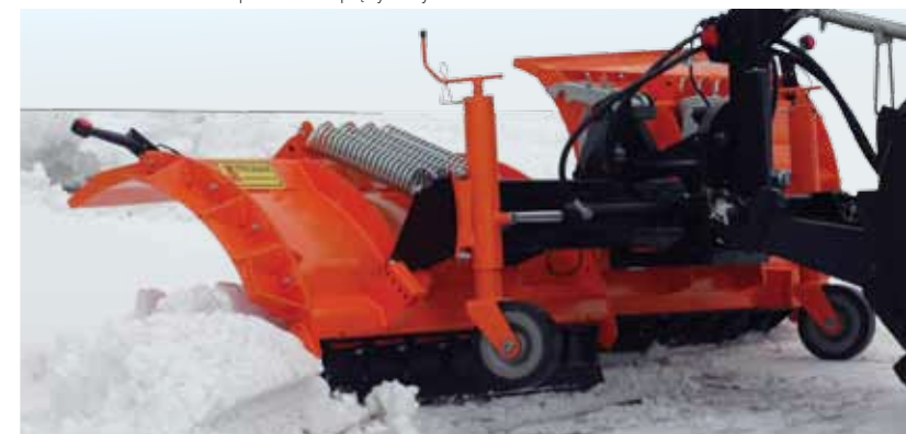
Łamana odkładnica z zabezpieczeniem sprężynowym.
