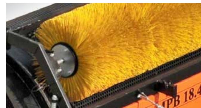
Szczotka czyszcząca bęben opuszczana i podnoszona hydraulicznie
