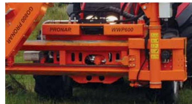
Wysięgnik WWP600 - przesuw hydrauliczny ramienia roboczego po prowadnicy.
