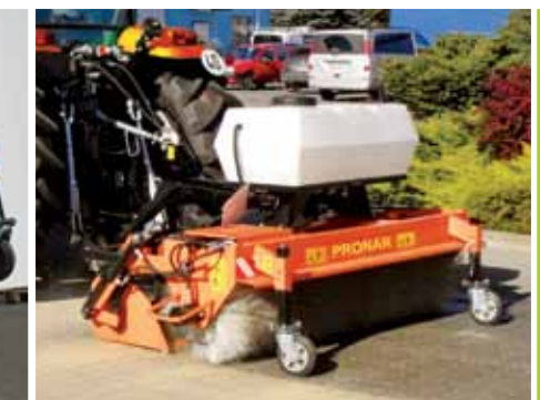
Układ zraszania zmniejszający emisję pyłu i kurzu.
