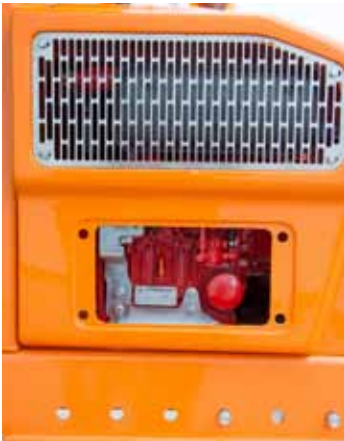
Spalinowy silnik o pojemności 100cm 3 i mocy 16,2kW
