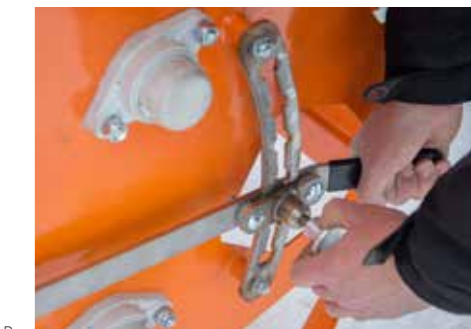
Manuelle Einstellung der Streudichte durch Druck auf die Streutrommel
