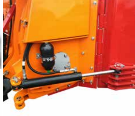
Hydraulische Steuerung der Verbreiterung
