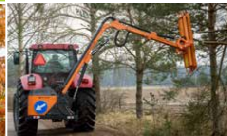
WWT700T - mit dem Teleskopausleger hat der Ausleger eine enorme Reichweite
