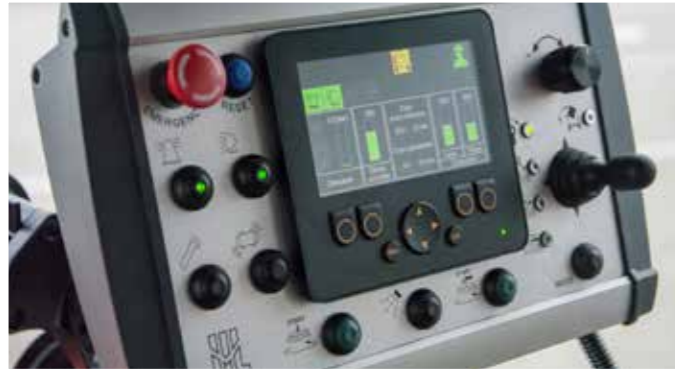
Steuerpult - alle Funktionen der Kehrmachine werden über das Bedienpult in der Traktorkabine gesteuert
