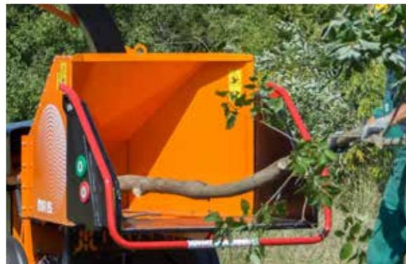
Aste werden automatisch mit Hilfe von hydraulisch angetriebenen Einführungsrollen gezogen.
