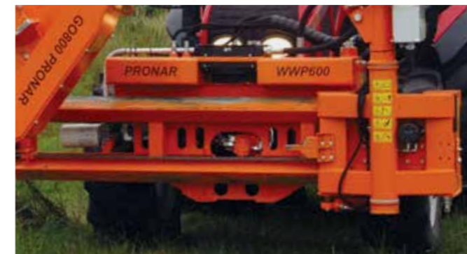
Ausleger WWP600 -Hydraulische Führungsschiene des Arbeitsarms.
