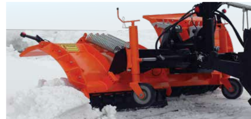
Gebrochene geteilte Schürfleiste mit Federsicherung
