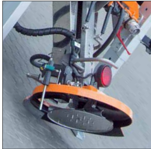
Entladesystem mit Spreizscheibe
