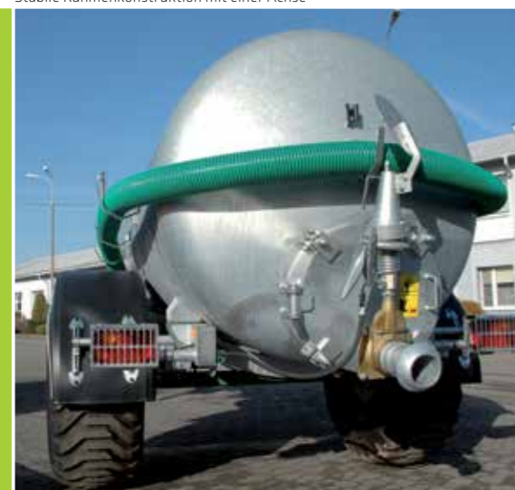
Stabile Rahmenkonstruktion mit einer Achse
