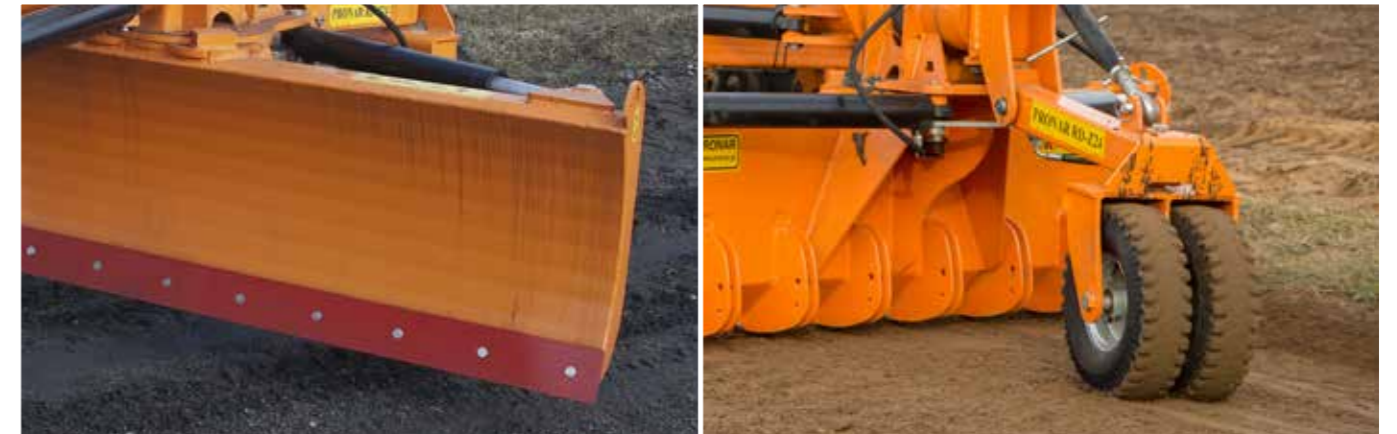
Räumleiste ist mit einer Schürfleiste aus verschleißfestsen Stahl ausgestattet
