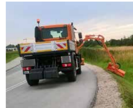
Mähen an schwer zugänglichen Randstreifen mittels Ausleger WWP500UH und Kopf GK 110.
