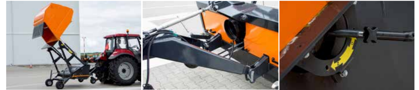
Schieber ermöglicht mähen ohne Aufsammeln
