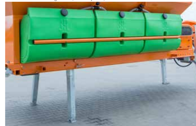
Höhenverstellbare Stützfüße zum Verladen der Maschine auf einen Kipper, ohne den Einsatz von Zusatzgeräten (RORO-System)
