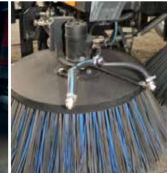
Wassersprüheinrichtung vor den Tellerbürsten
