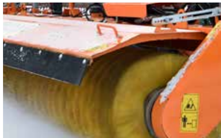
Gummischürze und der verstellbare Schutz zum Ableiten des Kehrgutes
