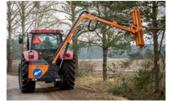
WWT700T, WWT800T - eine große Reichweite wird durch den ausziehbaren Arm mit Hilfe des Teleskopzylinders erreicht
