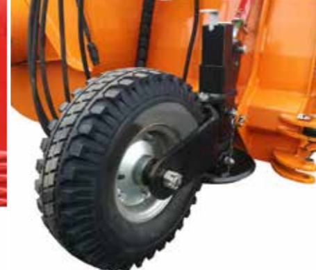
Rutschen und Stützräder behalten den Abstand zwischen der Oberfläche und der Klinge bei (um die Dicke der Schicht zu begrenzen)
