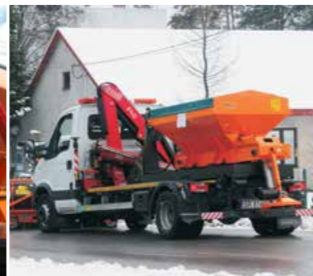
Die Maschine kann mit dem Abrollkipper betrieben werden.
