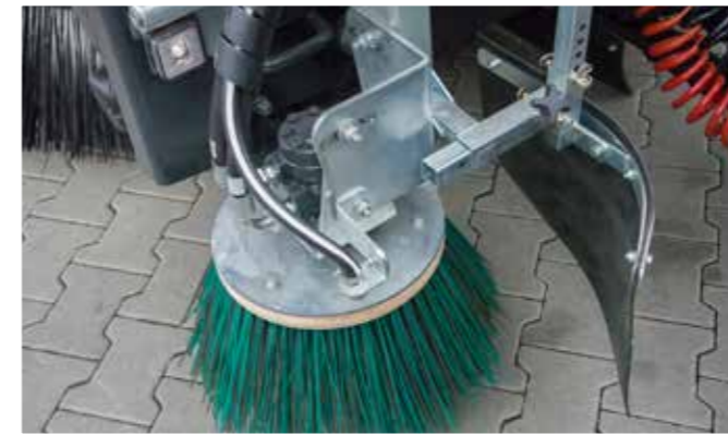
Rechte Seitenbürste oder linke Seitenbürste - Kehrbreite erhöhen; Reichweite: 700mm außerhalb der Maschine
