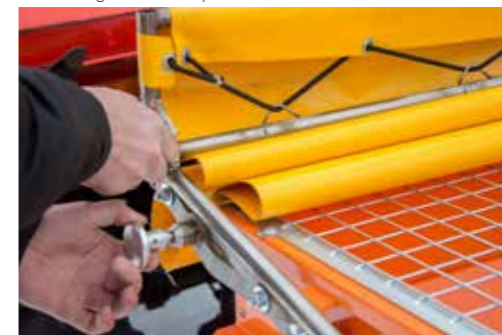
Manuelle Faltpane mit Lagesicherung schützt Material gegen die Auswirkungen von atmosphärischen Einflüssen
