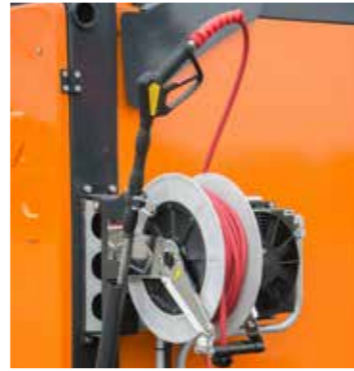
Hochdruckreiniger - Wasserdruck bis 150 bar
