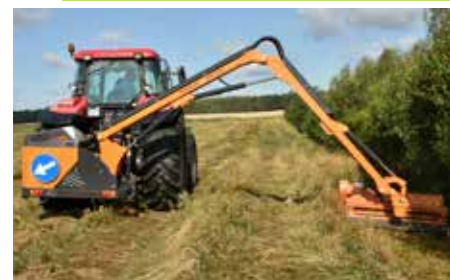
Ausleger WWT600 - ermöglicht die Durchführung von Arbeiten an schwer zugänglichen Stellen
