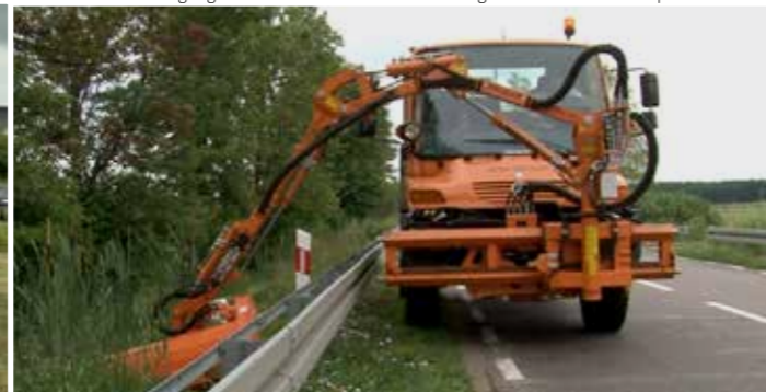
Mähen an schwer zugänglichen Randstreifen mittels Ausleger WWP500U und Kopf GK 110.
