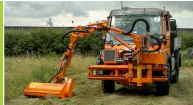
Ausleger WWP500U mit Mähkopf GK110 am Unimog U500.
