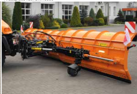
Anbauplatte nach DIN 76060
