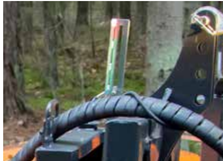
Die Arbeitspositionsanzeige erleichtert das Einstellen der optimalen Höhe des Gestänges
