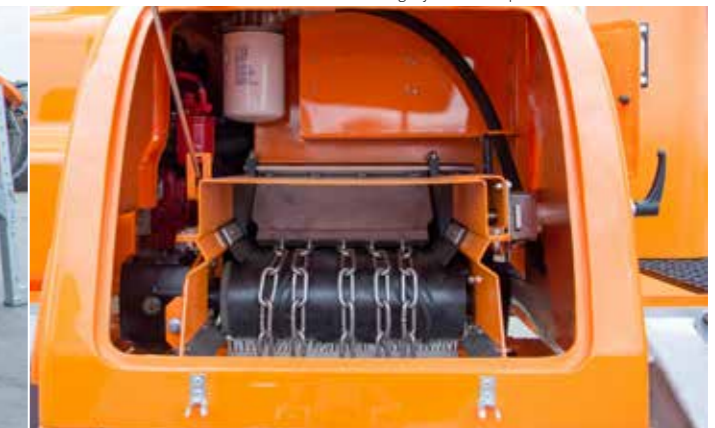
Material wird über ein Förderband zum Beschickungssystem transportiert
