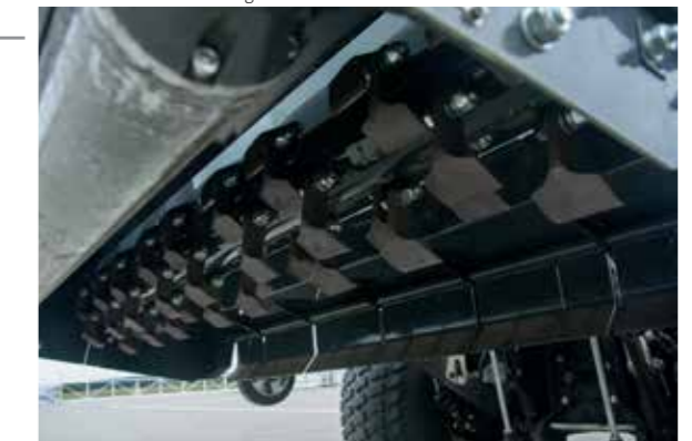
Die Schneideinheit - Schlegelwelle mit austauschbaren Messern
