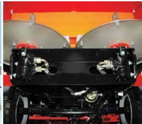
2 Streuadapter aus rostfreiem Stahl.
