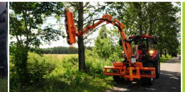
Ausleger WWP600 mit Astschere GP200.
