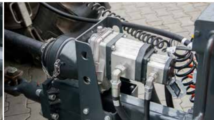
Hydraulik mit zwei Hydraulikpumpen und Ölkühler
