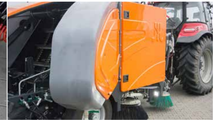
Sprinkleranlage - große Tankkapazität ermöglicht die gleichzeitige Befüllung mit 1120 l Wasser. Das große Tankvolumen ermöglicht die komfortable Arbeitsbedingungen
