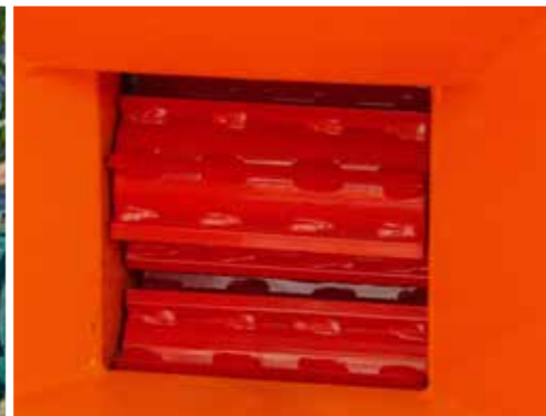
Vorschubwalzen für den Zerkleinerungsmessersatz.
