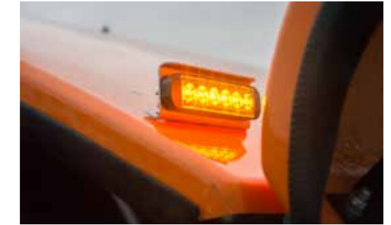
Warnleuchten an der oberen Schutzeinrichtung montiert
