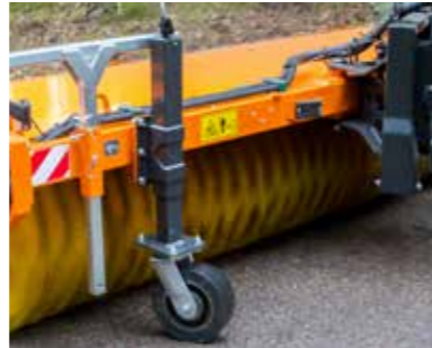
Selbsteinstellende Räder mit stufenlosem Höhenverstellung
