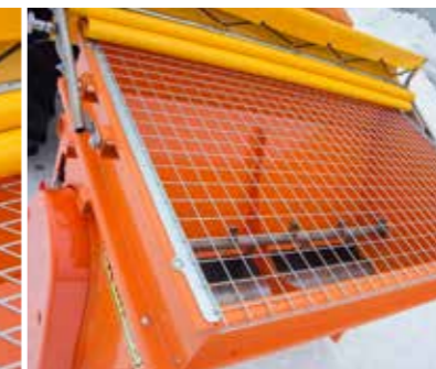
Manuelle Faltpane mit Lagesicherung schützt Material gegen die Auswirkungen von atmosphärischen Einflüssen
