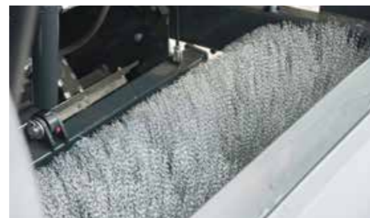
Walzenbürste ist aus den austauschbaren Scheibensegmenten hergestellt
