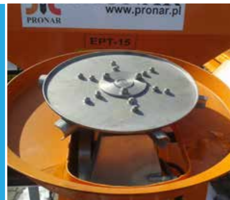
Streuschild aus rostfreiem Stahl.
