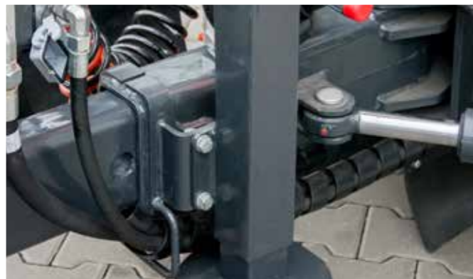
Torsionsdeichsel - untere Deichsel - obere Deichsel optional
