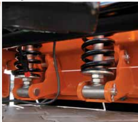
Federung der Räumleisten.
