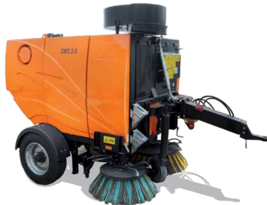
Wassersprüheinrichtung vor den Tellerbürsten
