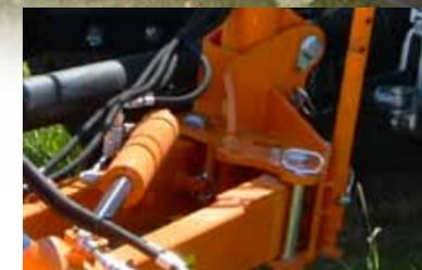
Предохранитель позволяет сбалансировать мульчер после наезда на препятствие (возможно зближение)
