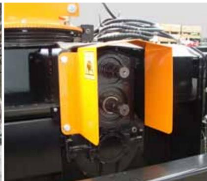
Управление метателем и регулирование дальности отброса снега при помощи гидравлики
