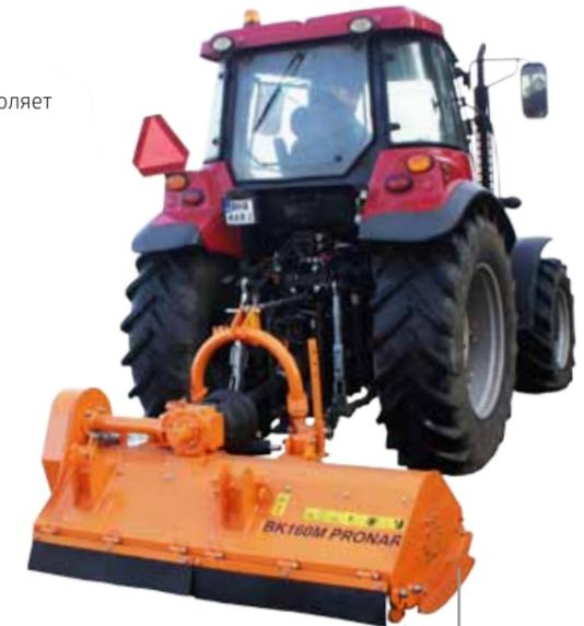
регулировка угла атаки скользящих полоз позволяет легче преодолевать препятствия
