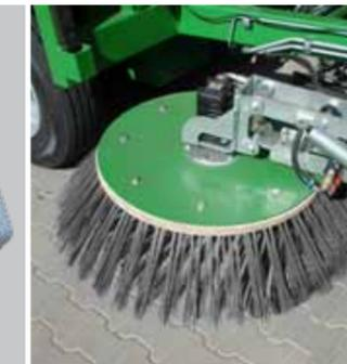
Регулирование положения дисковых щеток гидравлически
