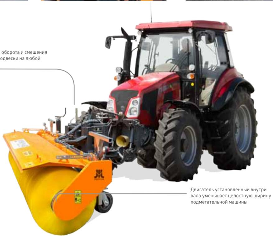
Двигатель установленный внутри вала уменьшает целостную ширину подметательной машины
