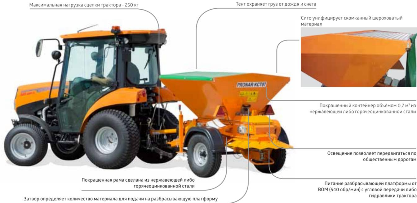
**ПРИ ЦЕПНОЙ РАЗБРАСЫВАТЕЛЬ ПЕСКА И СОЛИ**
