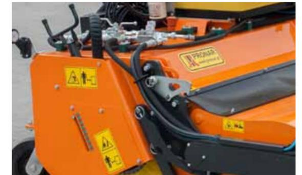
Винтовой подъёмник цилиндрической щётки позволяет легко опускать щётку по мере износа
