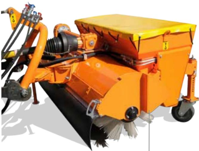
Подметально-уборочная машина ZM-P16 является инновационным решением фирмы Pronar благодаря возможности выбора типа привода в зависимости от имеющегося парка транспортных средств – можно выбрать механический привод от ВОМа или гидравлический.
