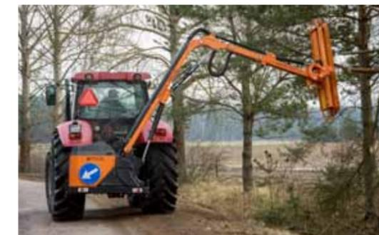
WWT700T, WWT800T – Большой диапазон реализуется благодаря раскладыванию стрелы с помощью телескопического цилиндра
