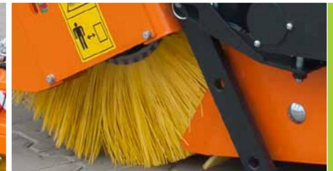
Цилиндрическая щетка состоит из колец (возможны различные варианты жесткости)
