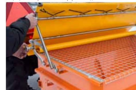
Защитная решётка защищает систему разбрасывания от повреждений камнями и собранным материалом и предотвращает
