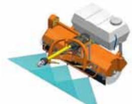
Привод щетки механический от ВОМа с оросительной системой
