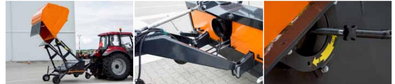
Гидравлическая разгрузка на прицеп высоты до 2,1 м
