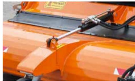
Подвешенные на плавающем плече дисковые боковые щётки (диаметром 600 мм каждая) увеличивают рабочую ширину устройства и удаляют загрязнения из труднодоступных мест
