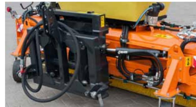
Универсальная рамка для крепления позволяет на агрегацию с широким спектром носителей, от тракторов по погрузчики (на фото крепление на ТСН)
