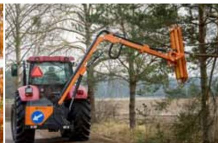
Большой радиус осуществляется благодаря выдвинутому рукаву при помощи телескопического цилиндра
