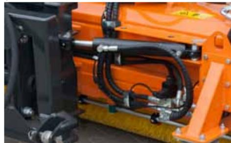
Система орошения для уменьшения пылеобразования в окружении подметальной машины
