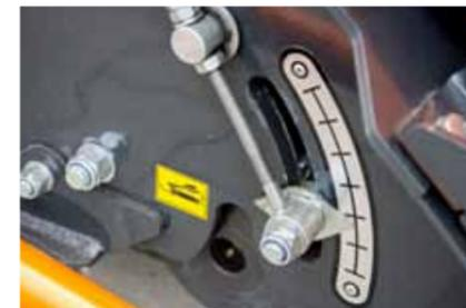
Бесступенчатая регулировка высоты
