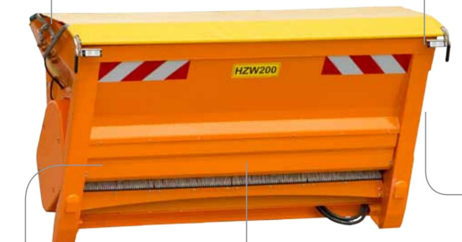
Рабочий вал с планчатым поводком безопасным способом разсыпает материал на дорогу
