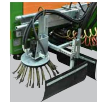
Гидравлическое управление выдвижной щеткой для очистки желобов
