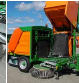
Опустошение бункера гидравлически
