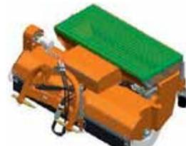
Гидравлический привод щётки и посыпающего вала пескоразбрасывателя
