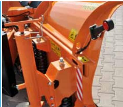
Защитный пружинный механизм (подвижные ножи отвала)
