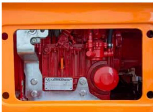
Двигатель внутреннего сгорания мощностью 16,2 кВт - SPT70)
