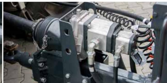
Гидравлика - гидравлика с двумя гидравлическими насосами и радиатором масла
