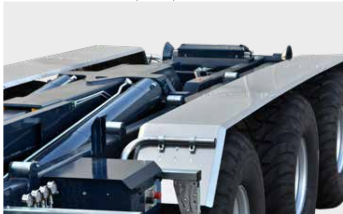
Stabilna rama z dwoma siłownikami hydraulicznymi
