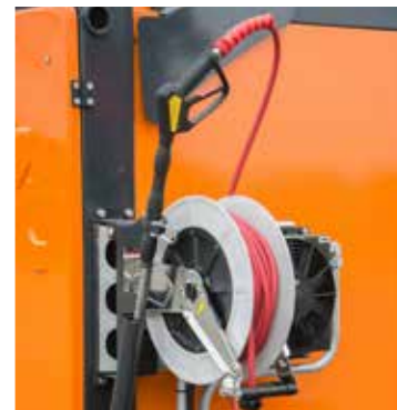
Myjka ciśnieniowa -ciśnienie wody do 150 bar
