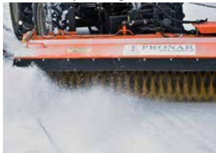
Gumowy fartuch i regulowana osłona do kierunkowania odmiatanego materiału
