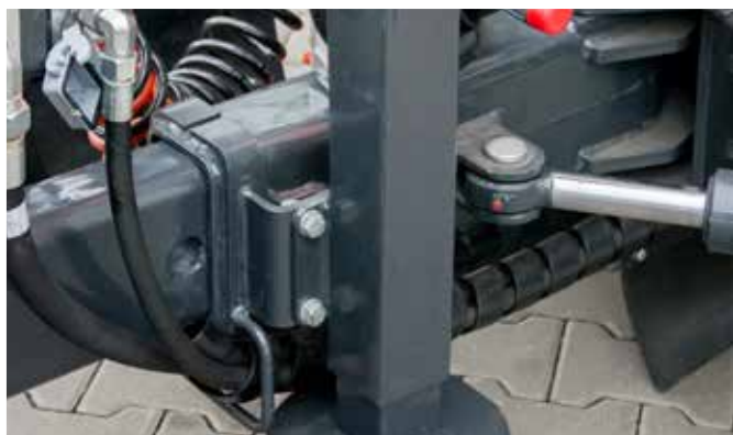
Dyszel -skrętny dyszel dolny - opcjonalnie dyszel górny
