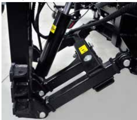
Siłownik hydrauliczny do podnoszenia/opuszczania pługa
