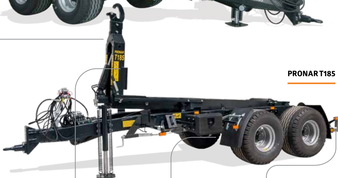
Manualne przełączenie funkcji hakowiec-wywrotka
