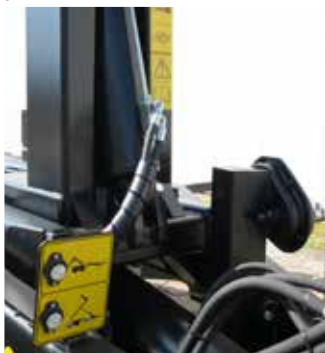
Automatyczne przełączenie funkcji hakowiec-wywrotka
