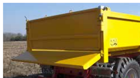
Hydrauliczna otwierana kłapa dolna oraz rozwiernowahliwa kłapa górna
