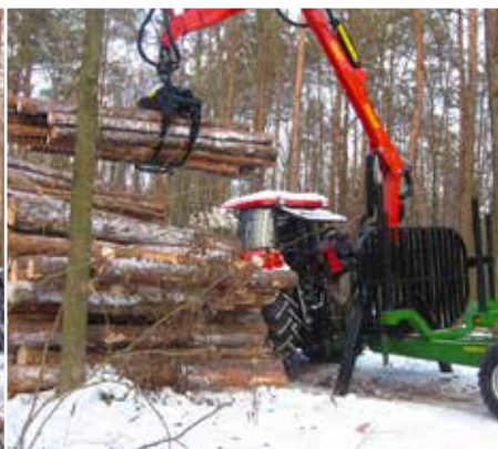
Hydrauliczne teleskopowe podpory ładowacza
