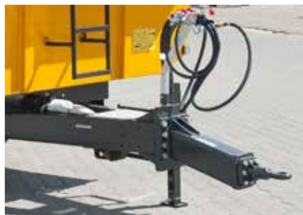
Dyszel uniwersalny sztywny do łączenia z dolnym lub górnym zaczepem ciągnika
