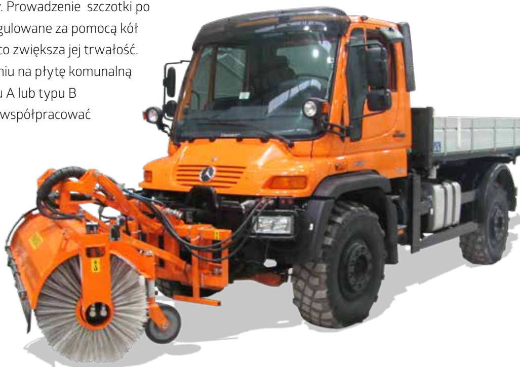
Hydrauliczny skręt szczotki \pm 30^\circ
