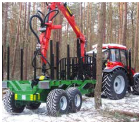
Mocne słupki i przednia bariera zabezpieczająca
