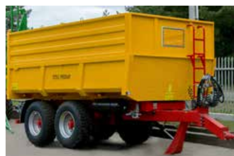
Nadstawy 800 mm powiększające pojemność przyczepy do 16,6 m 3
