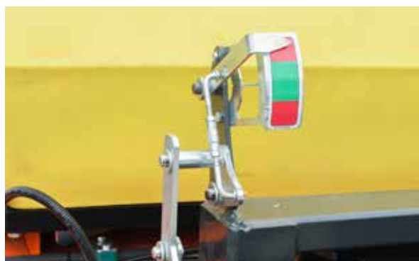
Wskaźniki pozycji i wysokości pozwalają ustawić maszynę w optymalnej pozycji pracy
