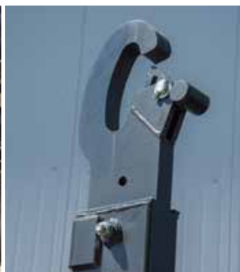
Hak z automatycznym zabezpieczeniem kontenera
