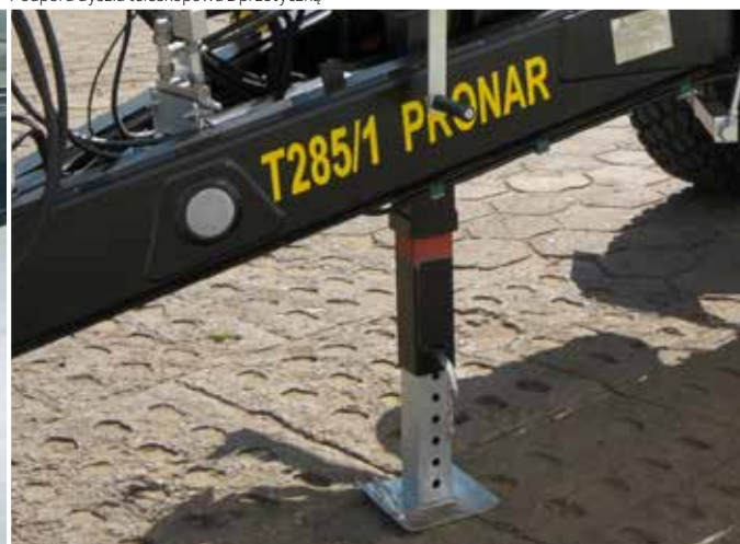
Podpora dyszla teleskopowa z przetyczką
