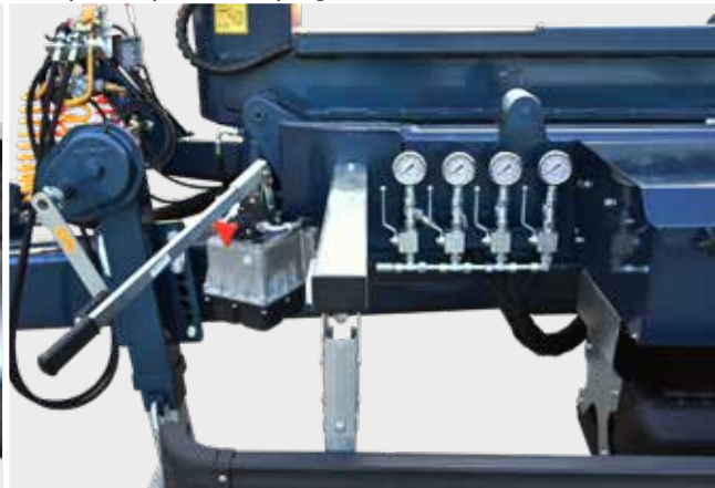
Układ hydrauliczny kierowania czynnego
