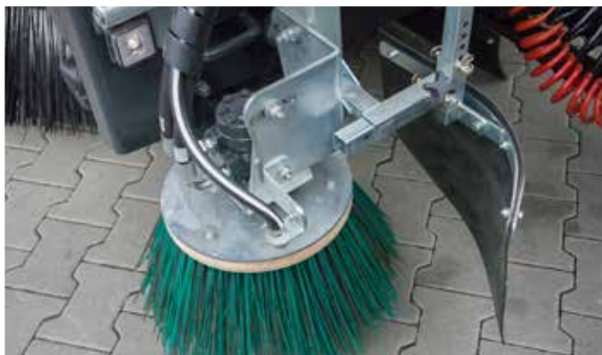
Szczotka boczna-prawa lub szczotka boczna lewa -zwiększenie szerokości zamywania; zasięg: 700mm poza obrys maszyny
