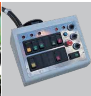
Panel sterowniczy w kabinie operatora
