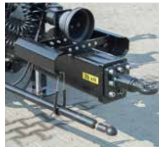
Hydrauliczny układ skrętu - siłowniki dwustronnego działania po prawej stronie dyszla
