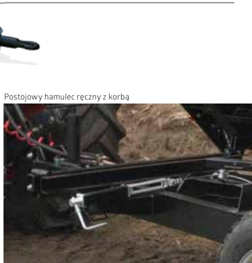
Dyszel sztywny do łączenia z dolnym zaczepem ciągnika
