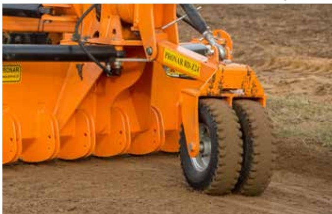
Koła podporowe zamontowane z tyłu maszyny. Opcjonalnie – hydrauliczne sterowanie kołem podporowym
