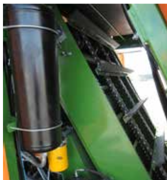
Podajnik zgrzeblowy transportujący zanieczyszczenia do kosza
