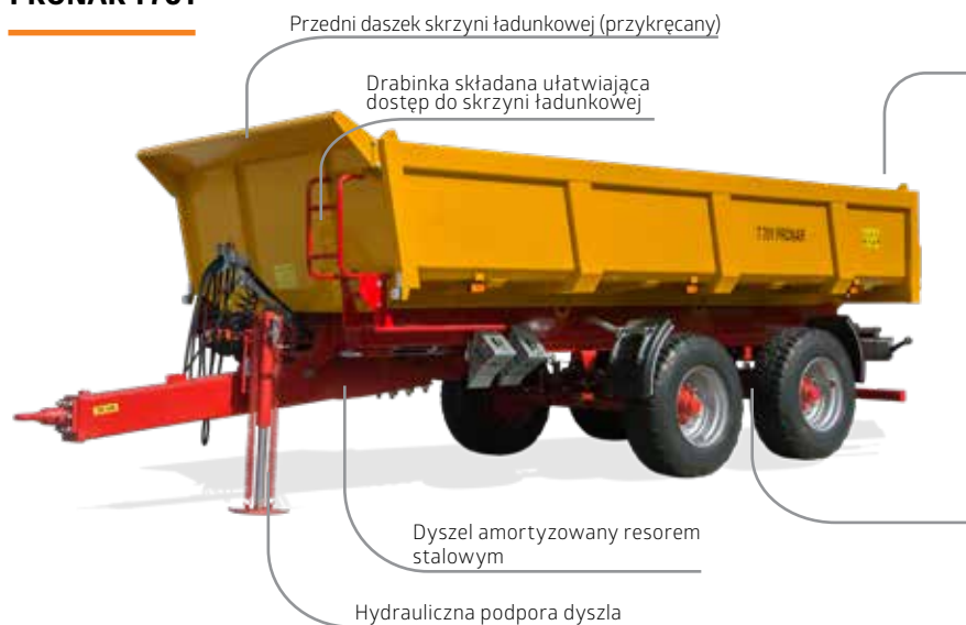
Hydrauliczna kłapa tylna uchylana do dołu.
