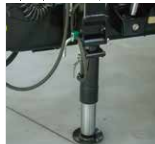
Podpora dyszla składana hydraulicznie
