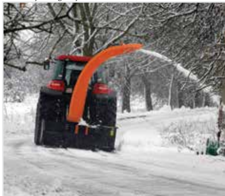
Komin wysokiego wyrzutu
