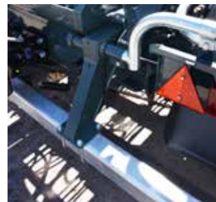
Zderzak tylny wysuwany hydraulicznie
