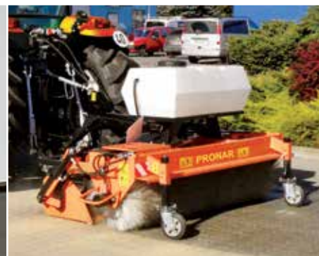
Układ zraszania zmniejszający emisję pyłu i kurzu
