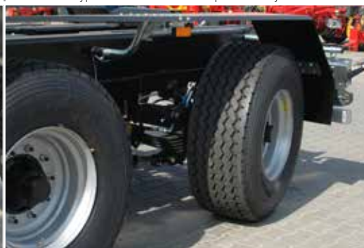
Zawieszenie typu tandem na 4 resorach parabolicznych
