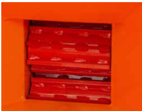
Rolki podające materiał na komplet noży rozdrabniających.
