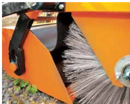
Szczotka i wanna zbierająca zanieczyszczenia
