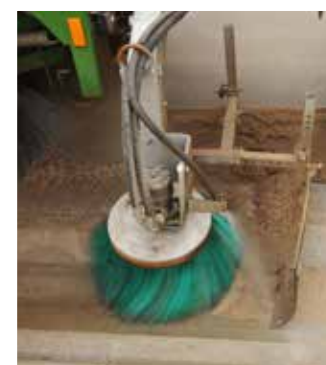
Hydraulicznie sterowana szczotka wysuwana do czyszczenia rynsztoków
