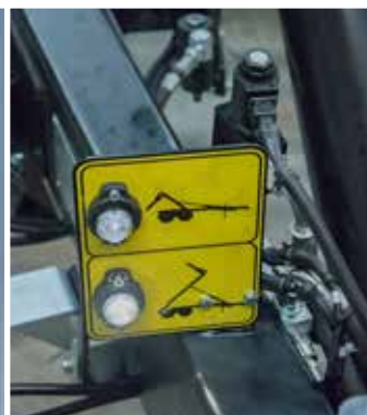
Automatyczne przełączenie funkcji hakowiec-wywrotka
