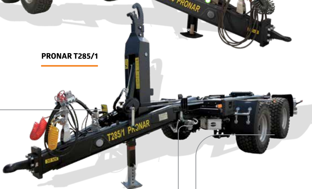
Automatyczne przełączenie funkcji hakowiec-wywrotka
