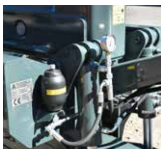
Dyszel amortyzowany hydraulicznie
