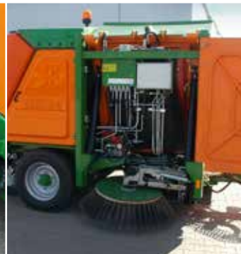
Uchylny wrota serwisowe. Czujnik po otwarciu zatrzymuje maszynę
