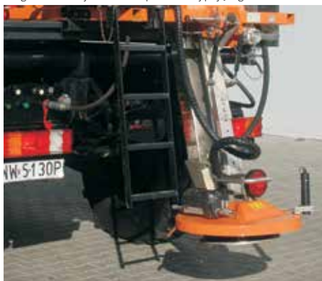
Regulowana wysokość adaptera rozsypującego.
