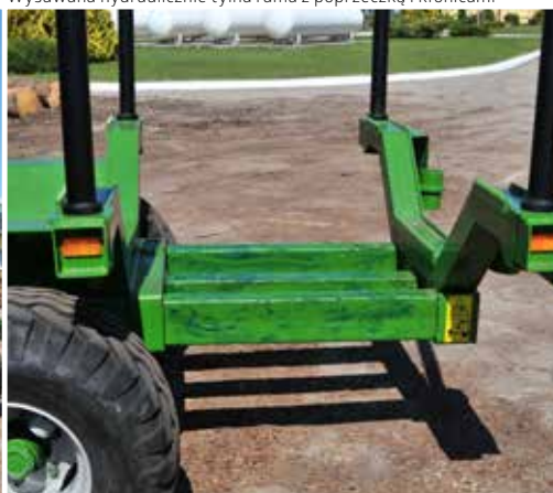
Wysuwana hydraulicznie tylna rama z poprzeczką i kłonicami
