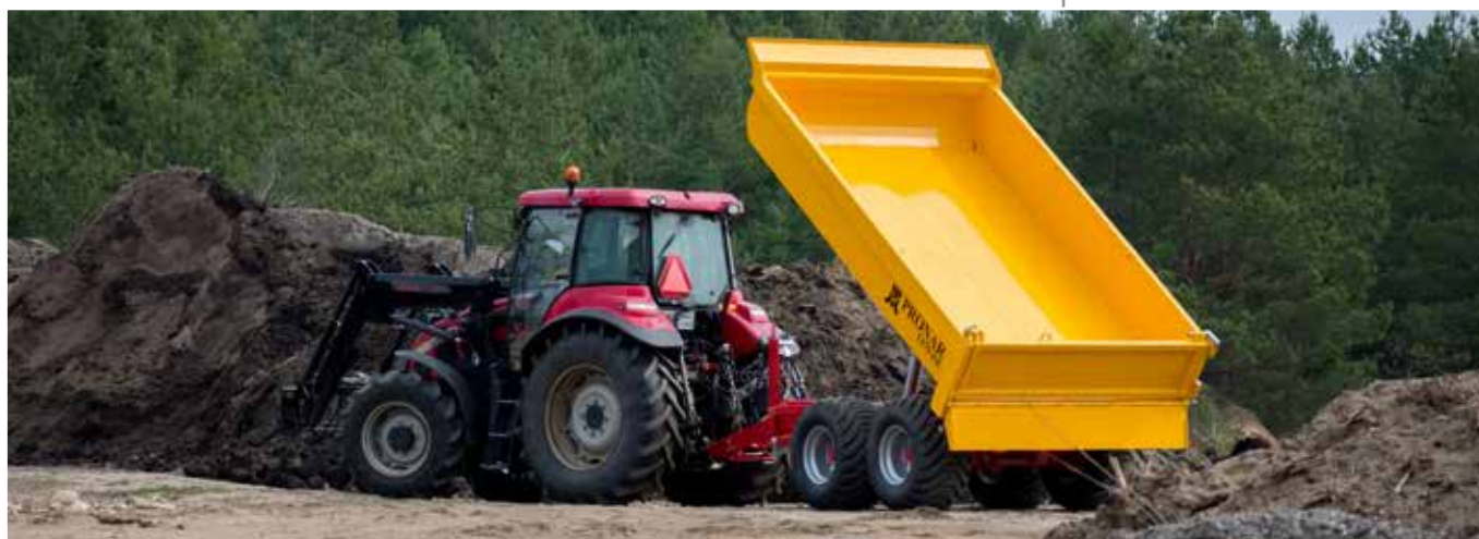
T679/4M - Skrzynia ładunkowa o budowie skorupowej (wersja budowlana); ściana boczna i połowa podłogi wykonane z jednego arkusza blachy
