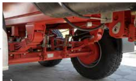
Zawieszenie tandem z resorami parabolicznymi.
