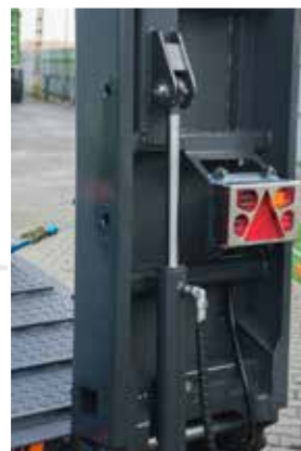
Hydrauliczny system opuszczania / podnoszenia najazdów
