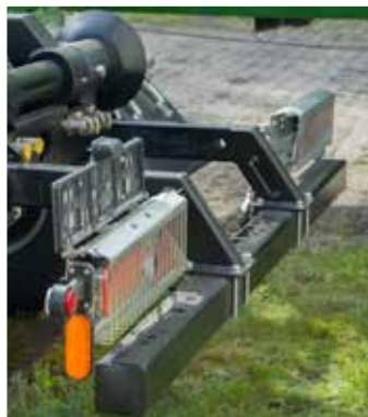
Zderzak tylny wysuwany ze światłami
