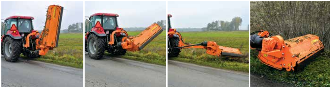
Kosiarka pracuje z prawej strony ciągnika. Pozycja transportowa – do pionu
