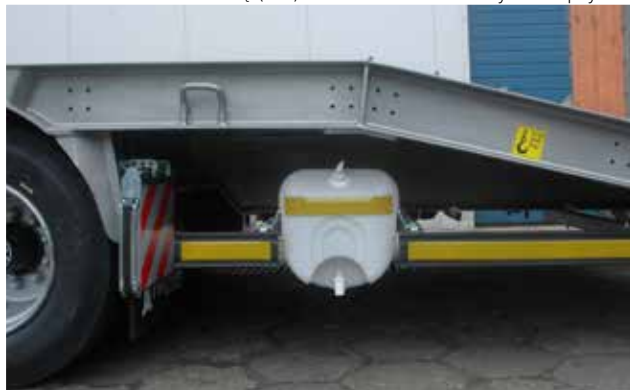
PC2300 - Zbiornik na wodę (30l) z dozownikiem na mydło w płynie – 45 mm
