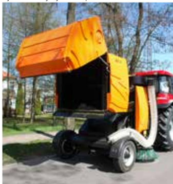
Hydrauliczny system opróżniania kosza
