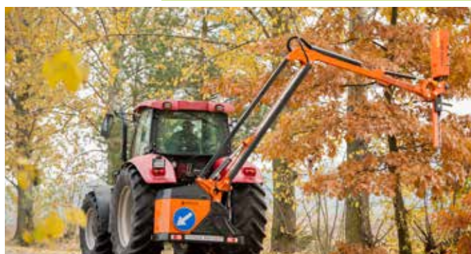
WWP600P - belka samopoziomująca zachowuje kąt głowicy względem podłoża
