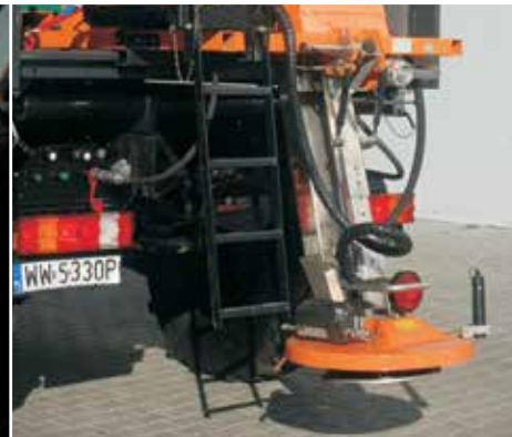
Regulowana wysokość adaptera rozsiewającego.
