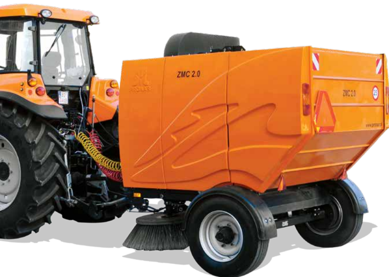
Specjalna szczotka do usuwania roślin przy krawędzi jezdni
