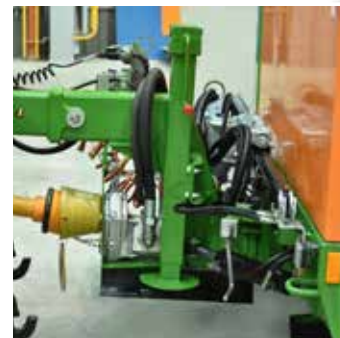
Dyszel przystosowany do agregowania z górnym zaczepem transportowym
