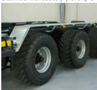
Błotniki aluminiowe z blachy ryflowanej
