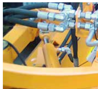
Hydrauliczny skręt szczotki \pm 30^\circ
