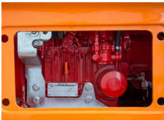
Spalinowy silnik o mocy 16,2kW - SPT70)
