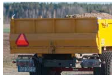
Kłapa tylna rozwierno - wahliva. Tylne lampy oświetleniowe z kratkami zabezpieczającymi przed uszkodzeniem
