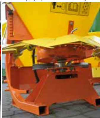
Talerz rozsypujący ze stali nierdzewnej
