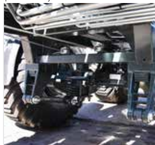
Zawieszenie tandem na resorach parabolicznych
