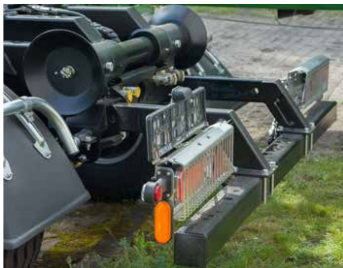
Zderzak tylny wysuwany ze światłami - T185/1
