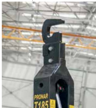
Hak z zabezpieczeniem kontenera
