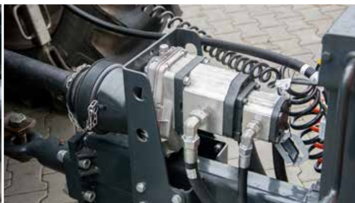
Hydraulika -hydraulika z dwiema pompami hydraulicznymi i chłodnicą oleju
