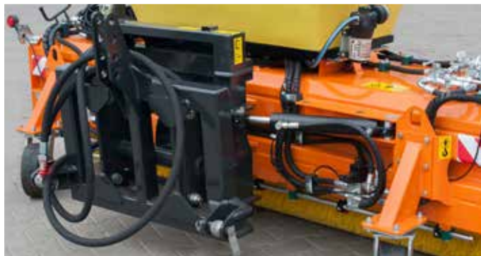
Uniwersalna ramka mocowania pozwala na agregację z szerokim spektrum nośników, od ciągników, aż po wózki widłowe (na zdjęciu TUZ)
