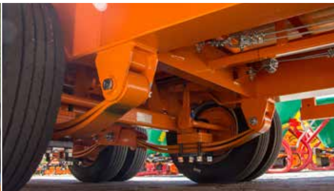
Zawieszenie tandem na 4 resorach parabolicznych
