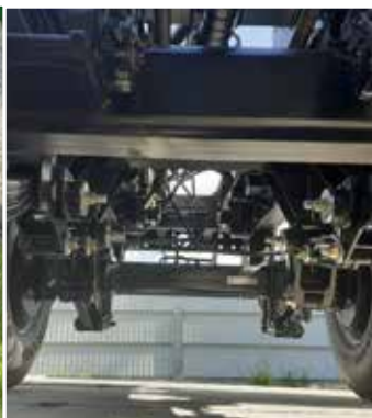
Zawieszenie typu tandem na 4 resorach parabolicznych
