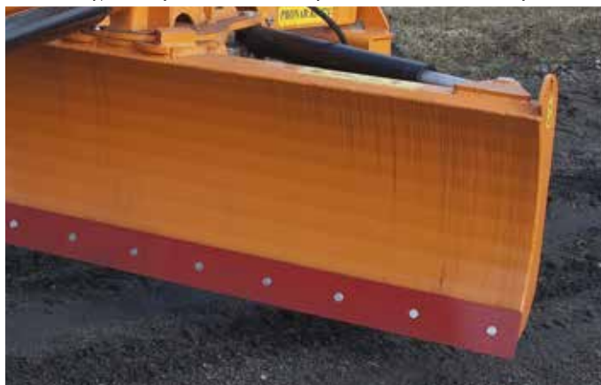
Odkładnica wyposażona jest w stalowe ostrze wykonane ze stali trudnościieralnej
