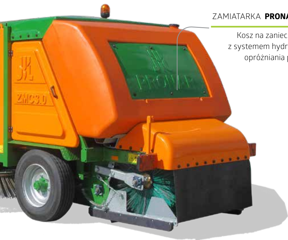
Podajnik zgrzeblowy transportujący zanieczyszczenia do kosza
