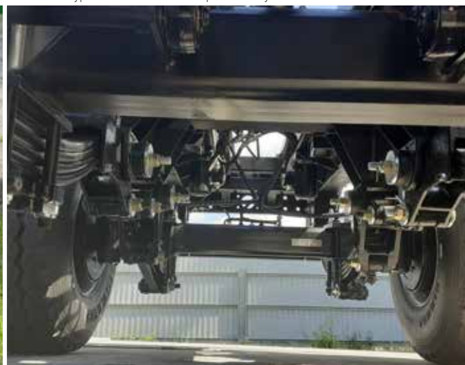
Zawieszenie typu tandem na 4 resorach parabolicznych - T185/1
