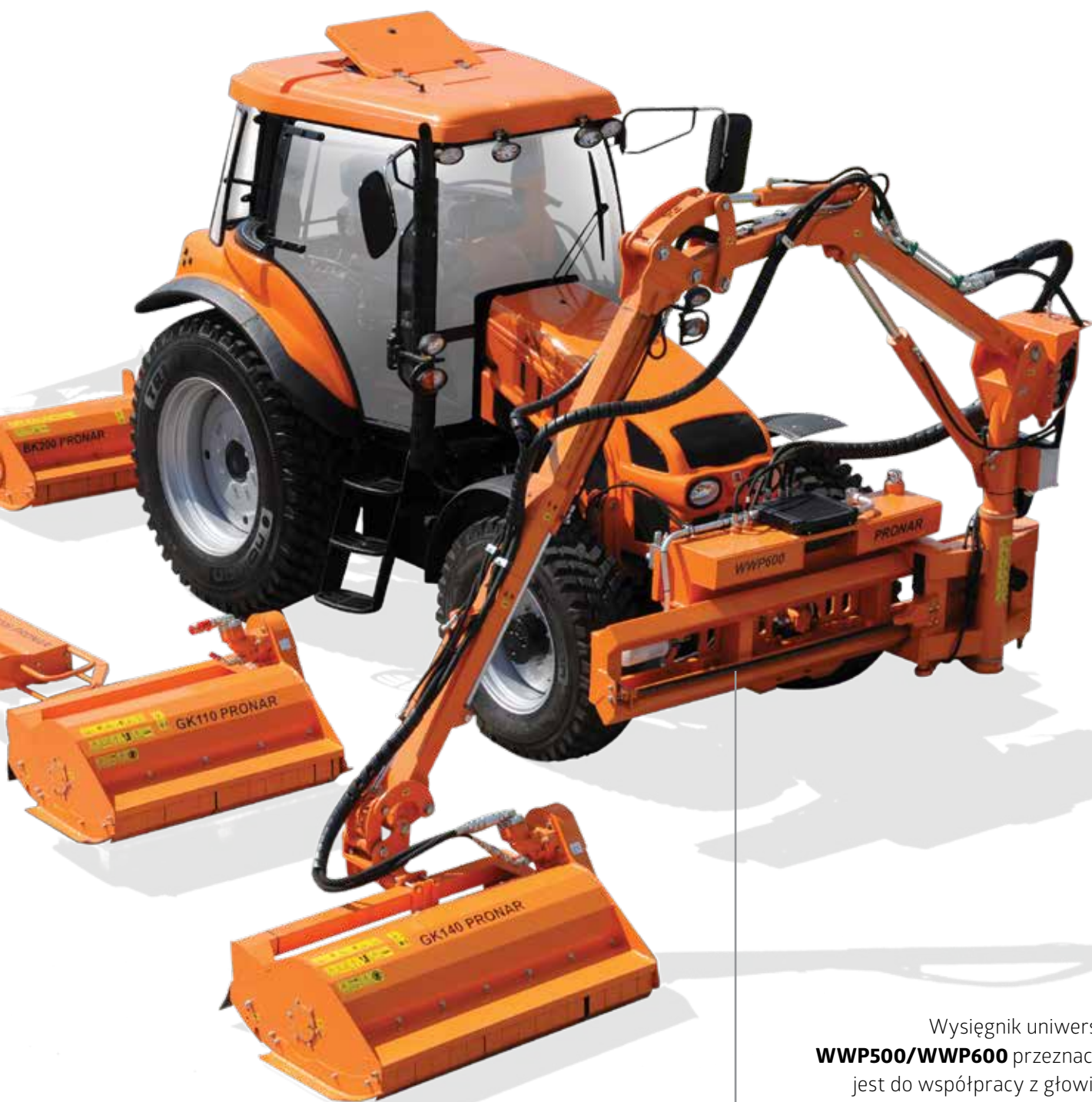
Wysięgnik WWP600 - przesuw hydrauliczny ramienia roboczego po prowadnicy
