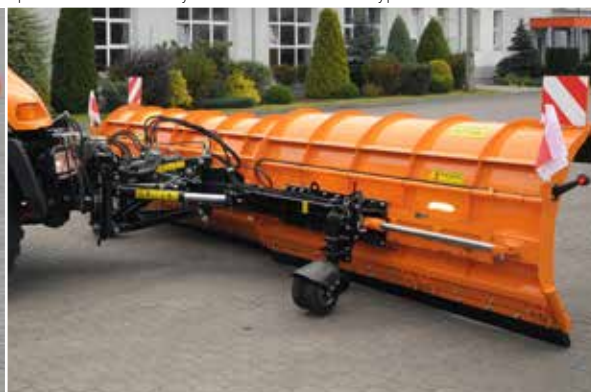
Sposób mocowania – Płyta komunalna DIN76060 typ A
