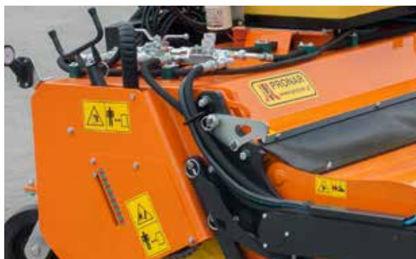
Podnośnik śrubowy szczotki walcowej umożliwia łatwe opuszczanie szczotki w miarę zużycia
