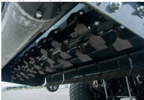
Zespół tnący - wał bijakowy z wymiennymi nożami
