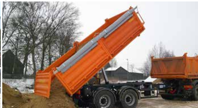
PC2100- rozładunek przyczepy. Burta tylna uchylana automatycznie w momencie wywrotu.
