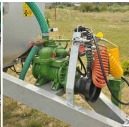
Łopatkowa rotacyjna pompa próżniowa
