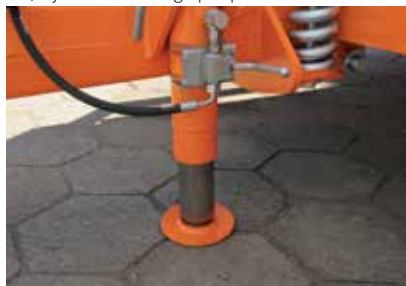
Amortyzowany mechanicznie dyszel i (opcjonalnie) hydrauliczna noga podporowa
