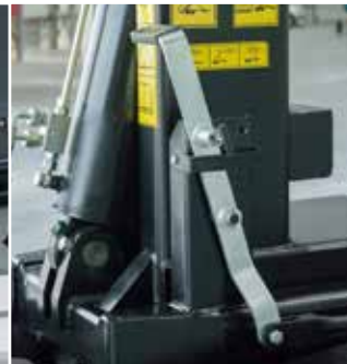
Manualne przełączenie funkcji hakowiec-wywrotka
