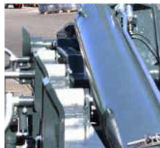
Rama podwozia o wysokiej wytrzymałości z rolkami podpierającymi kontener
