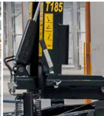
Manualne przełączenie funkcji hakowiec-wywrotka
