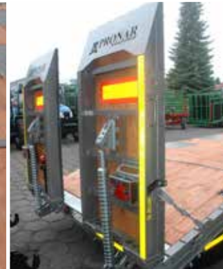
Mechaniczny system opuszczania /podnoszenia najazdów
