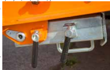
Nogi podporowe mechaniczne, teleskopowe w tylnej części przyczepy
