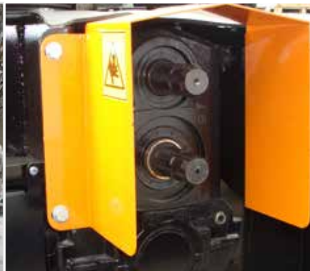
Przekładnia z dwoma końcówkami WOM (540/1000 obr/min)
