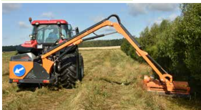
Wysięgniki WWT600 służą do pracy z ciężkimi głowicami w trudnodostępnych miejscach
