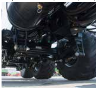
Zawieszenie tridem na resorach parabolicznych, z wahaczami wyrównawczymi
