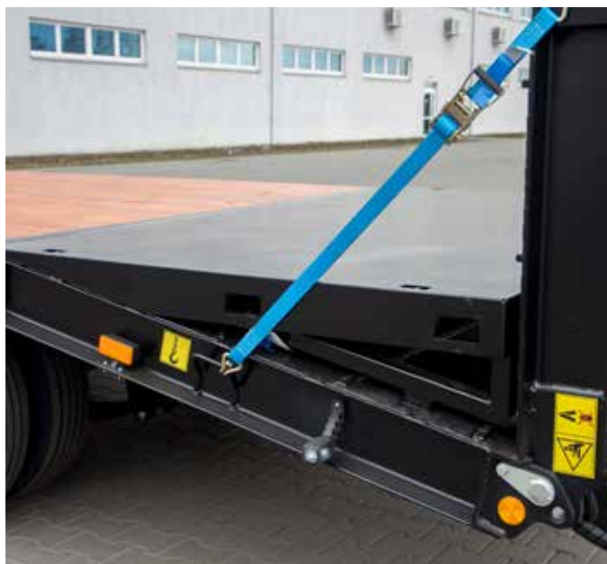
Wkładka przedłużająca płaską część podłogi przyczepy RC2100/2
