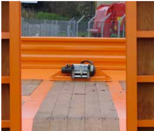
PB3100 - Wyciągarka hydrauliczna: uciąg 6500 kg (lub opcjonalnie: 8000 kg)
