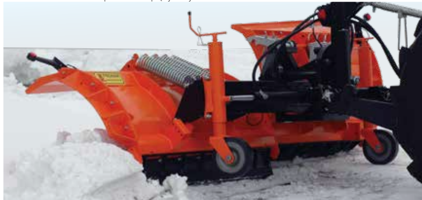
Łamana odkładnica z zabezpieczeniem sprężynowym
