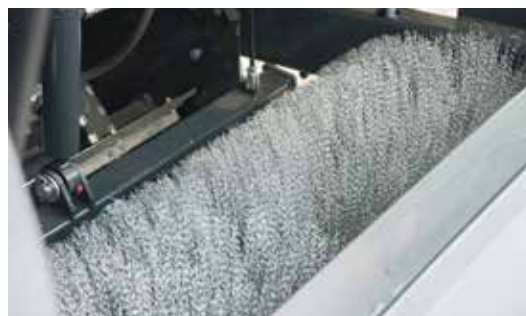
Szczotka walcowa -wykonana z wymiennych segmentów talerzowych
