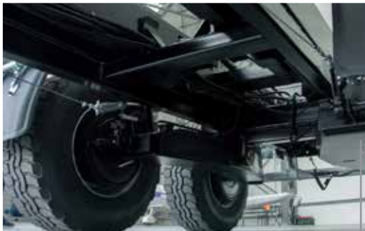
Zawieszenie tandem sztywne typu boogie
