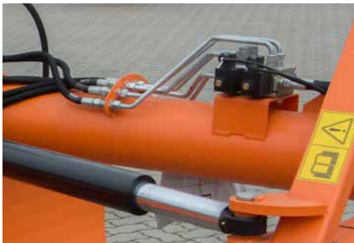
Cylinder hydrauliczny skreću zawieszenia TUZ
