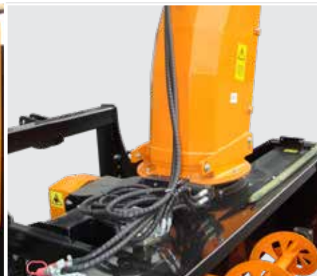
Hydrauliczny obrót komina i regulacja odległości wyrzutu
