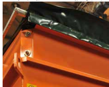
Regulowana wysokość adaptera rozsiewającego.
