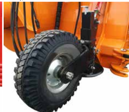
Ślizgi i kółka podporowe do utrzymania dystansu między powierzchnią, a lemiem (do ograniczenia grubości odgarnianej warstwy)
