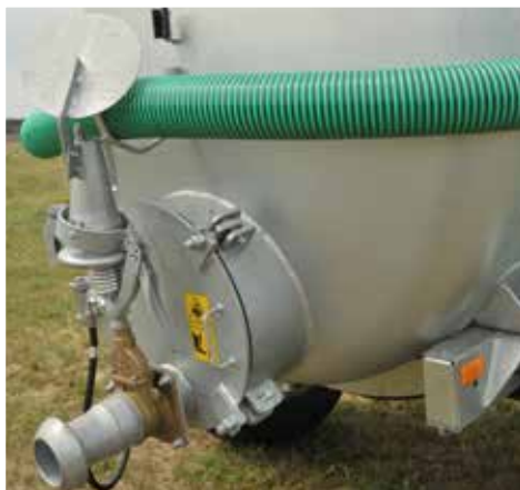
Króciec spustowy w najniższym punkcie zbiornika
