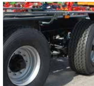
Zawieszenie z tylną osią skrętną kierowaną biernie
