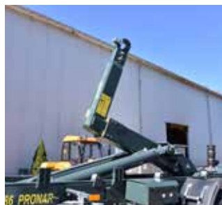
Podnoszenie realizowane dwoma siłownikami hydraulicznymi
