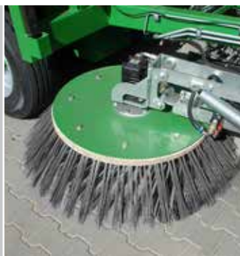
Hydrauliczna regulacja położenia szczotek talerzowych
