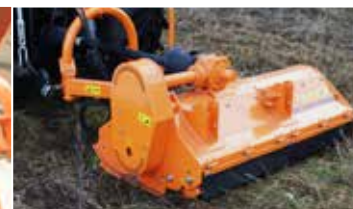
Przekładnia kątowa oraz przekładnia pasowa - zabezpieczenie przeciążeniowe kosiarek z serii BK
