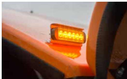
Światła ostrzegawcze -montowane na górnej osłonie
