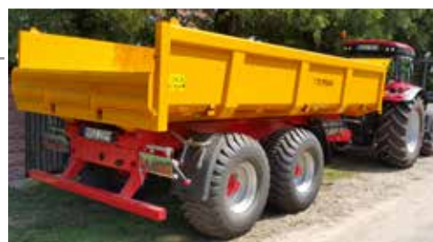
Hydrauliczna kłapa tylna uchylana do dołu.
