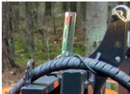
Wskaźnik pozycji pracy ułatwia ustawienie optymalnej wysokości układu zawieszenia nośnika
