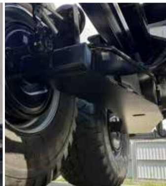
Zawieszenie tandem sztywne typu bogie
