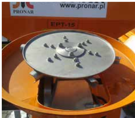
Tarcza rozsiewająca ze stali nierdzewnej.
