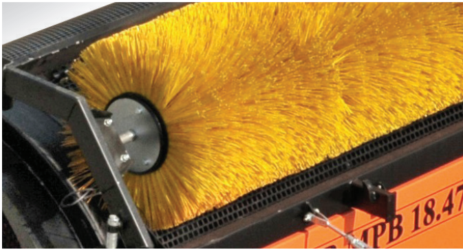
Szczotka czyszcząca bęben opuszczana i podnoszona hydraulicznie.
