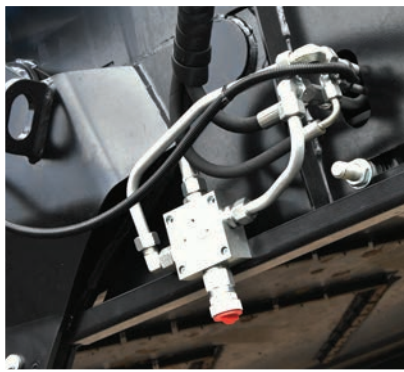
Regulacja prędkości przesuwu taśmy podajnika
