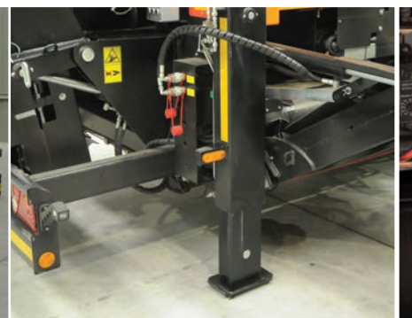
Hydrauliczne stopy podporowe zwiększają komfort pracy operatora oraz zapewniają większą stabilność przesiewacza podczas pracy.
