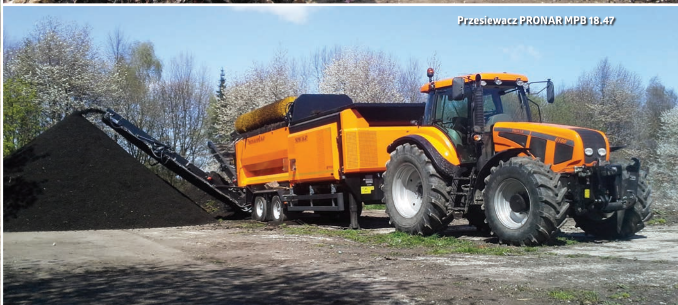
Przesiewacz PRONAR MPB 18.47 podczas przesiewania odpadów po biologicznej stabilizacji.
