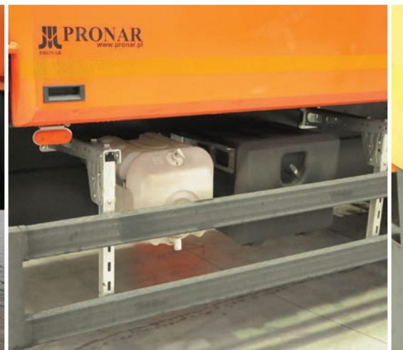
Zbiornik na wodę i mydło w płynie jako opcjonalne wyposażenie maszyny.
