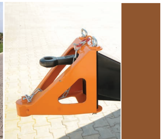
Przegub kulowy pozwala na przestawienie przesiewacza przy użyciu sprzętu budowlanego.
