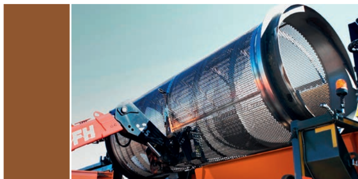
Szybka i łatwa wymiana bębna przesiewającego.
