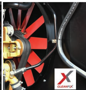
System Cleanfix automatycznie oczyszcza chłodnice
