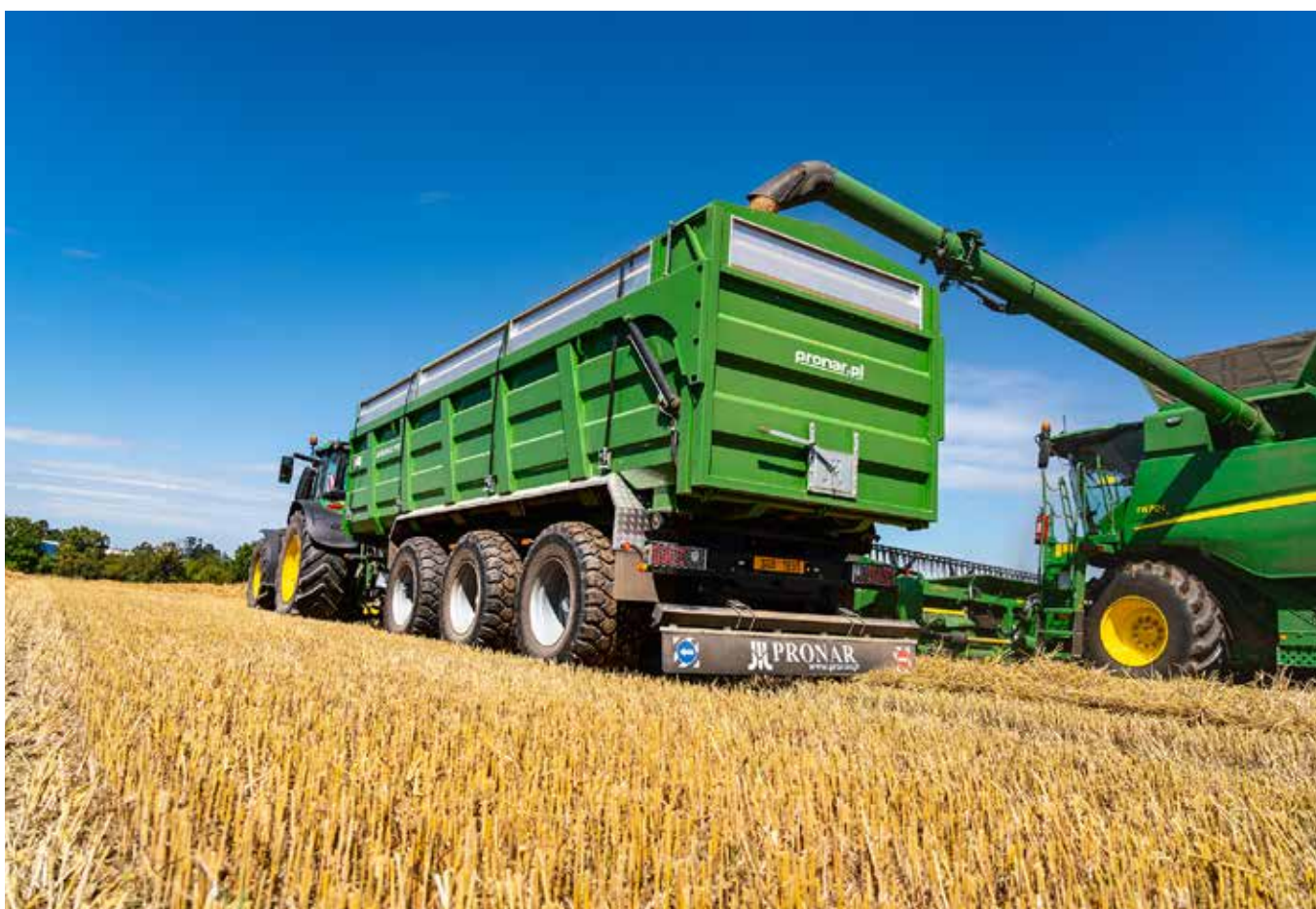
▲ Podwozie tridem zapewnia stabilność i komfortowe właściwości jezdne podczas transportu większych ciężarów.
