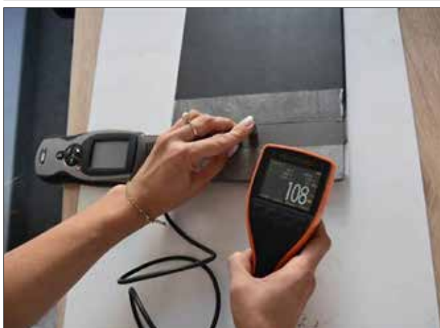
◀ Badanie grubości powłok
