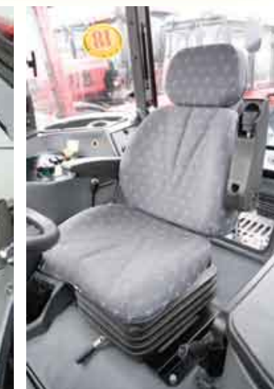
Kompletne siedzisko kierowcy wyposażone w wygodne podłokietniki z regulacją w pełnym zakresie położenia
