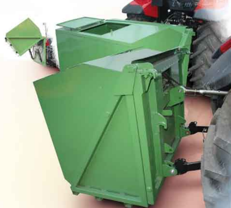
Kontener samowyladowczy o ładowności 1000 kg i pojemności 1,5 m³, mocowany na tylnym lub przednim trójpunktowym układzie zawieszenia ciągnika lub na ładowaczu czołowym
