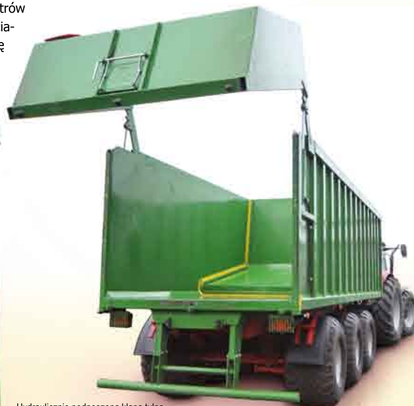
Hydraulicznie podnoszona kłapa tylna z oknem zsympowym do ziarna
