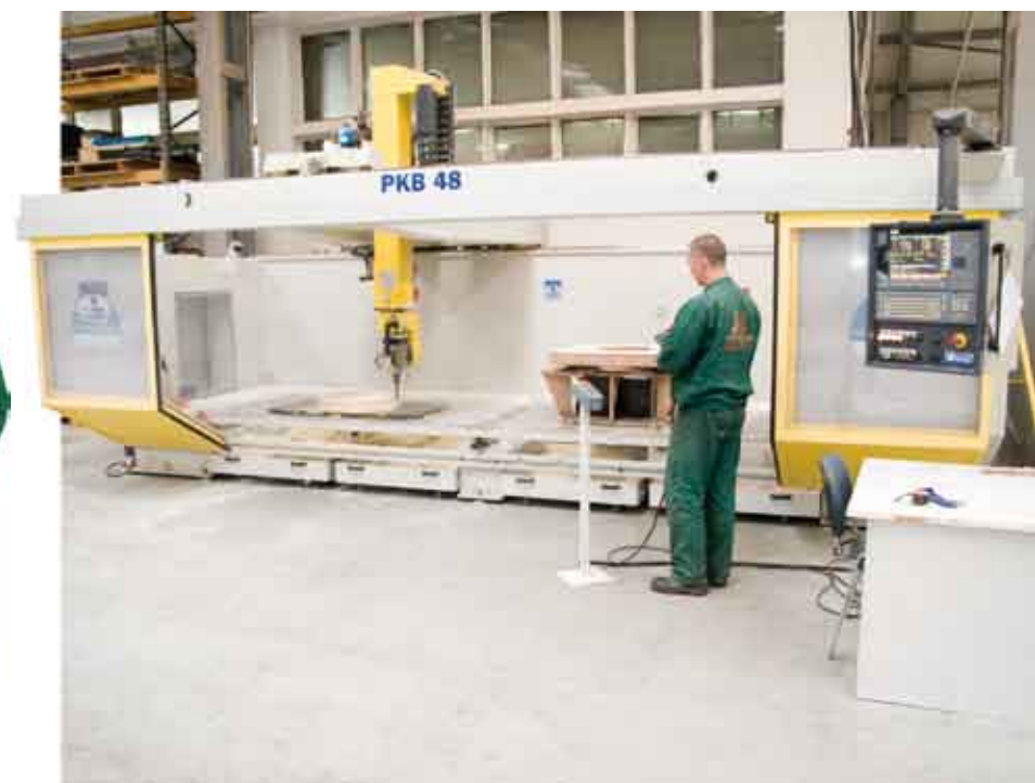
Frezarka CNC podczas przygotowania do rozpoczęcia frezowania
