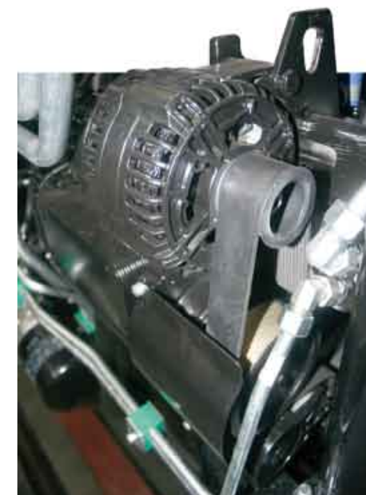
Alternator powinien ładować baterię prądem o napięciu 14-14,4 V
