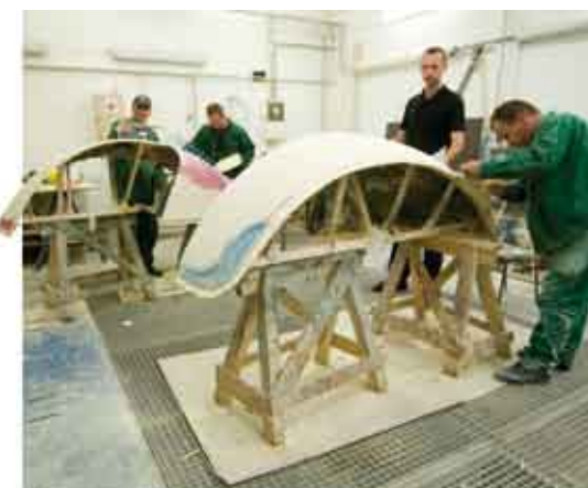
Przygotowanie modeli błotników tylnych ciągników PRONAR P6 i P9 do wykonania form produkcyjnych
