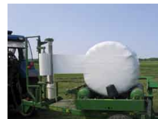
Owijarka samozaładowcza Z245, tak jak i jej mniejsza siostra Z235, radzi sobie doskonale z belami o średnicy 1,2 m oraz 1,5 m
