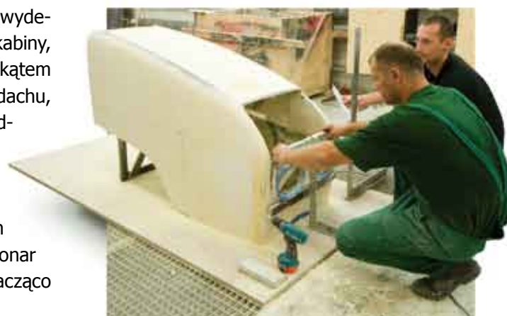
Modelowanie maski ciągnika PRONAR P5 III
