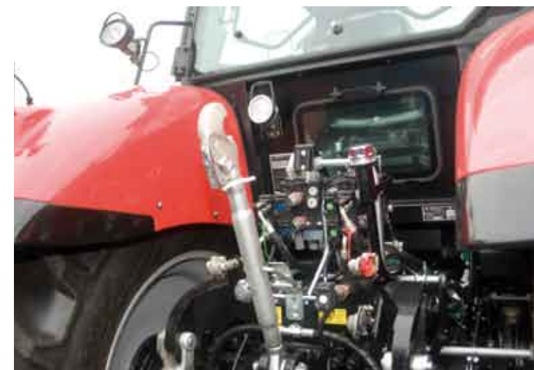
Wlew oleju przekładniowego w ciągnikach PRONAR 8140, produkowanych w oparciu o układy napędowe marki ZF, znajduje się w tylnej części ciągnika
