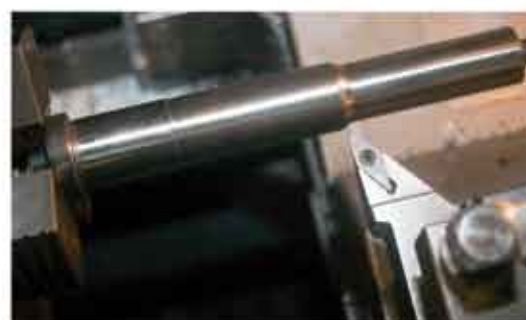
Toczenie stali proszkowej o twardości 64 HRC płytka z ostrzem borazonowym
