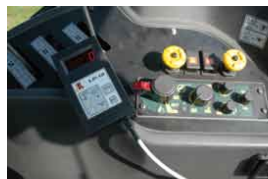
Pulpit sterowniczy prasy, umieszczony w kabinie ciągnika, ułatwia pracę operatora
