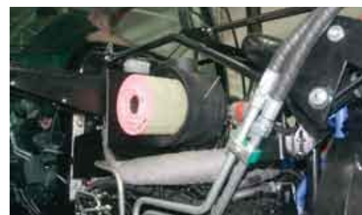
Filtr powietrza należy wymienić (ewentualnie wyczyścić) zgodnie z zaleceniami producenta
