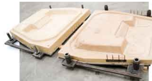
Obie połówki formy podsufitki przygotowane do produkcji detali na prasie formierskiej
