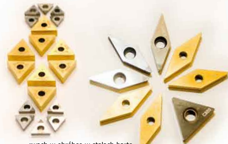
Różne typy płytek jednoostrzowych i wielonostrzowych z ostrzami CBN
