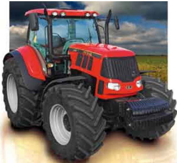
Do konstrukcji ciągników największej mocy użyto najnowocześniejszych części światowych potentatów w branży - silnik Deutz'a, osie ZF i Dany, układ elektrohydrauliczny Boscha
