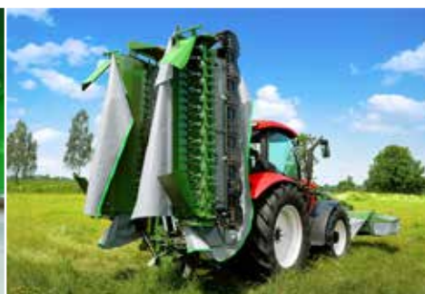
▲ Zestaw roboczy złożony z tylnej dwustronnej kosiarki PDD830C i przedniej PDF301
