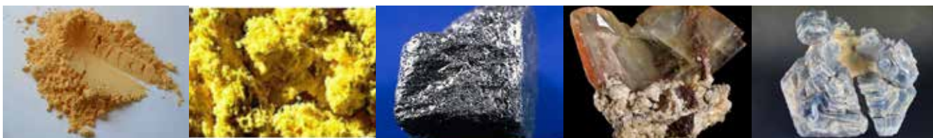
▲ Podstawowe surowce do produkcji materiałów ciernych (od lewej): syntetyczna żywica fenolowo-formaldehydowa, syntetyczne włókno aramidowe, ruda grafitu, ruda barytu i ruda korundu
