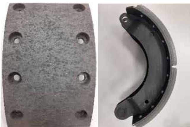
▲ Okładzina z naniesionym materiałem ciernym
