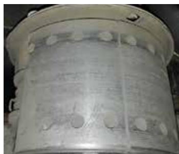
◀ Bęben podlegający oddziaływaniu szczęk hamulcowych
