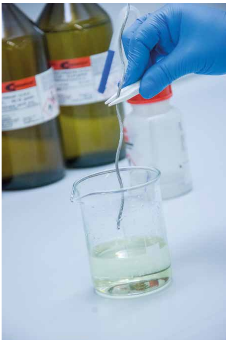
▲ Usuwanie powłoki cynkowej z drutu stalowego metodą chemiczną
