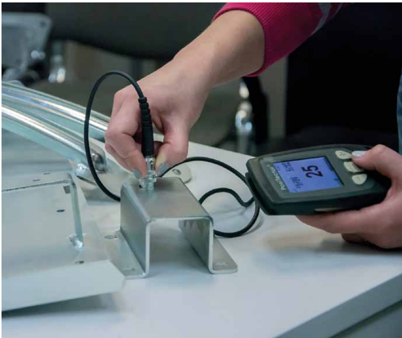
▲ Pomiar grubości powłoki cynkowej
